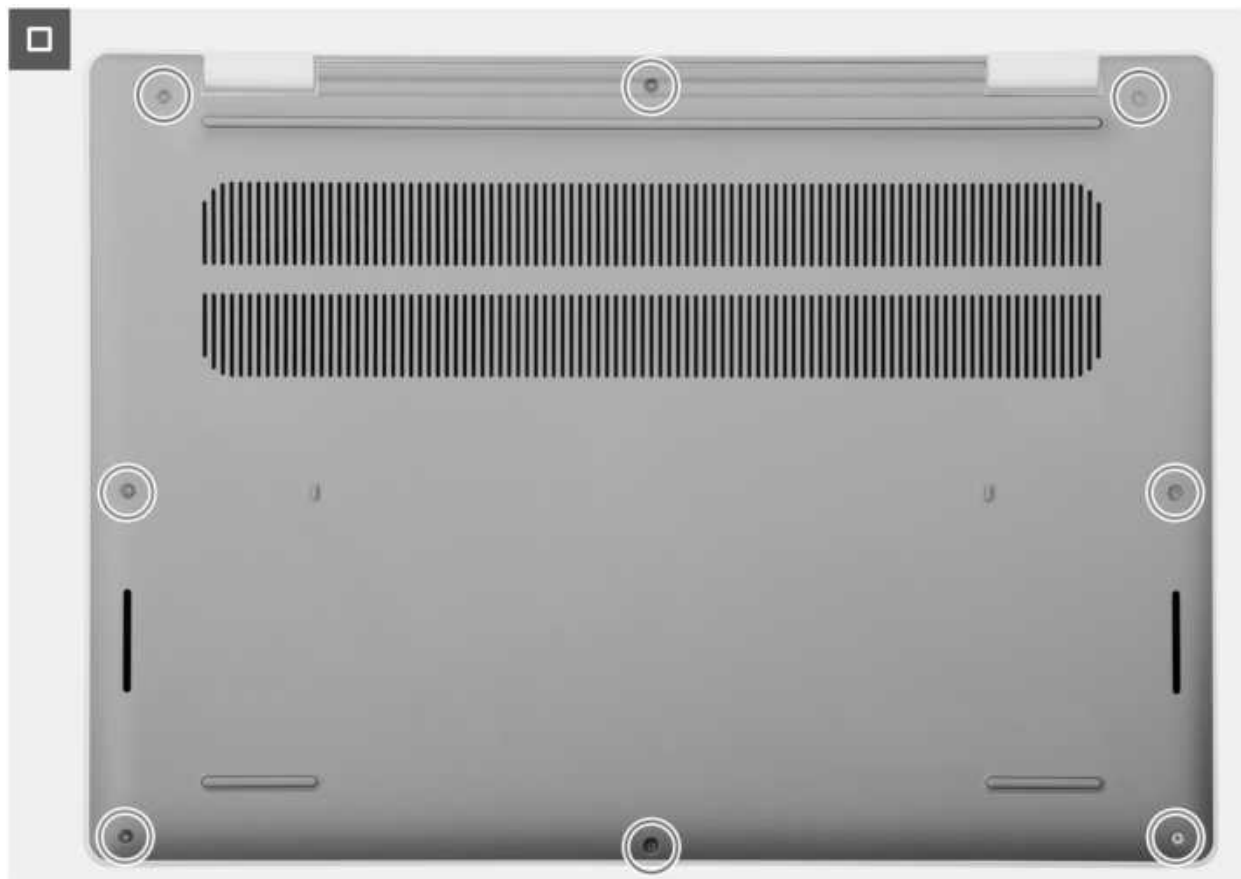
Abbildung 15. Anbringen der Bodenabdeckung
