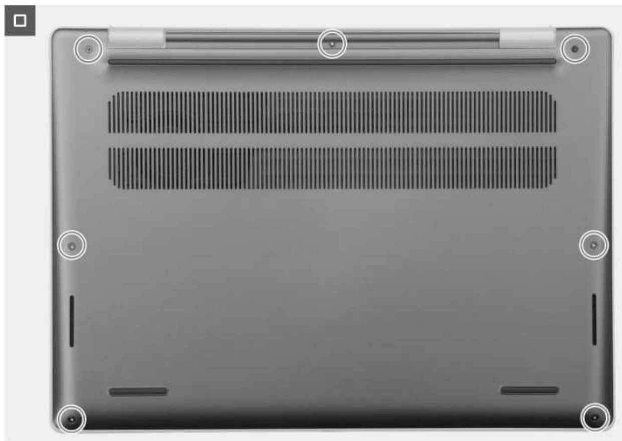
Abbildung 19. Anbringen der Bodenabdeckung
