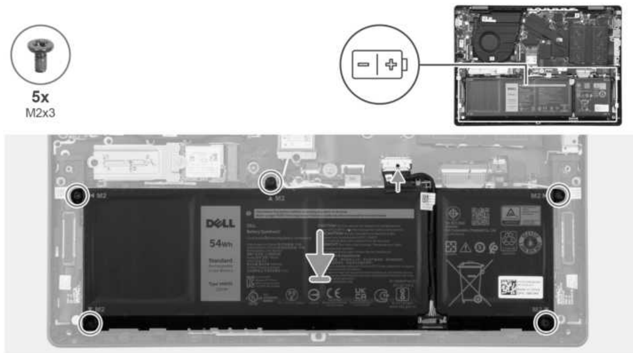
Abbildung 25. Einsetzen des Akkus
