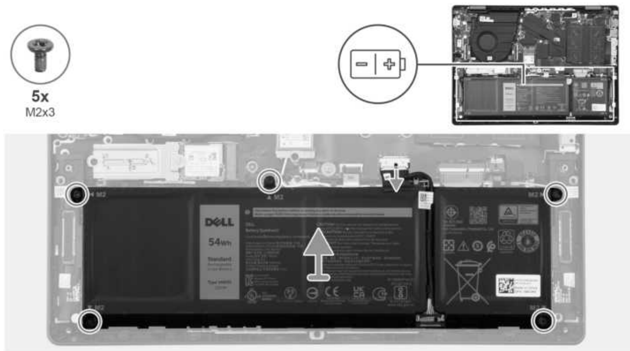
Abbildung 24. Entfernen des Akkus
