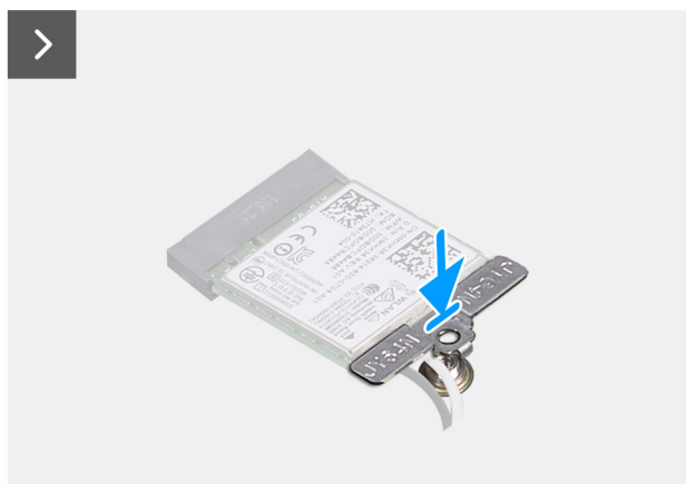
Abbildung 26. Installieren der Wireless-Karte
