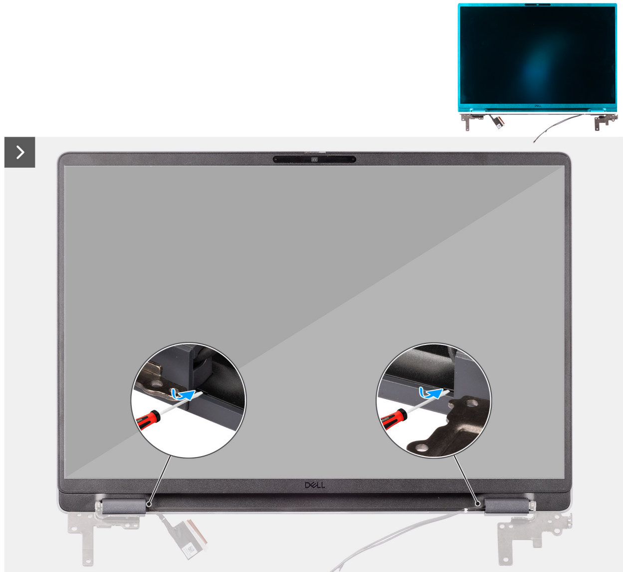
Abbildung 67. Entfernen der Bildschirmblende
