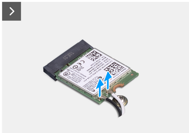
Abbildung 25. Entfernen der Wireless-Karte
