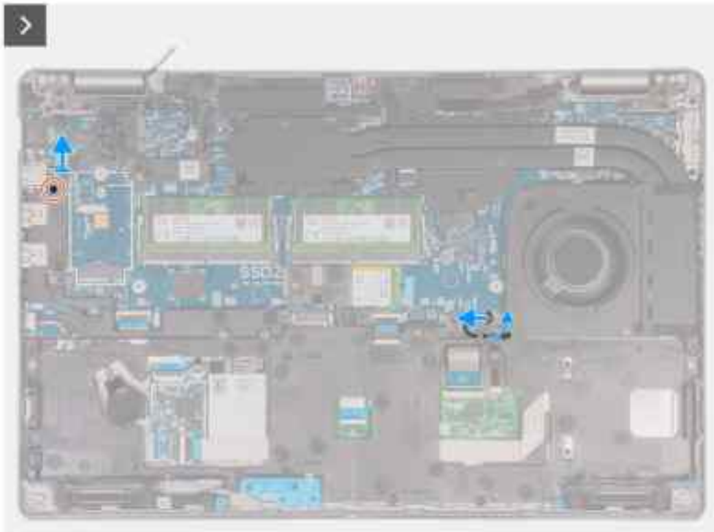
Abbildung 2. Entfernen des inneren Rahmens
