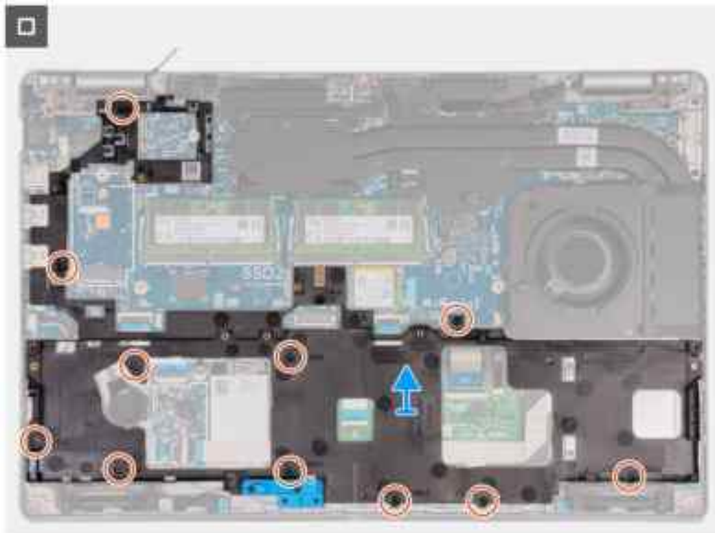
Abbildung 3. Entfernen des inneren Rahmens
