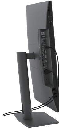
Abbildung 52. Schließen Sie die Kabel in der höchsten, am weitesten gedrehten Position an
