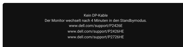
Abbildung 78. Warnmeldung: DP-Kabel nicht angeschlossen
