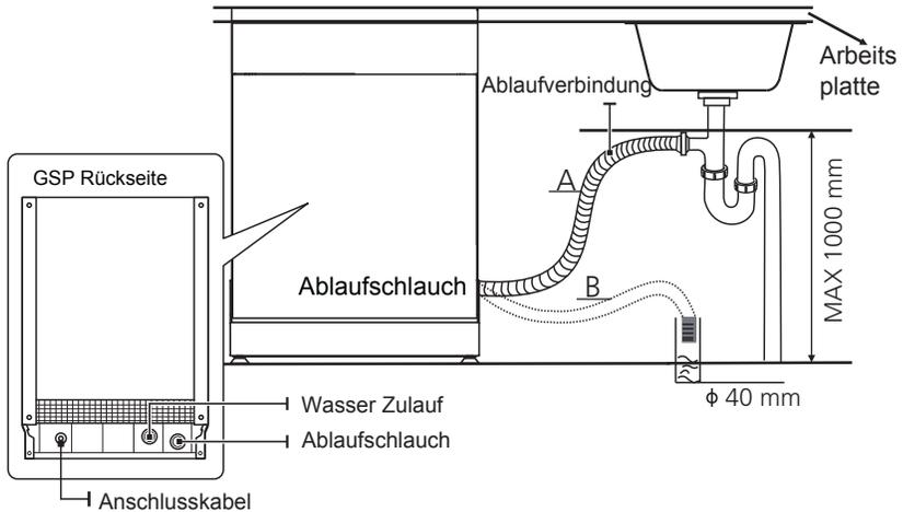
**So lassen Sie überschüssiges Wasser aus Schläuchen ab:** Wenn der Anschluss zum Abflussrohr höher als 1000 mm positioniert ist, kann überschüssiges Wasser im Ablaufschlauch verbleiben. Überschüssiges Wasser aus dem Schlauch muss in eine Schüssel oder einen geeigneten Behälter abgelassen werden, der außerhalb und unterhalb des Waschbeckens steht.
