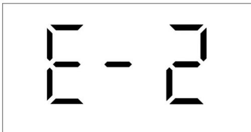
Bild 12: Anzeige des Alarmeffekts bei defektem Heizelement
