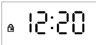
**Bild 10: Anzeige bei aufgehobener Türverriegelung**
