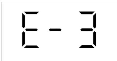
Bild 13: Anzeige des Alarmeffekts bei anormaler Türverriegelung
