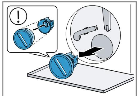
Der Pumpendeckel besteht aus zwei Bauteilen die zur Reinigung auseinandergelassen werden können.
