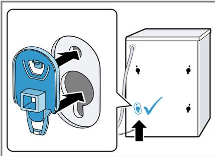
**Hinweis:** Um die Transportsicherungen für den Transport in das Gerät einzusetzen, machen Sie diese Schritte rückgängig in umgekehrter Reihenfolge.
