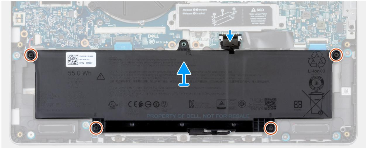
Abbildung 17. Entfernen des Akkus
