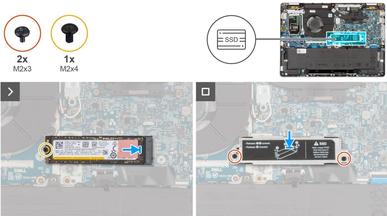
Abbildung 26. Installieren der M.2-2280-SSD
