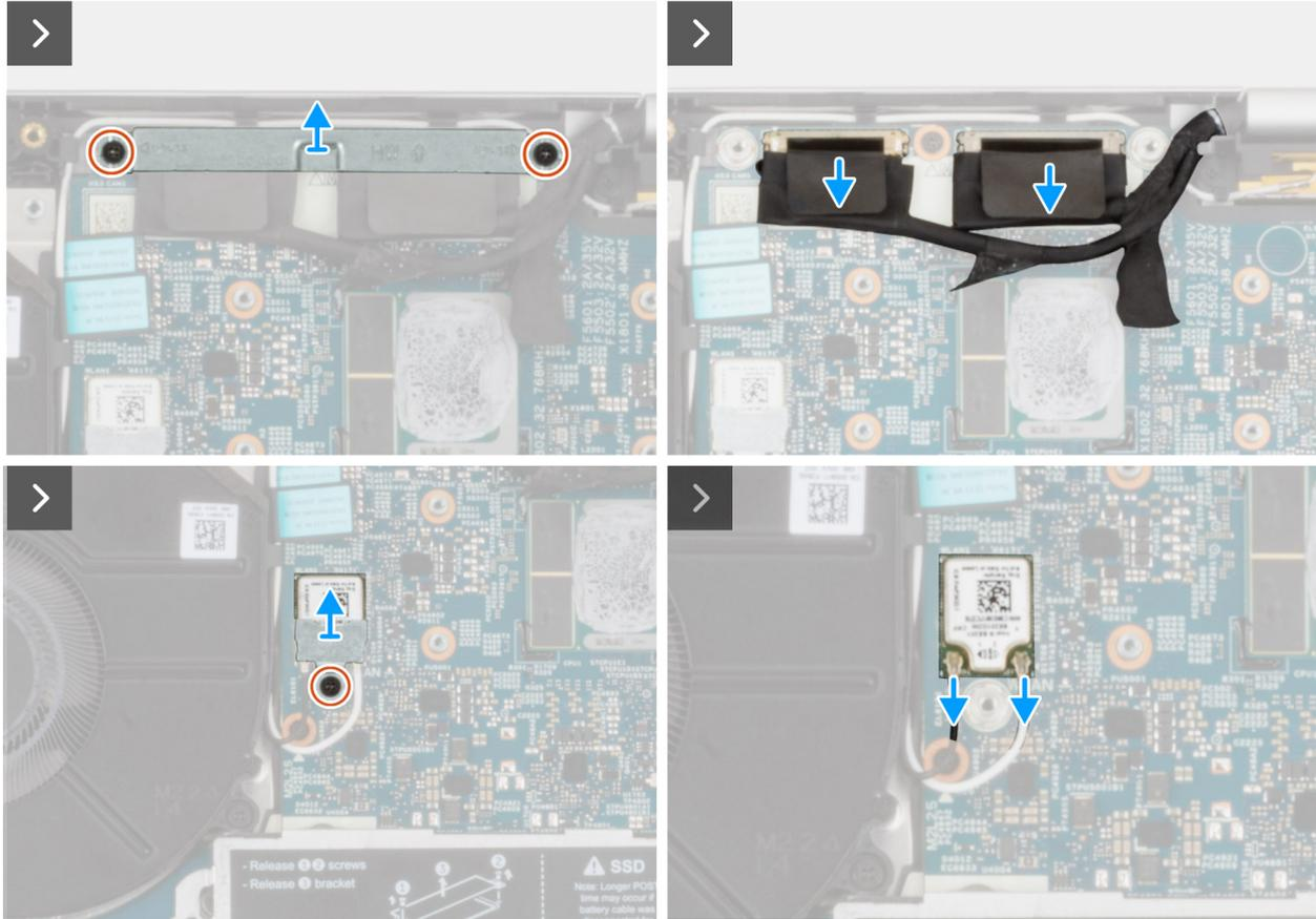
Abbildung 29. Entfernen des WLAN-Antennenmoduls
