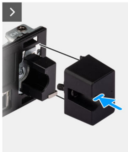
Abbildung 74. Einbauen des Antennenmoduls (weißes Kabel)
