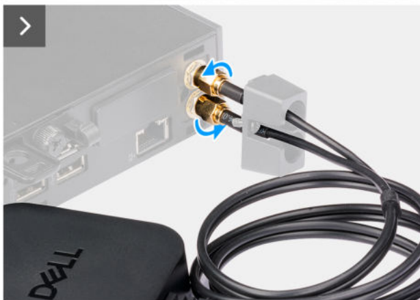
Abbildung 34. Entfernen der externen Puck-Antenne
