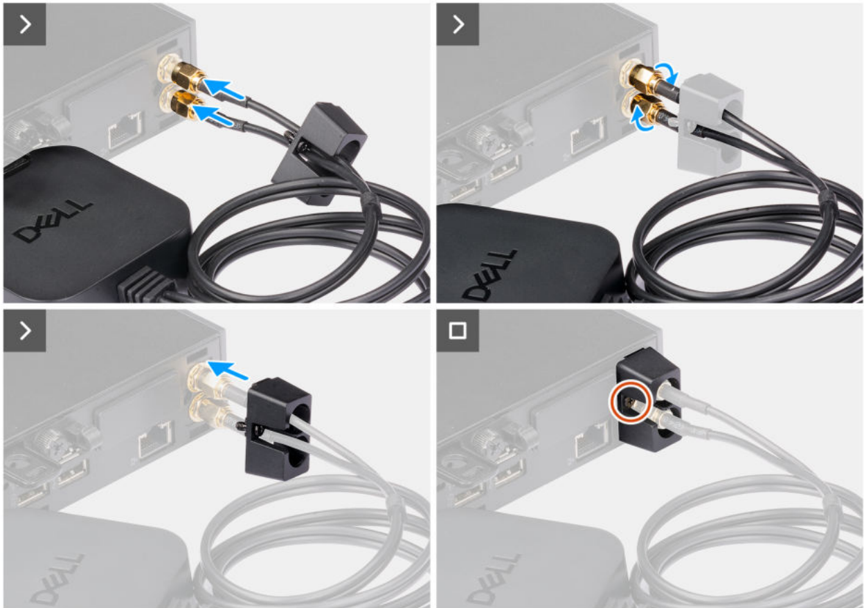
Abbildung 35. Einbauen der externen Puck-Antenne
