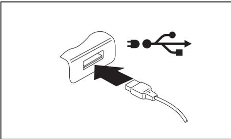
An diesem USB-Anschluss können Sie ein angeschlossenes USB-Gerät auch bei ausgeschaltetem Notebook aufladen oder mit Strom versorgen (z. B. einen PDA oder ein mobiles Telefon aufladen oder eine USB-Lampe anschließen).
