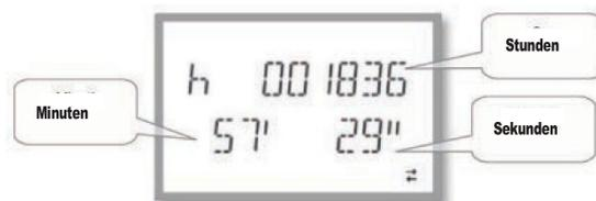
Ein Gesamtstundenzähler und 4 Teilstundenzähler, beide rückstell- und durch verschiedene Quellen aktivierbar, stehen zur Verfügung (Querverweis auf die Parameter der Gruppe P05).
