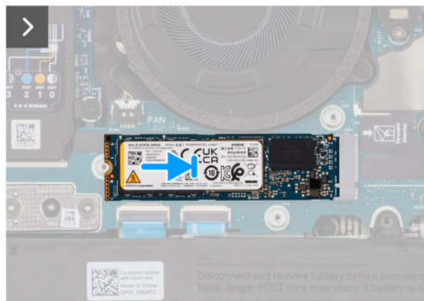
Abbildung 30. Installieren der M.2-2280-SSD
