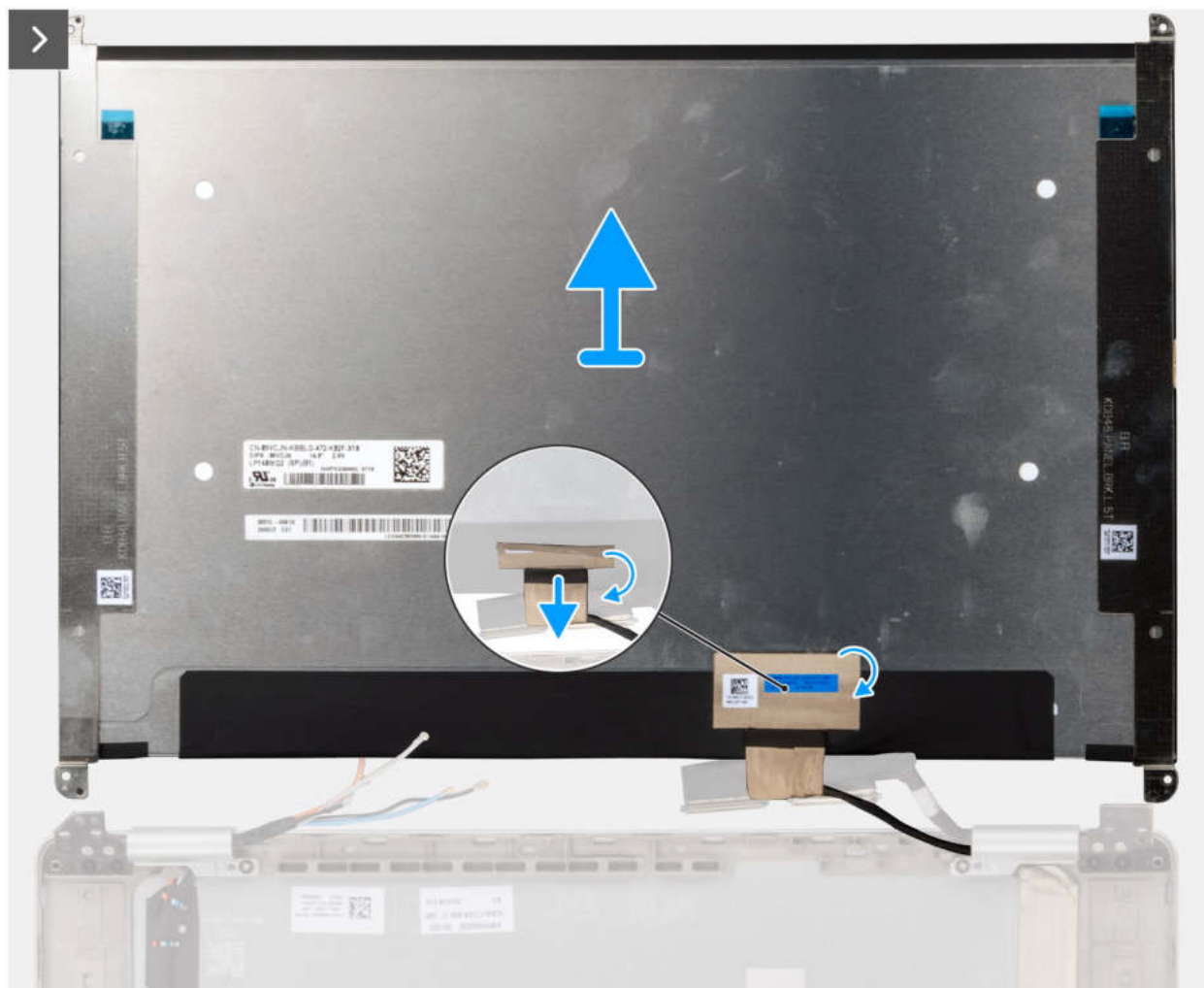
Abbildung 69. Entfernen des Bildschirms
