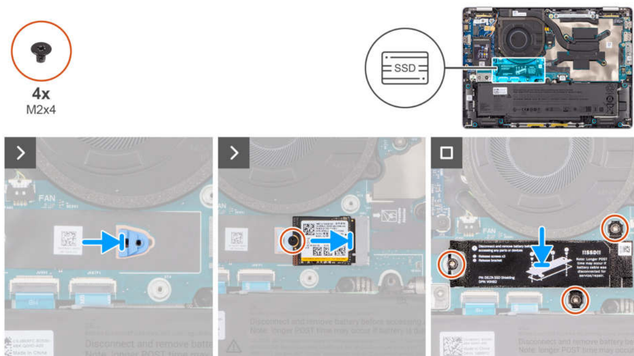
Abbildung 28. Einbauen des M.2-2280-SSD
