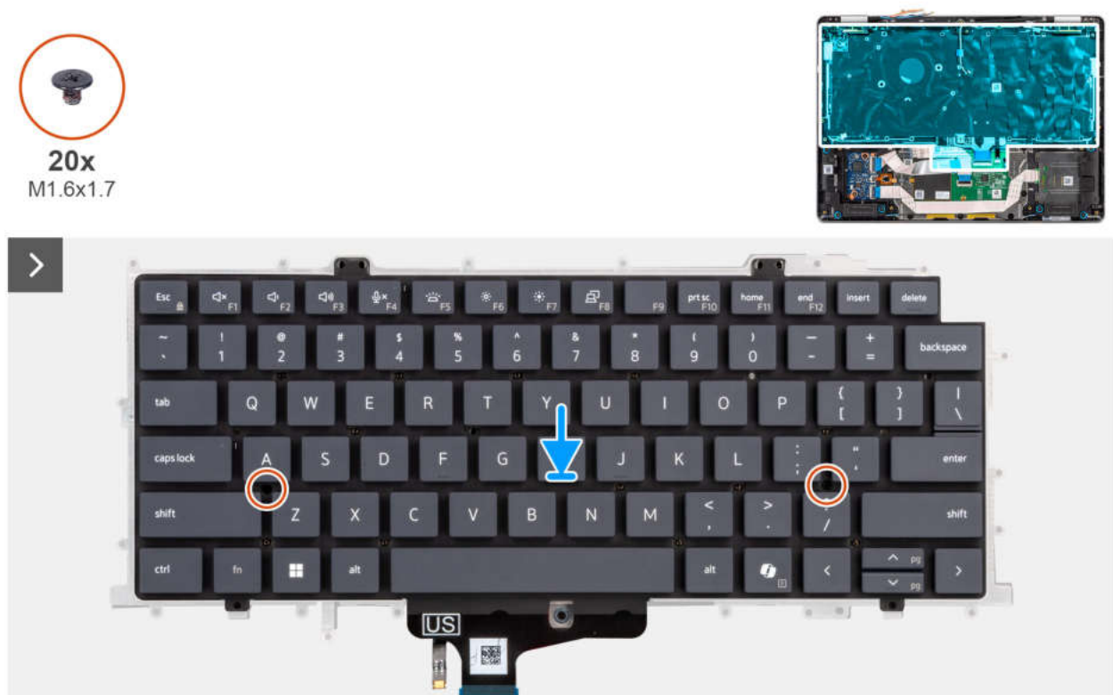
Abbildung 95. Einbauen der Tastatur
