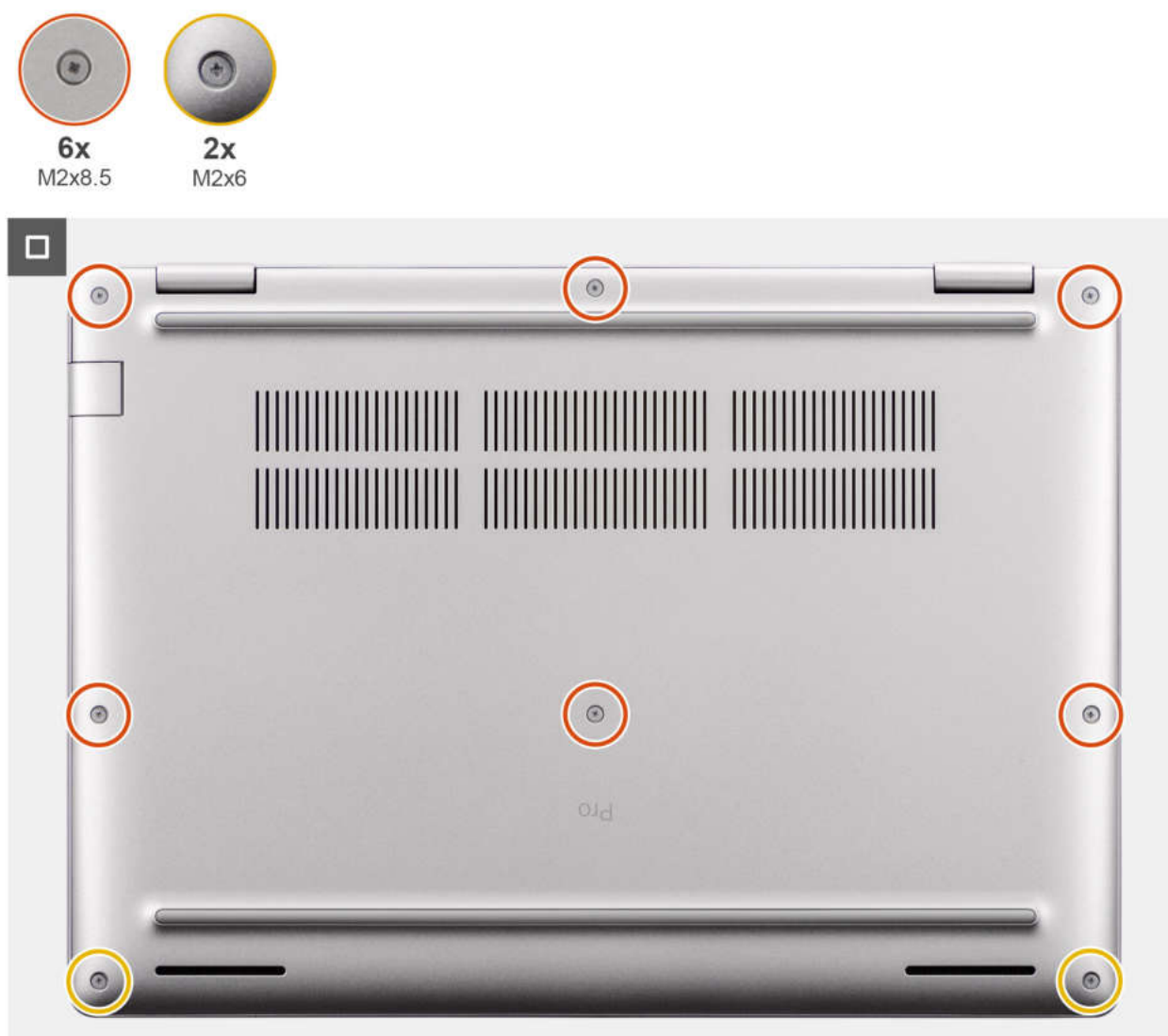
Abbildung 20. Anbringen der Bodenabdeckung
