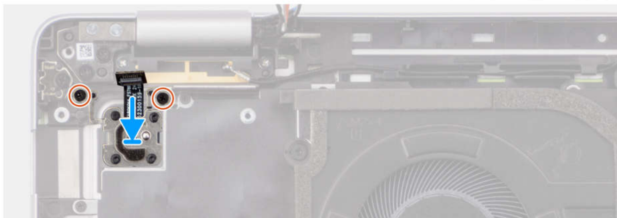
Abbildung 56. Installieren des Netzschalters mit optionalem Fingerabdruck-Lesegerät
