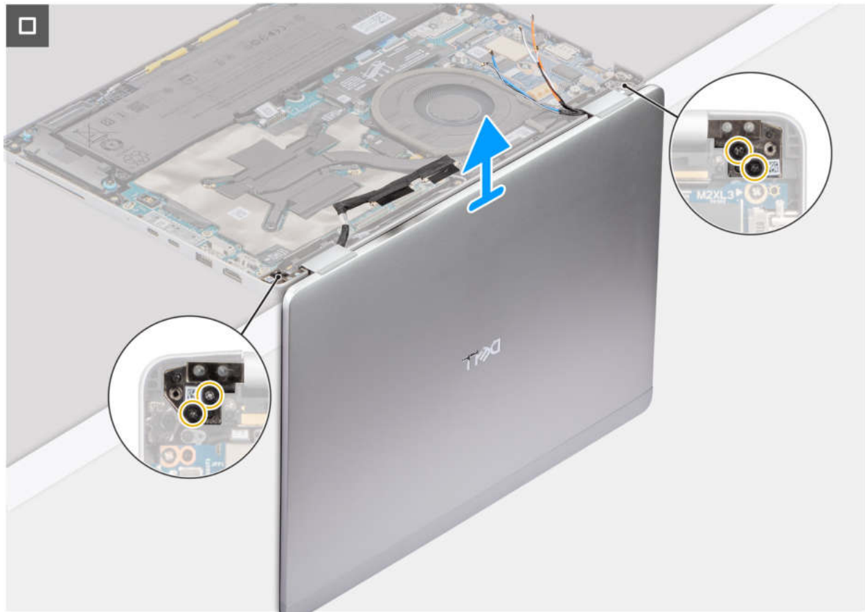
Abbildung 58. Entfernen der Bildschirmbaugruppe
