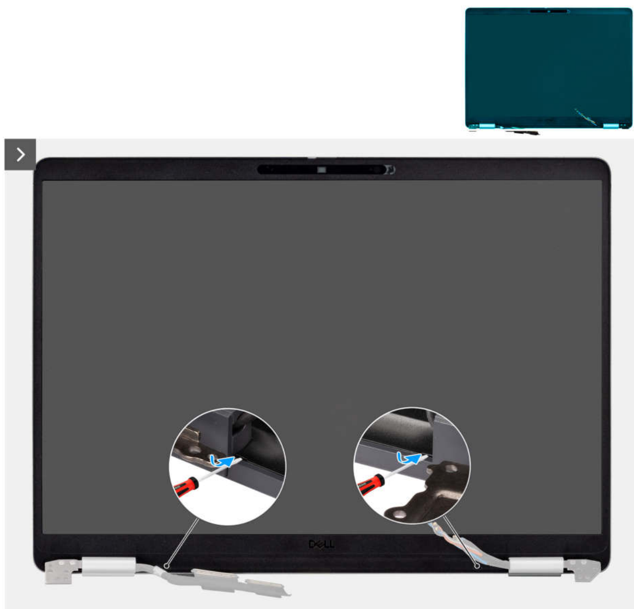
Abbildung 61. Abhebeln der Kunststoffblende
