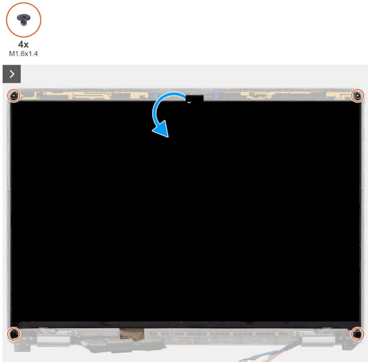
Abbildung 68. Entfernen des Bildschirms
