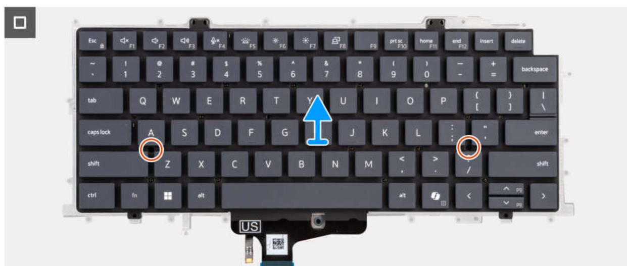
Abbildung 94. Entfernen der Tastatur
