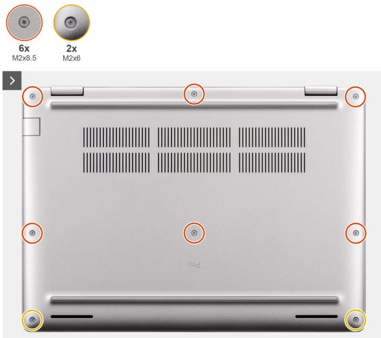
Abbildung 17. Entfernen der Bodenabdeckung
