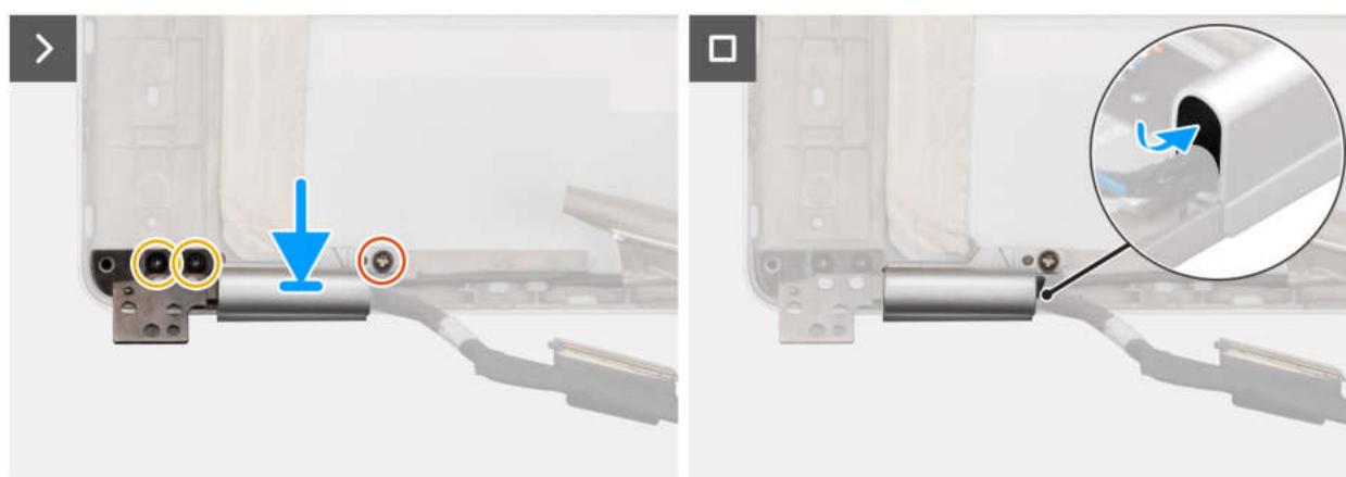
Abbildung 84. Installieren des Bildschirmkabels der RGB/IR-Kamera
