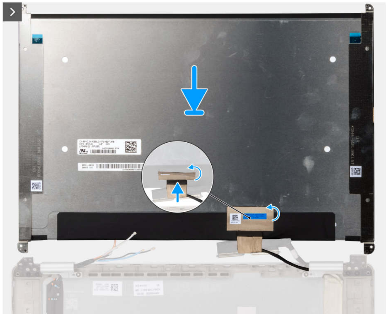
Abbildung 71. Einbauen des Bildschirms
