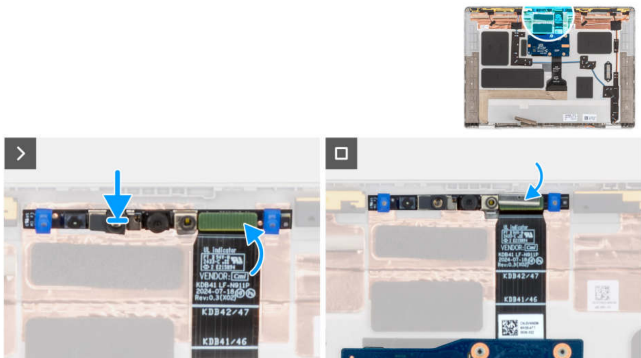
Abbildung 80. Installieren der MIPI-Kamera
