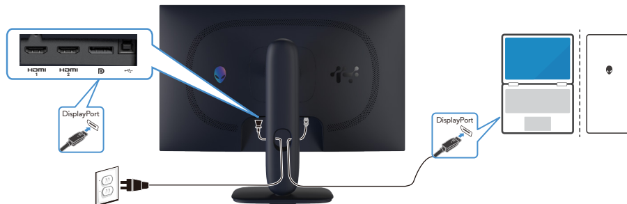
Figure 28. Branchement du câble DisplayPort (DP à DP)
