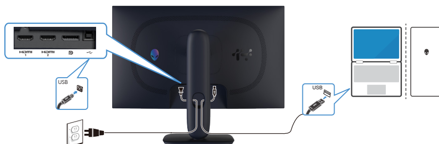
Figure 30. Branchement du câble USB type B (type B à type A)
