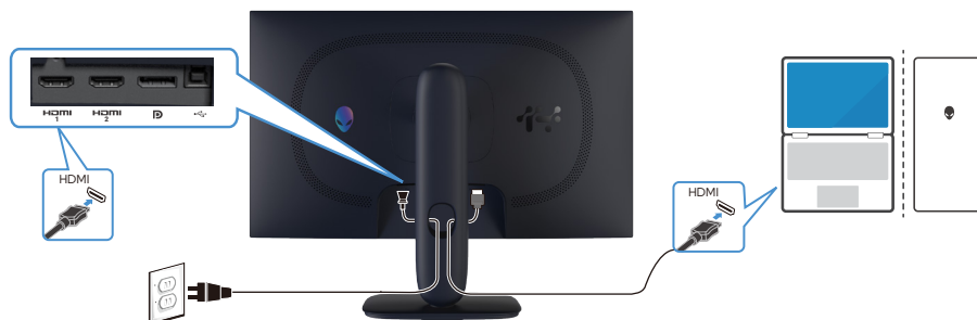
Figure 29. Branchement du câble HDMI
