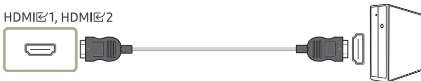
— Es wird empfohlen, das als Bestandteil beiliegende HDMI-Kabel zu verwenden. Wird keins bereitgestellt, vergewissern Sie sich, ein autorisiertes HDMI-Kabel für Verbindungen zu verwenden. Wenn Sie ein nicht autorisiertes HDMI-Kabel verwenden, kann sich die Bildqualität verschlechtern.
