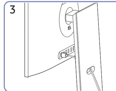
Organisieren Sie Kabel, indem Sie sie, wie in den Abbildungen gezeigt, durch das Loch im Ständer führen.
