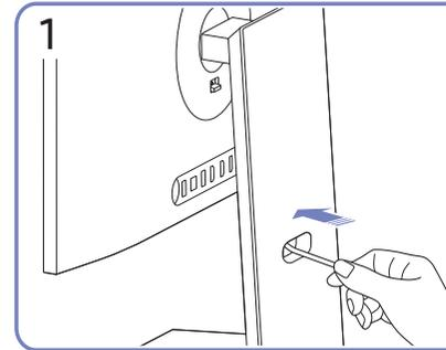
Führen Sie Kabel durch das Loch im Ständer.
