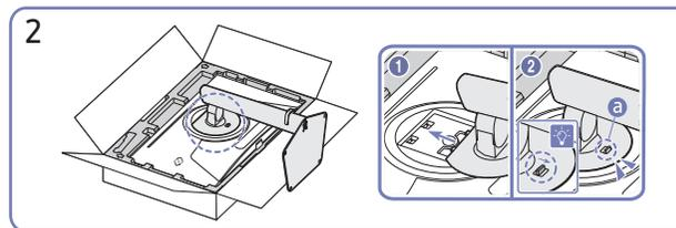
Schieben Sie den montierten Standfuß in Pfeilrichtung (siehe Abbildung) in das Gerätegehäuse hinein. Bestätigen Sie, dass der Ständer fest angebracht ist. Wenn **a** nicht vollständig gesenkt ist, senken Sie ihn, während Sie ihn mit der Hand festhalten.
