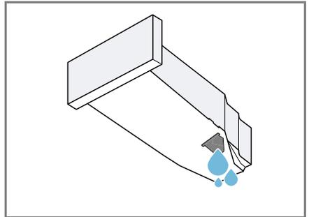
Prüfen Sie regelmäßig den Filter des Kondenswasserbehälters und reinigen Sie einen verunreinigten Filter. → Seite 33
