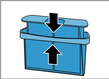
8. Das zweiteilige Flusensieb einsetzen.
