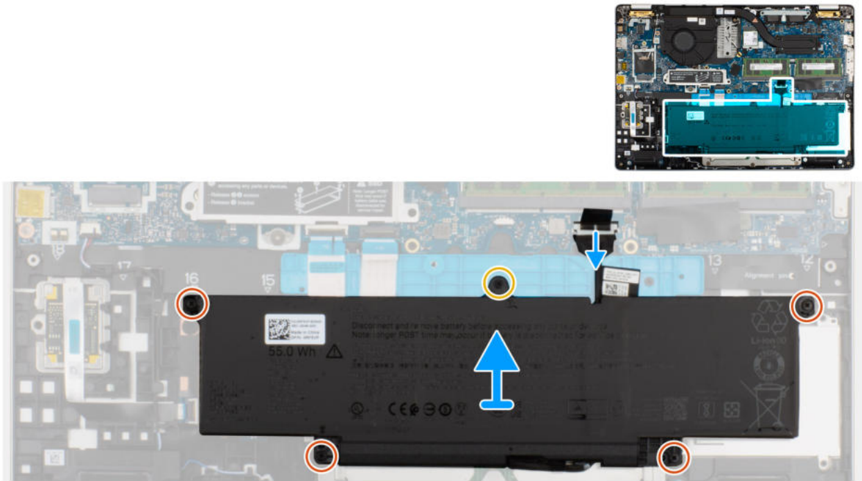
Abbildung 15. Trennen des Akkukabels
