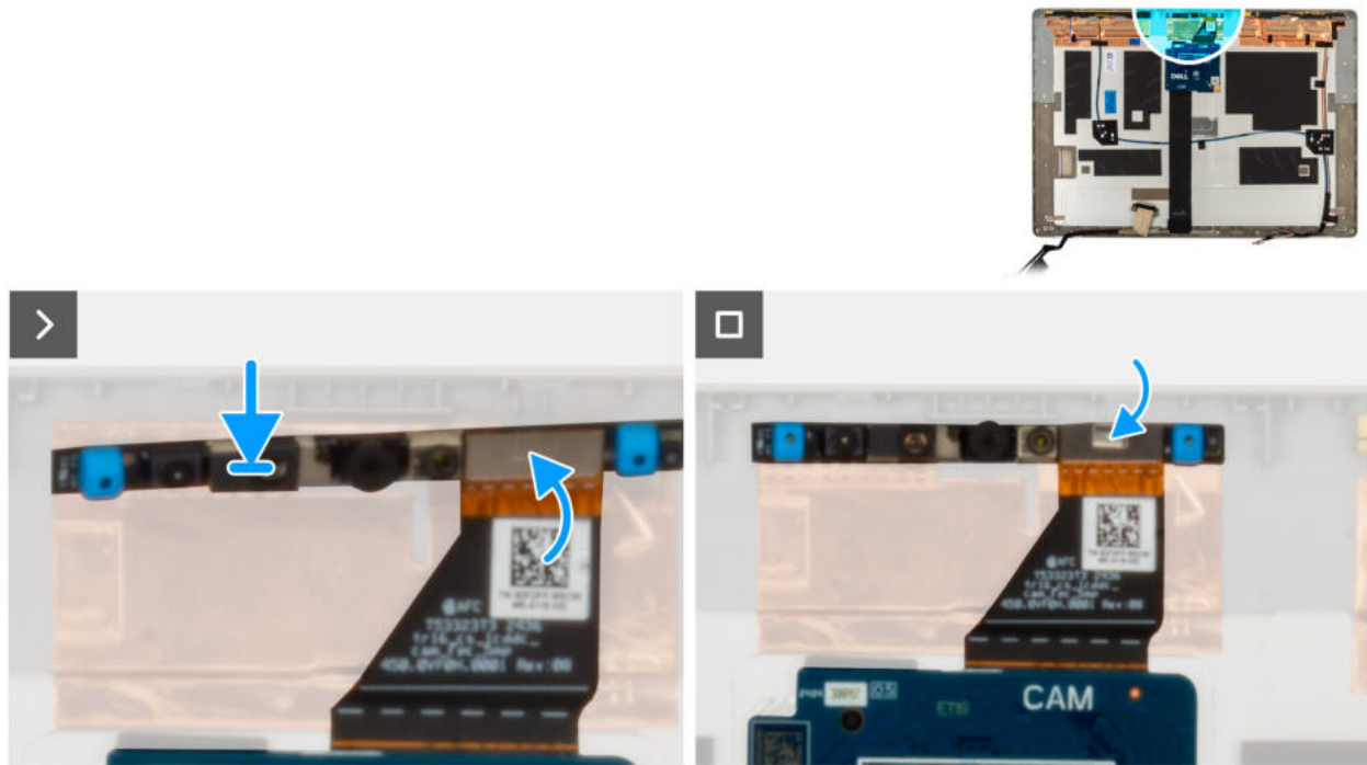
Abbildung 79. Installieren des Kameramoduls
