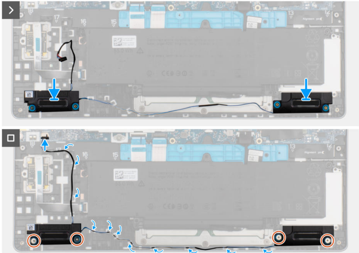
Abbildung 39. Installieren der Lautsprecher
