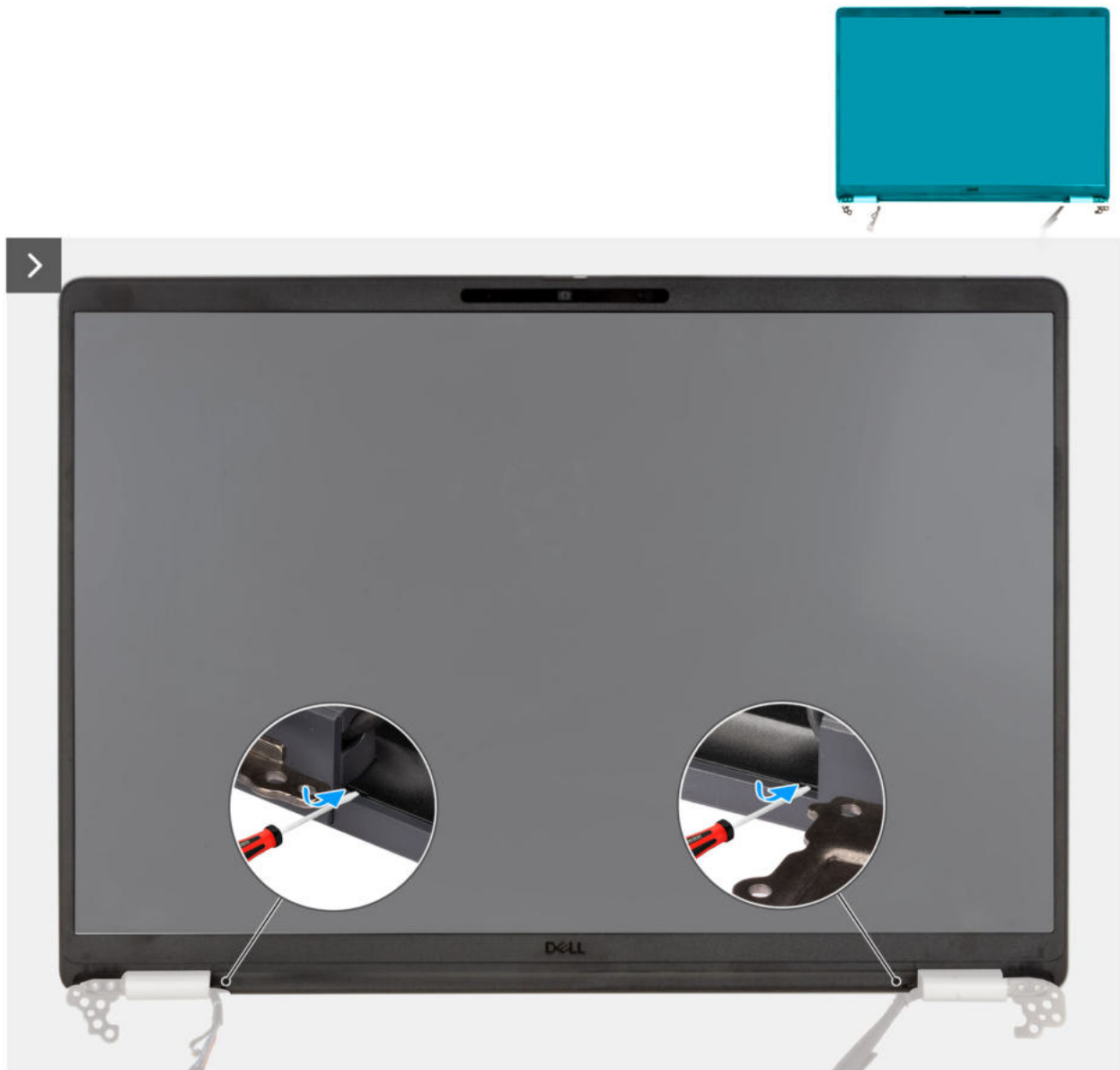
Abbildung 64. Abhebeln der Kunststoffblende
