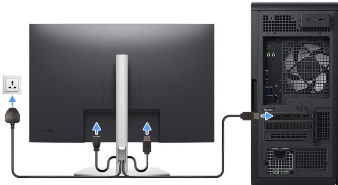
Abbildung 9. Anschließen des Displays
