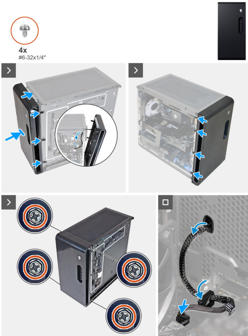
Abbildung 19. Installieren der Frontverkleidung
