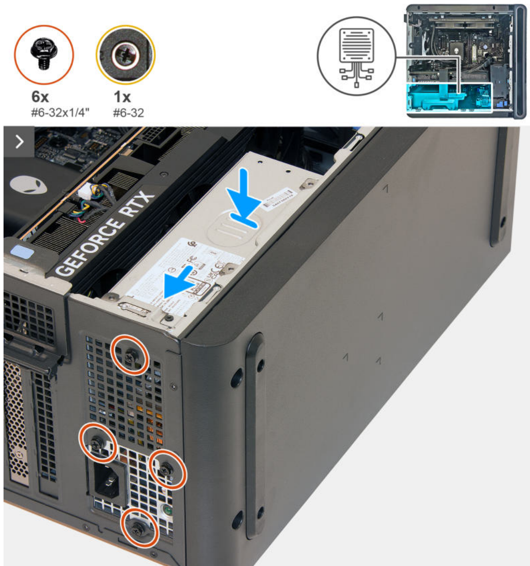
Abbildung 47. Installieren der Stromversorgungseinheit
