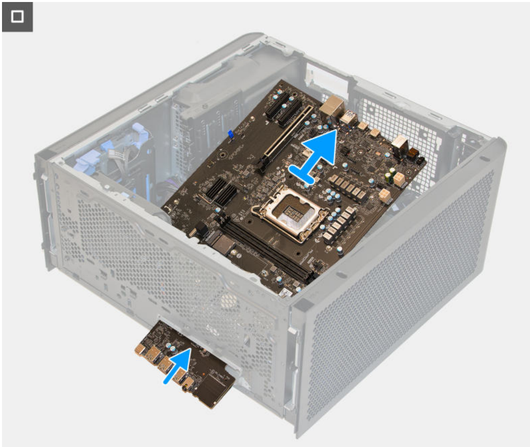
Abbildung 65. Entfernen der Systemplatine
