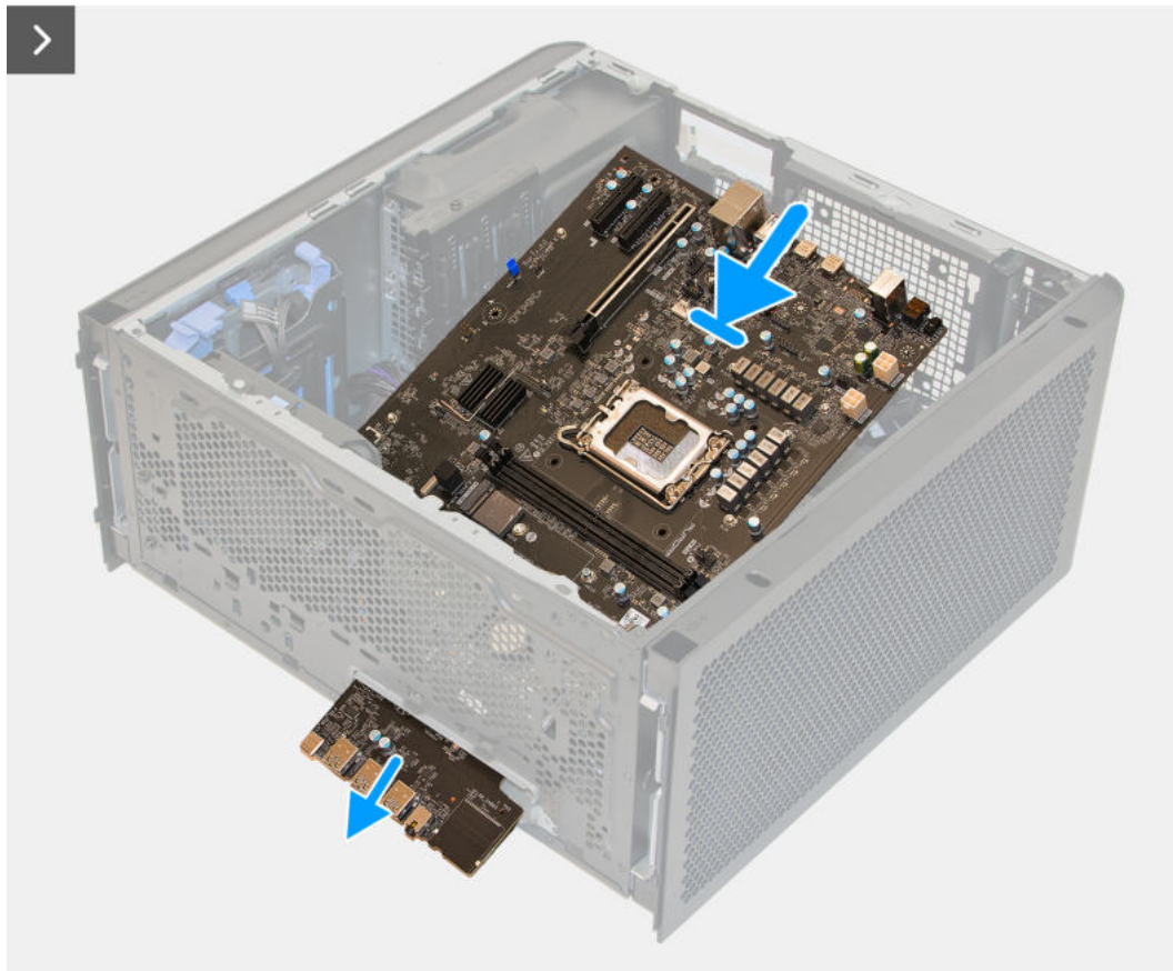
Abbildung 67. Einbauen der Systemplatine
