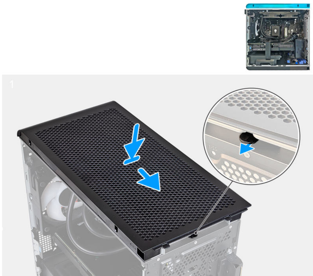
Abbildung 21. Anbringen der oberen Abdeckung
