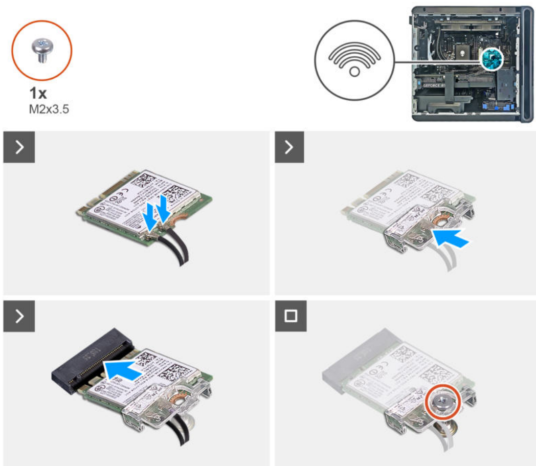
Abbildung 40. Installieren der Wireless-Karte
