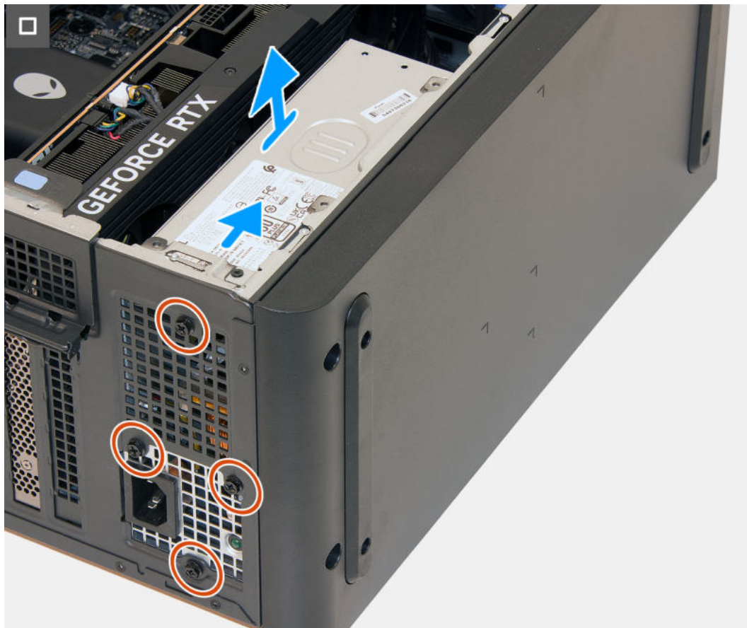
Abbildung 46. Entfernen der Stromversorgungseinheit
