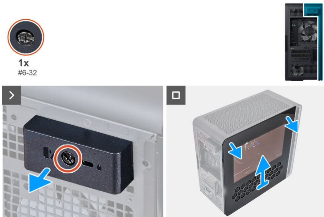
Abbildung 14. Entfernen der linken Abdeckung
