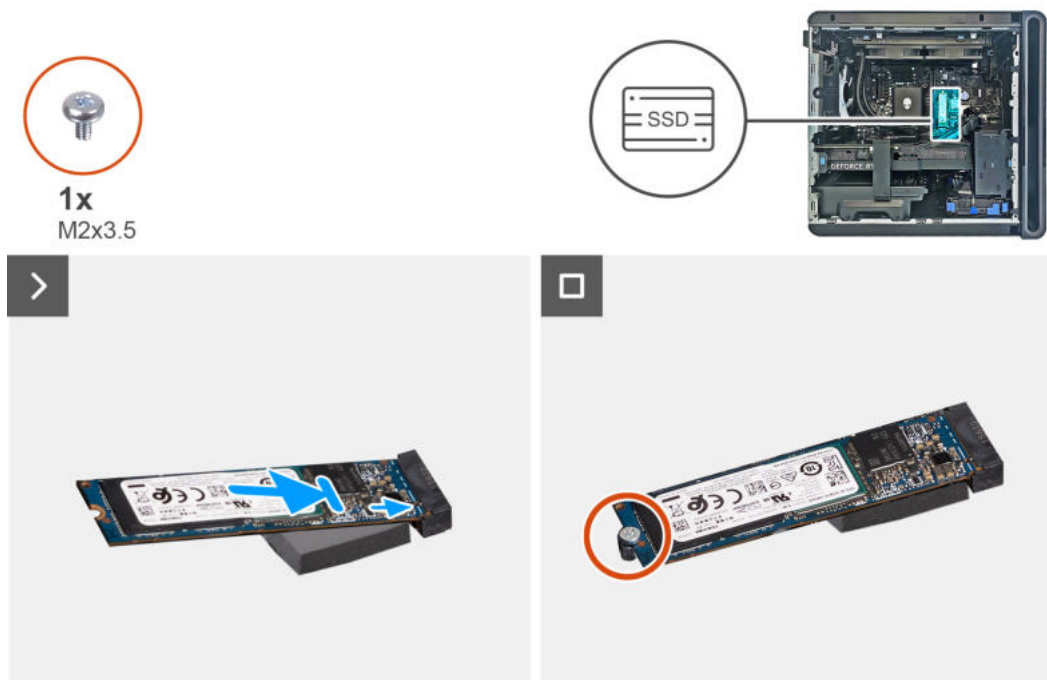
Abbildung 38. Installieren des M.2 2280-Solid-State-Laufwerks
