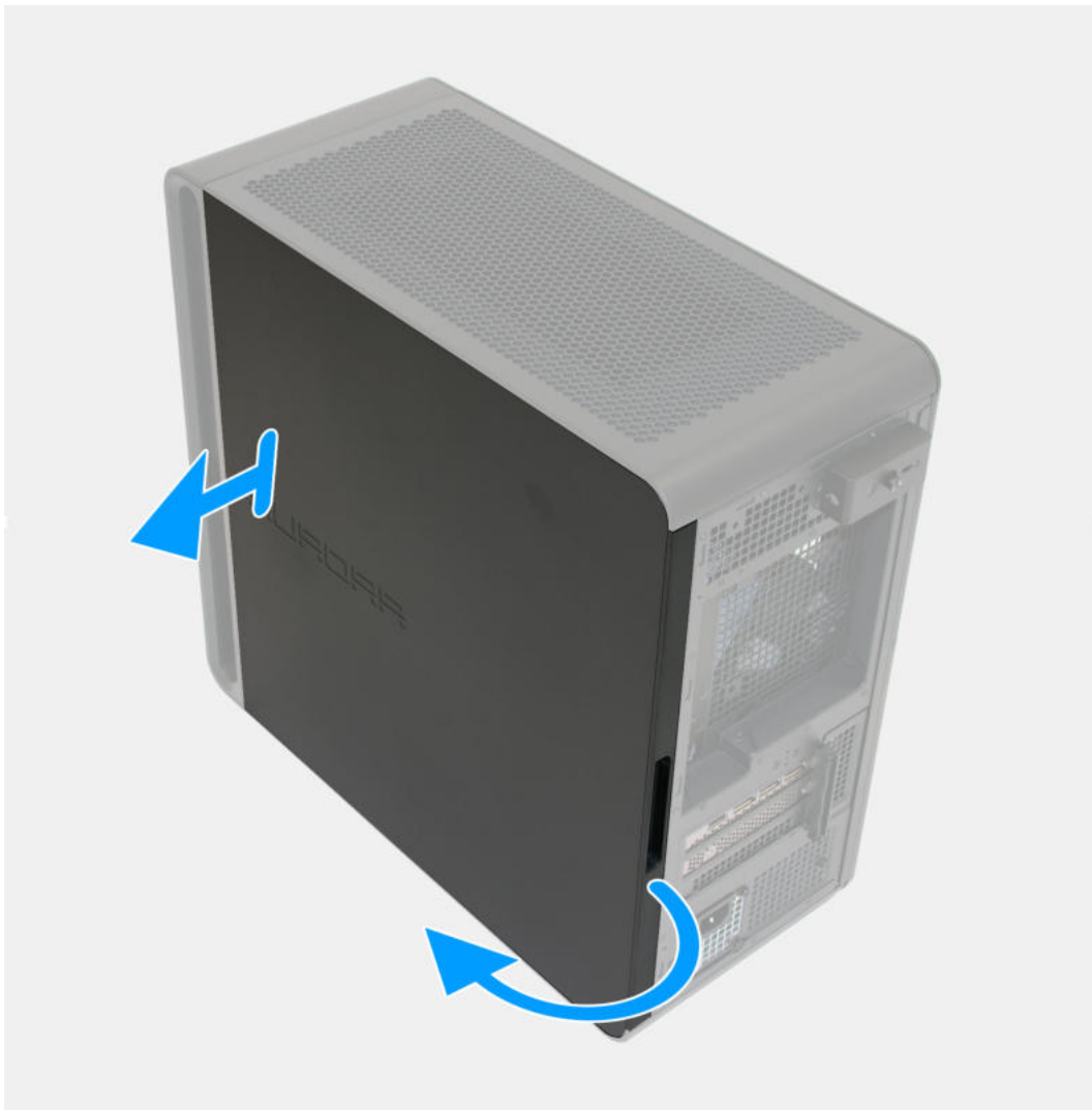
Abbildung 16. Entfernen der rechten Abdeckung
