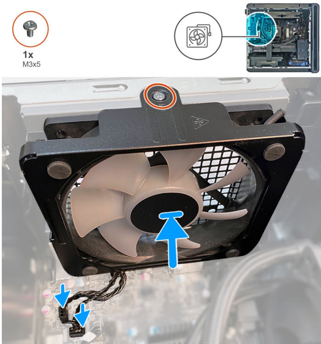
Abbildung 44. Installieren des hinteren Gehäuselüfters
