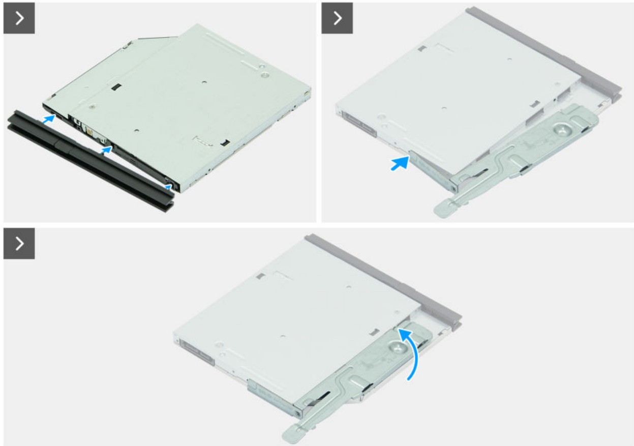
Abbildung 33. Installieren des optischen Laufwerks
