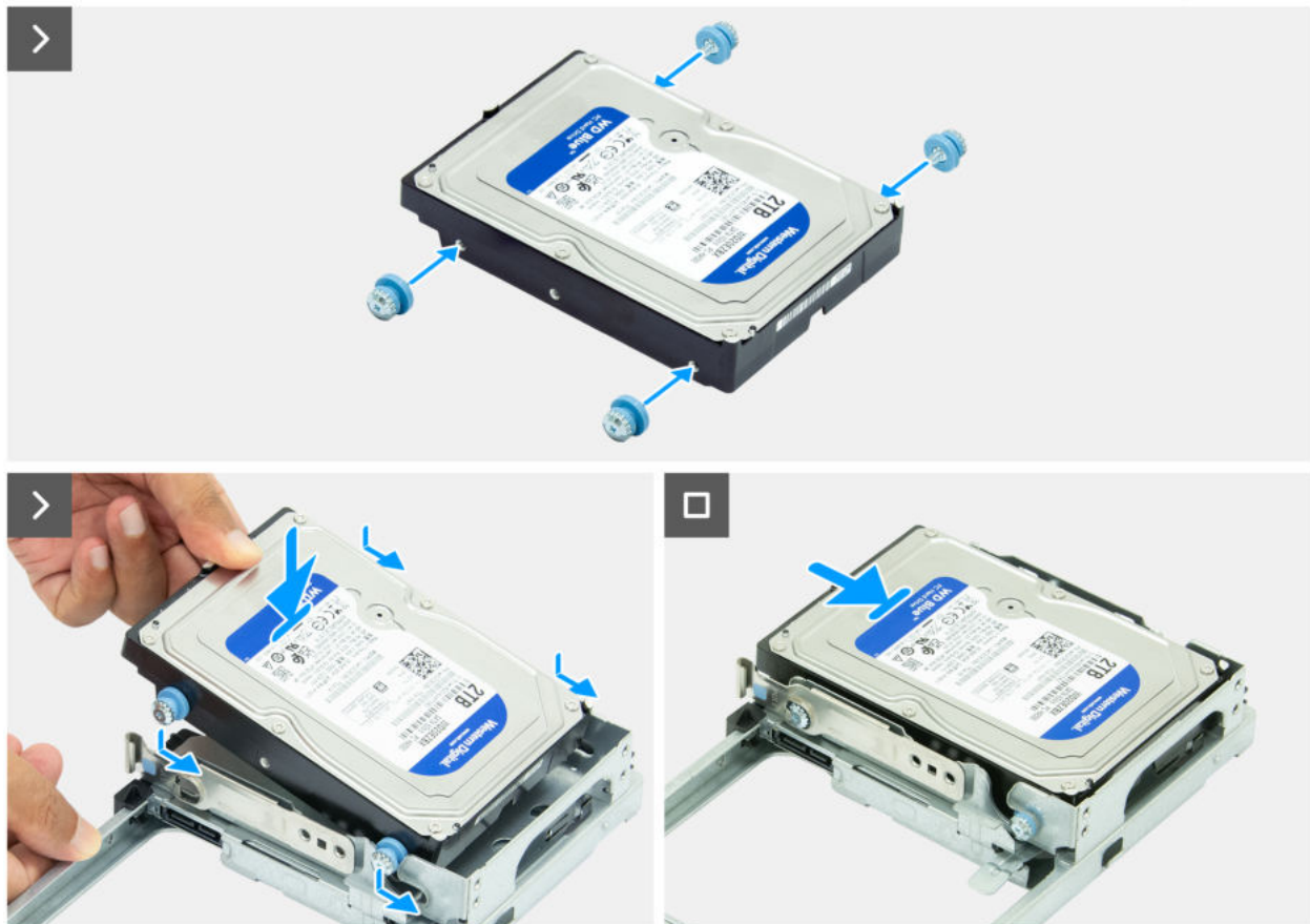
Abbildung 40. Einsetzen des Festplattenlaufwerks
