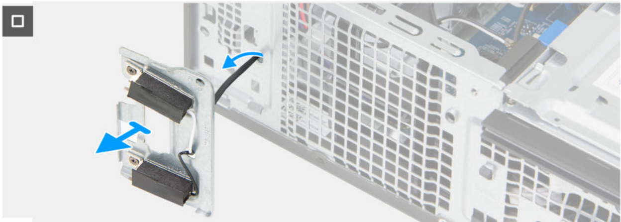
Abbildung 45. Entfernen der Antennenmodule
