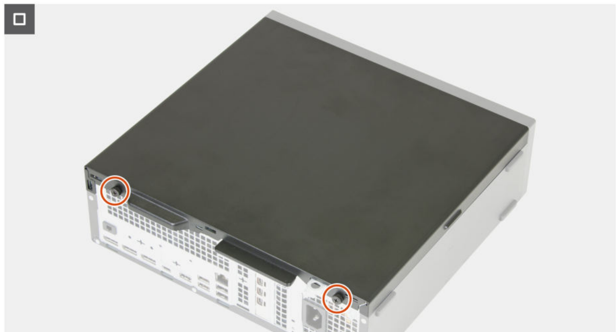
Abbildung 9. Anbringen der Seitenabdeckung
