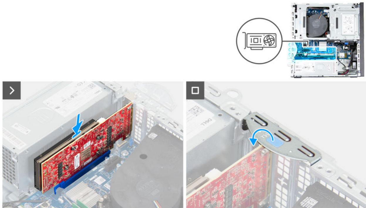
Abbildung 28. Installieren der Grafikkarte
