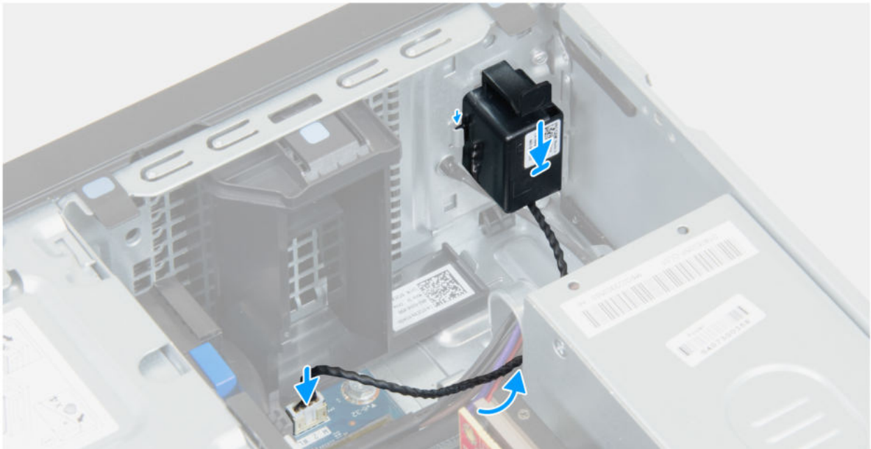
Abbildung 19. Einbauen des internen Lautsprechers
