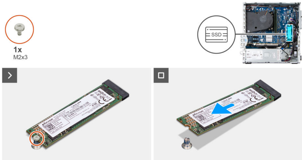
Abbildung 24. Entfernen des M.2-2280-Solid-State-Laufwerks
