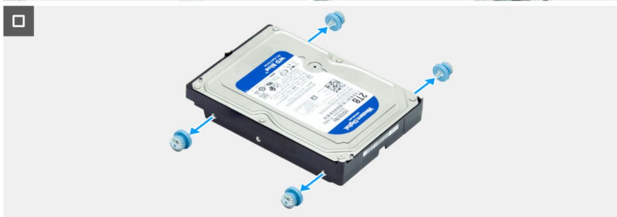
Abbildung 39. Entfernen der Festplatte
