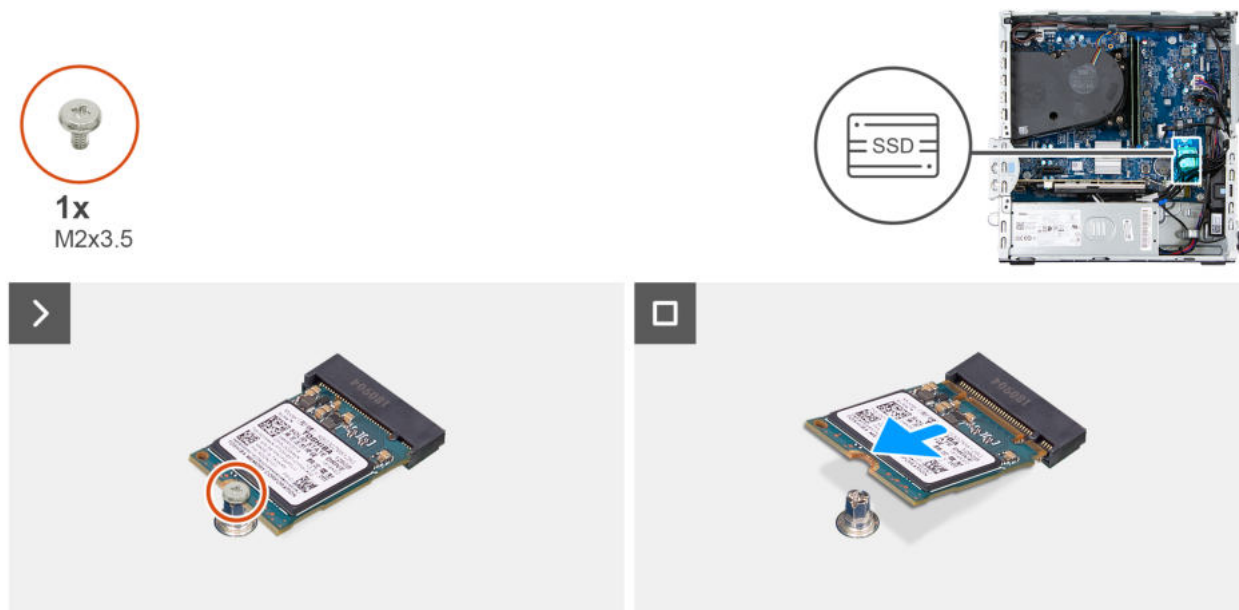
Abbildung 22. Entfernen des M.2-2230-Solid-State-Laufwerks
