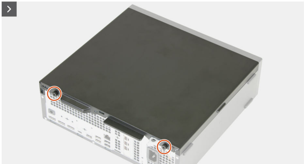
Abbildung 6. Entfernen der Seitenabdeckung
