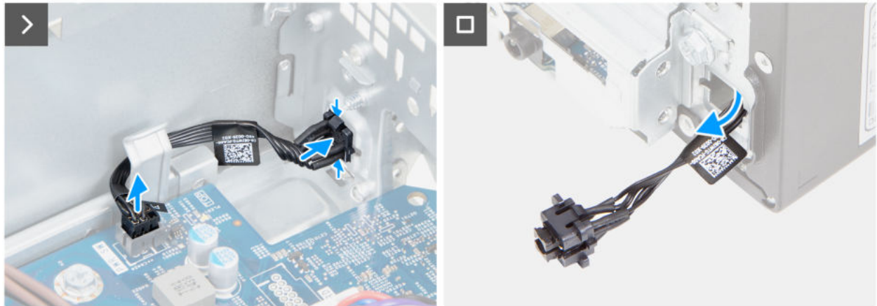
Abbildung 43. Entfernen des Netzschalters
