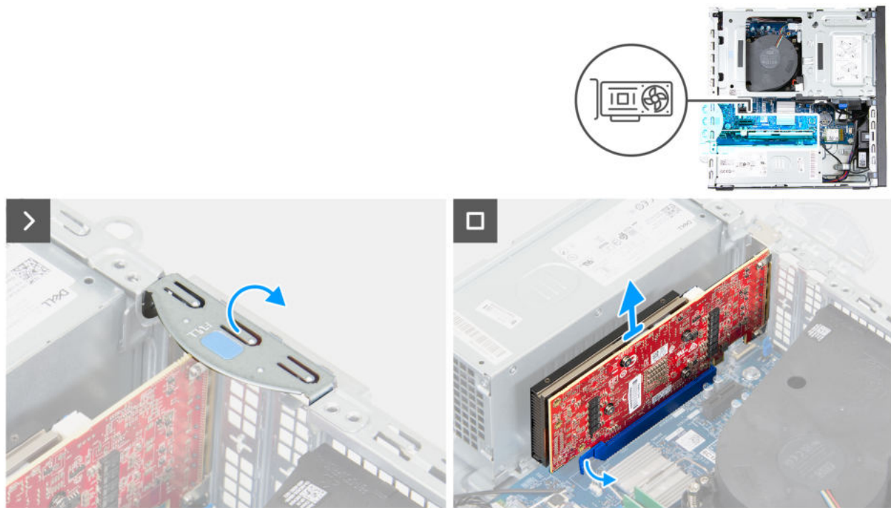
Abbildung 27. Entfernen der Grafikkarte
