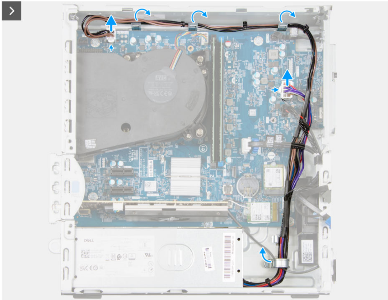
Abbildung 47. Entfernen der Stromversorgungseinheit
