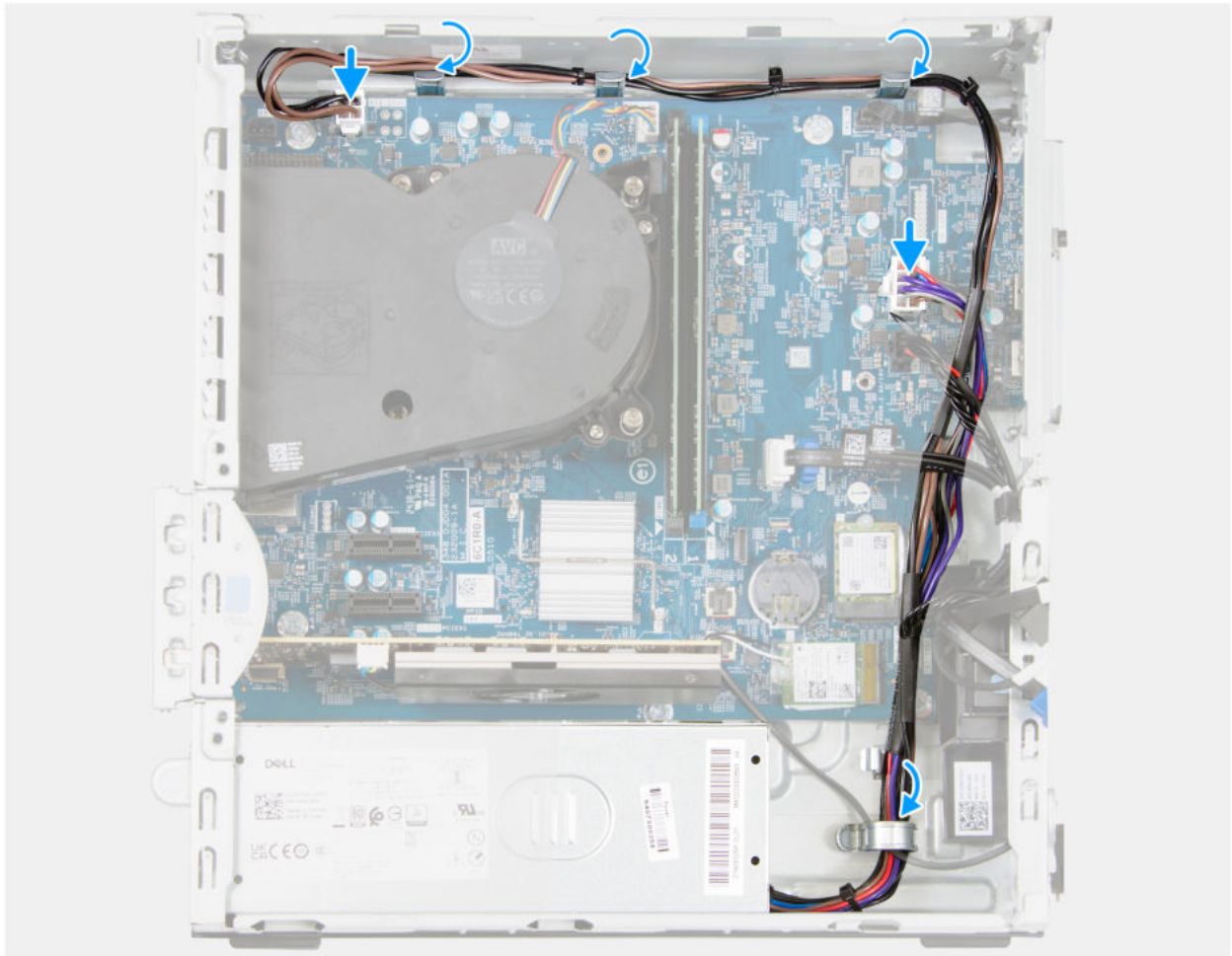
Abbildung 50. Installieren der Stromversorgungseinheit
