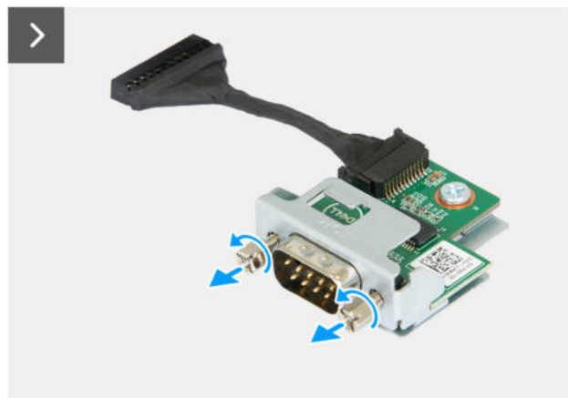
Abbildung 57. Installieren des seriellen Anschlussmoduls
