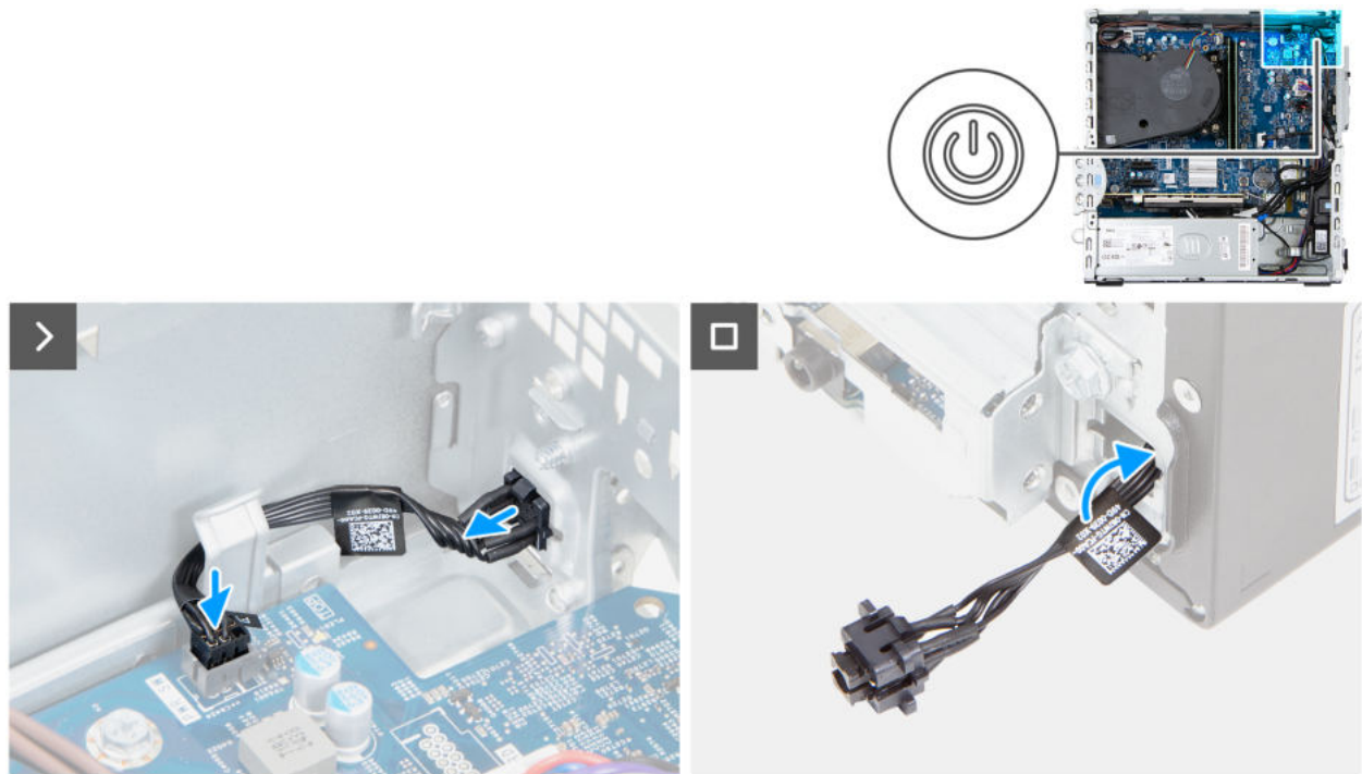
Abbildung 44. Installieren des Netzschalters
