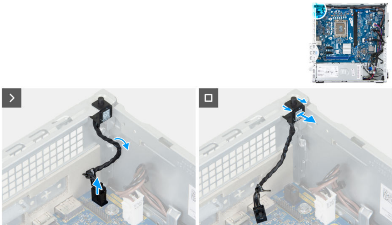
Abbildung 41. Entfernen des Eingriffsschalters
