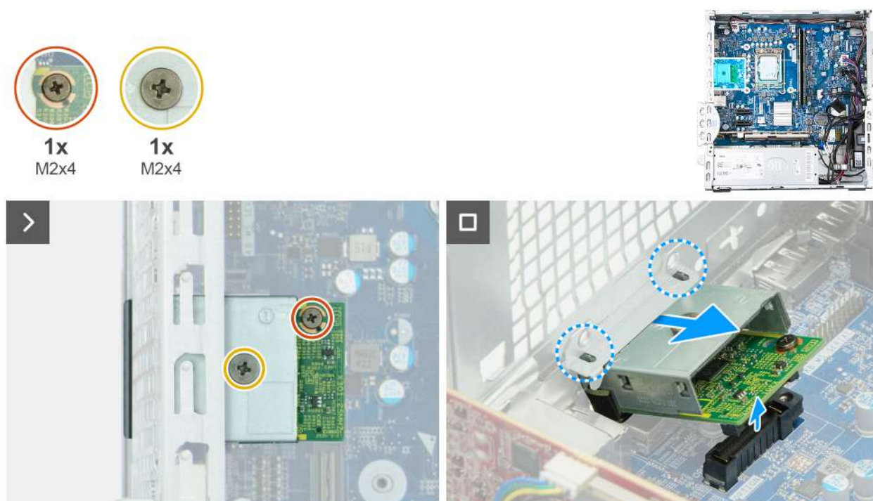
Afbeelding 53. De optionele poortmodule verwijderen
