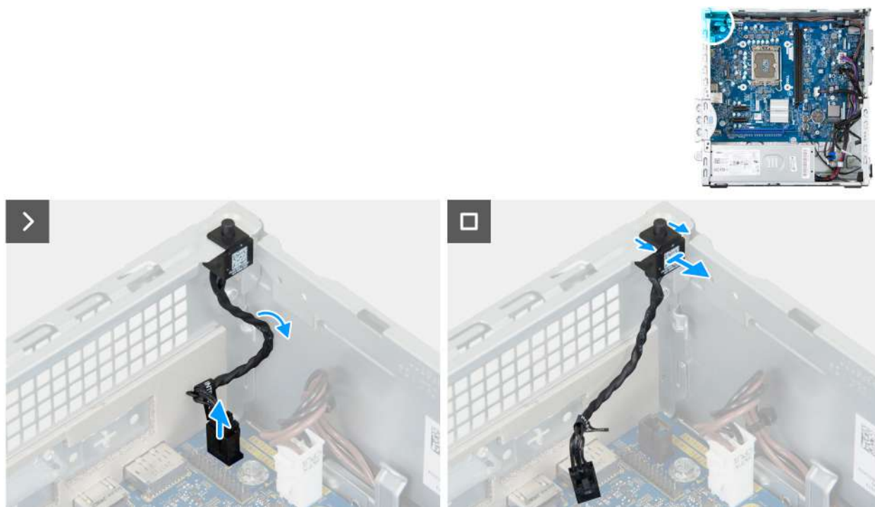
Abbeelding 41. De intrusieswitch verwijderen
