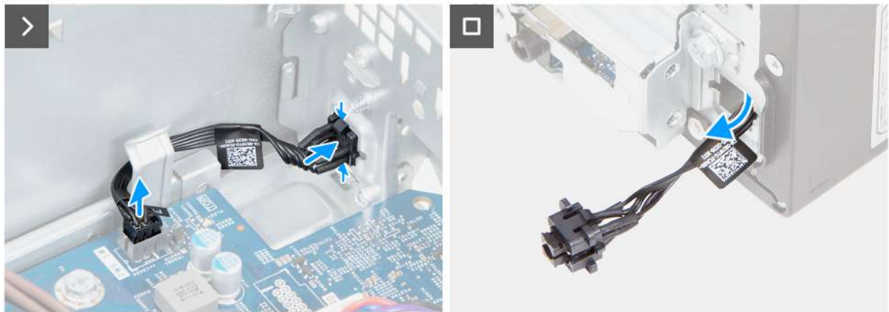
Afbeelding 43. De aan-uitknop verwijderen
