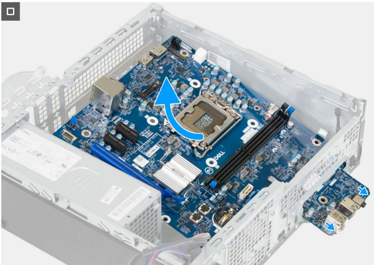
Afbeelding 65. De systeemkaart verwijderen
