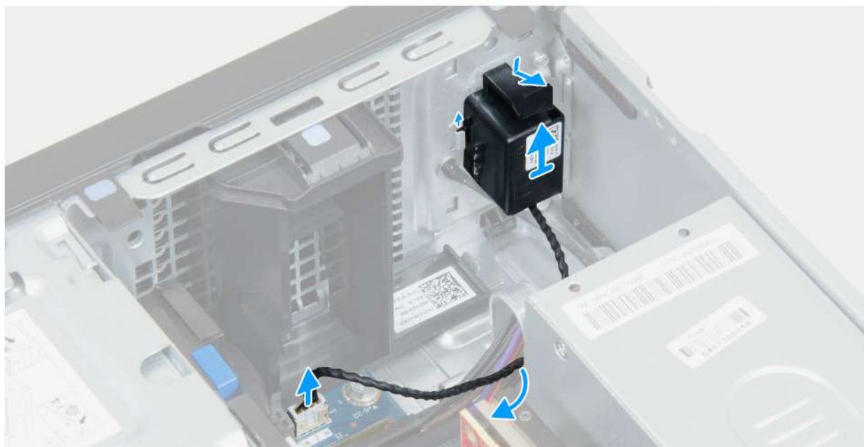
Afbeelding 18. De interne luidspreker verwijderen
