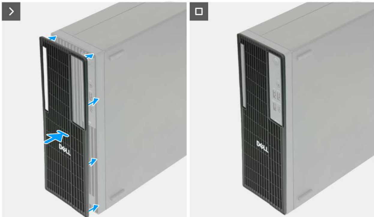
Afbeelding 15. Het stoffilter plaatsen
