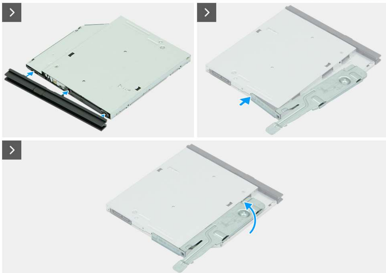
Afbeelding 33. Het optisch station plaatsen
