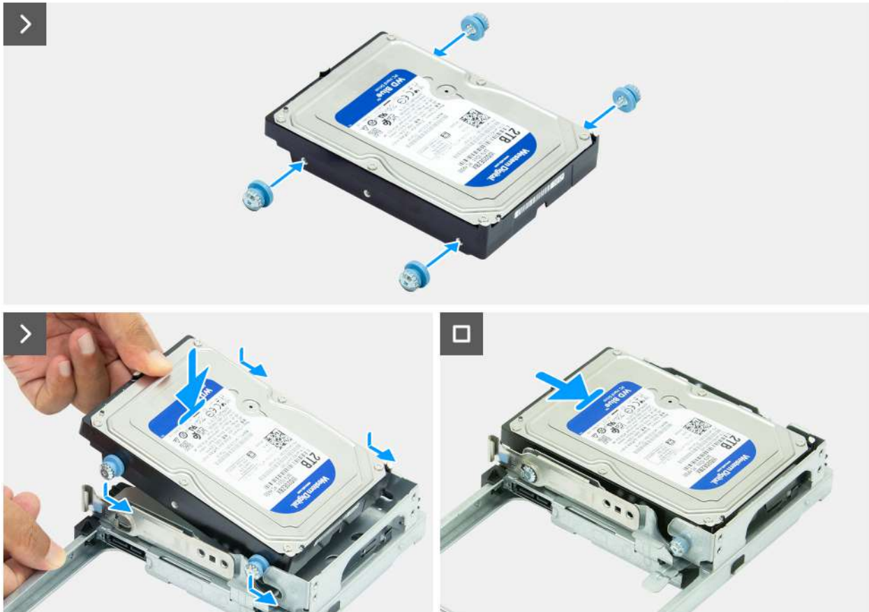
Afbeelding 40. De harde schijf plaatsen
