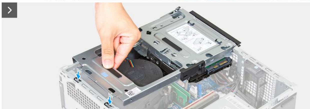
Afbeelding 37. De schijfbay installeren
