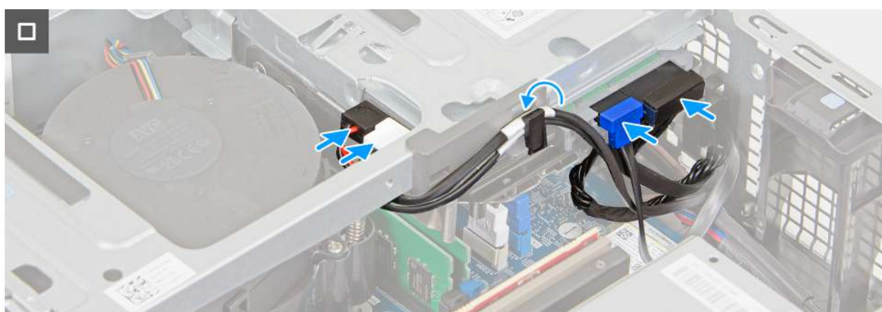
Afbeelding 38. De schijfbay installeren
