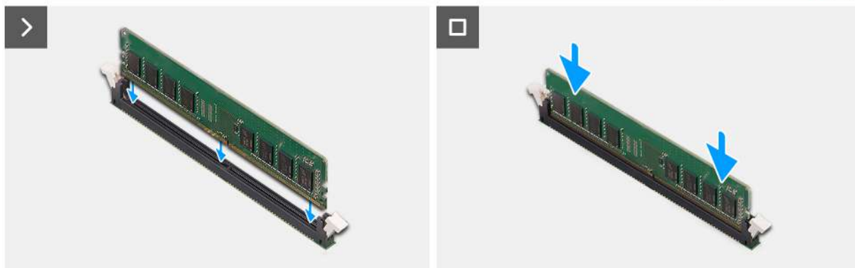
Afbeelding 21. De geheugenmodule plaatsen
