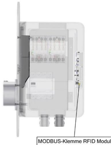
*Abbildung 4 Anschluss des Modbuskabels*
