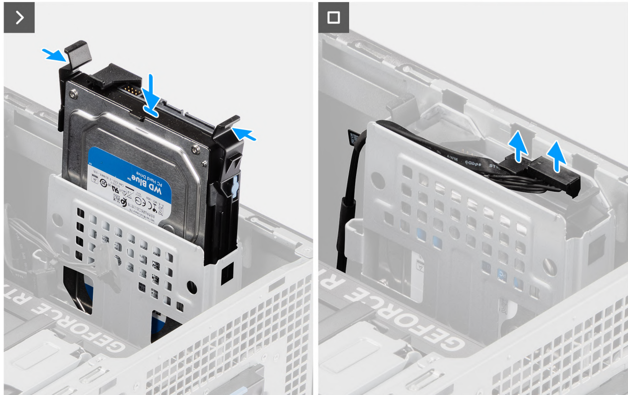
Afbeelding 29. De 3,5 inch harde-schijf eenheid (bay-2) installeren
