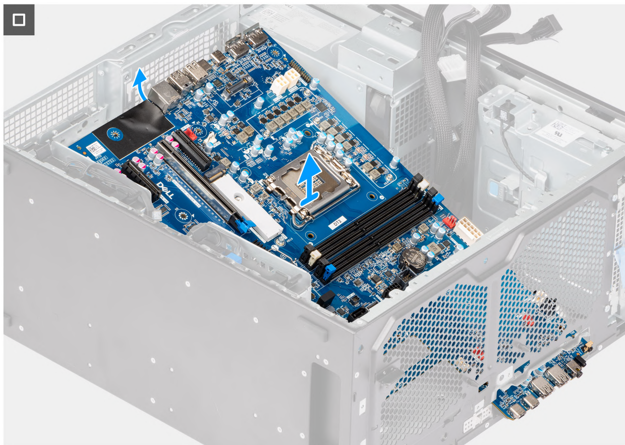
Afbeelding 92. De systeemkaart verwijderen
