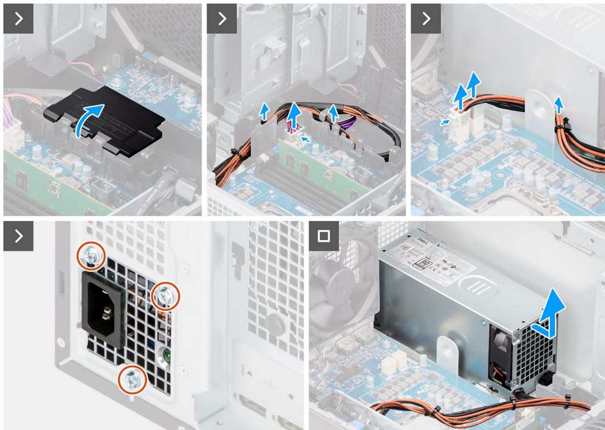
Afbeelding 57. De voedingseenheid van 360 W verwijderen
