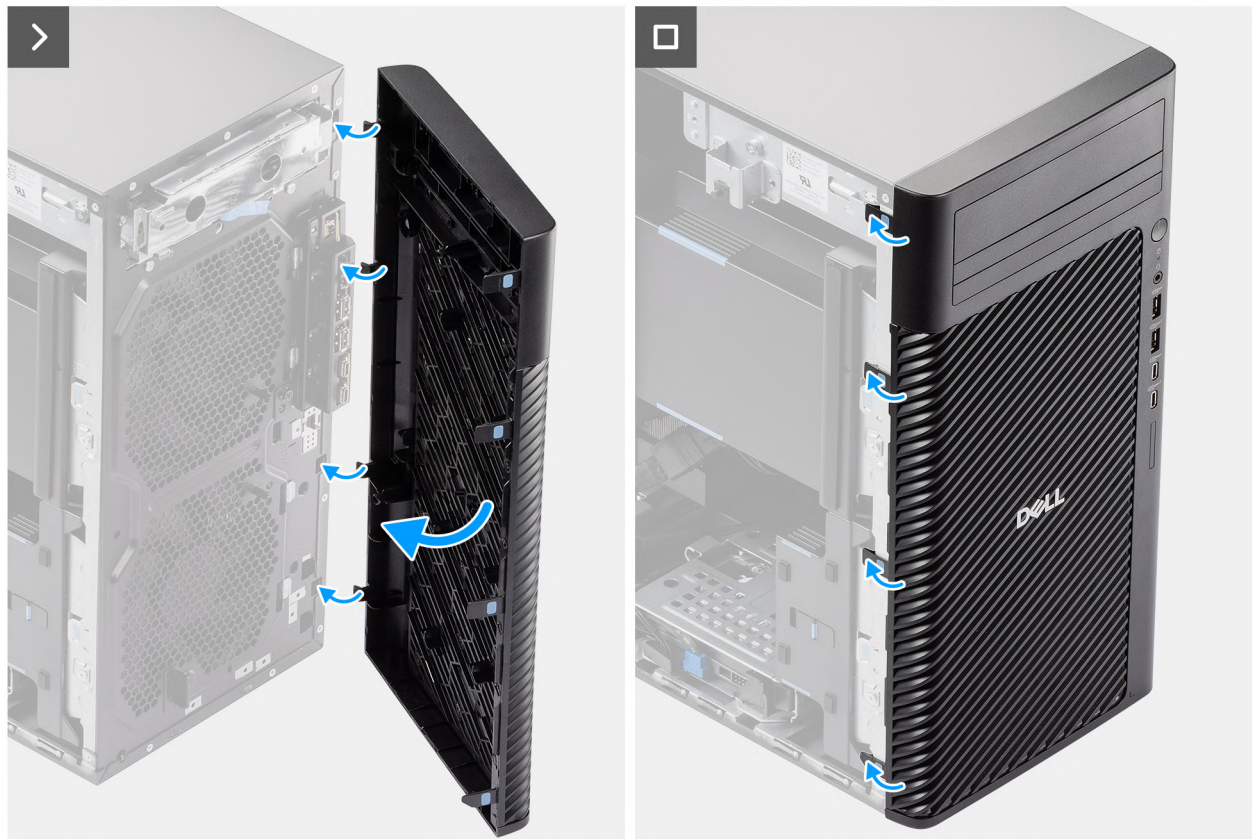
Afbeelding 18. Het montagekader aan de voorkant plaatsen
