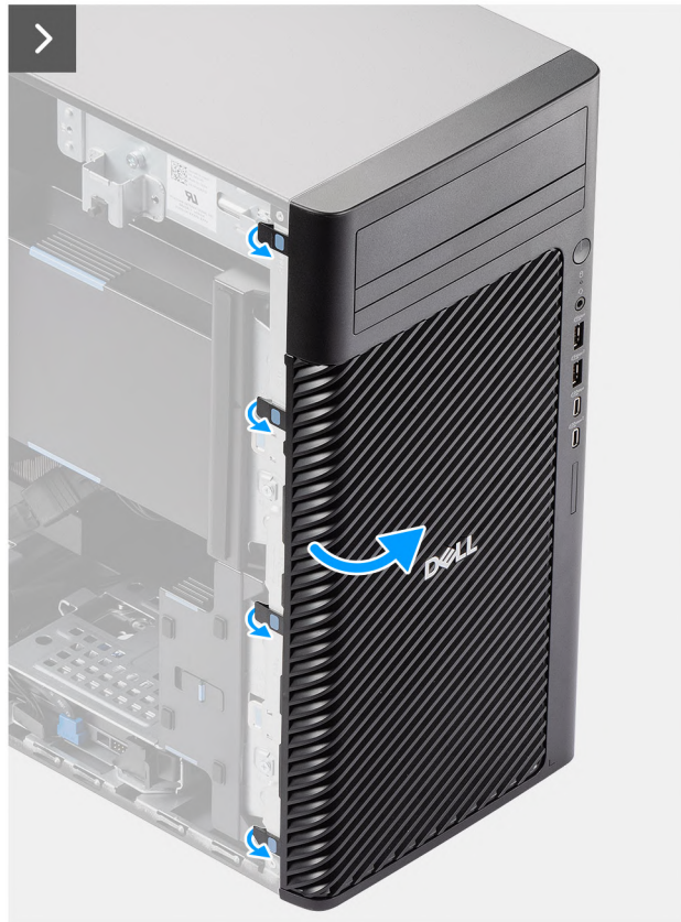
Afbeelding 17. Het montagekader aan de voorkant verwijderen
