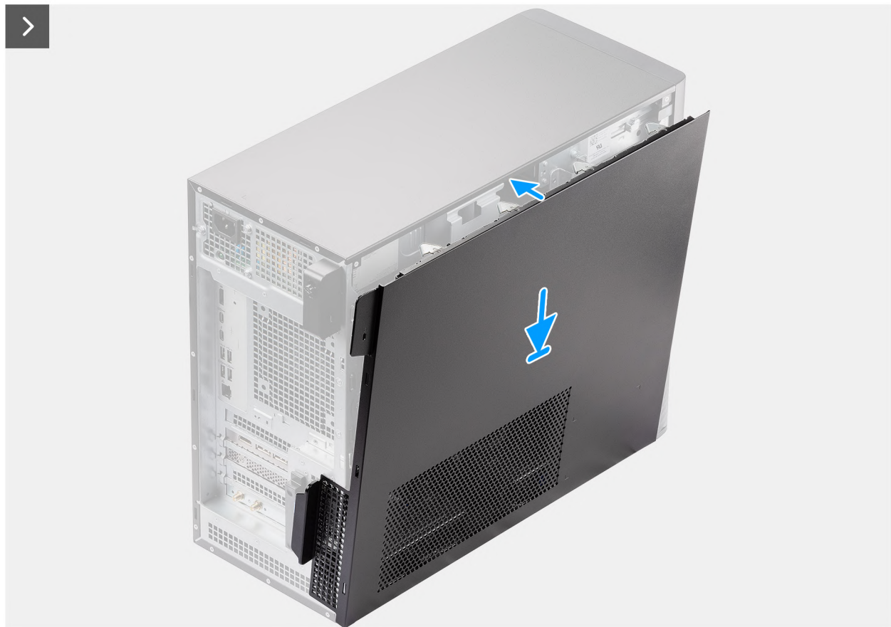
Afbeelding 11. De zijplaat plaatsen
