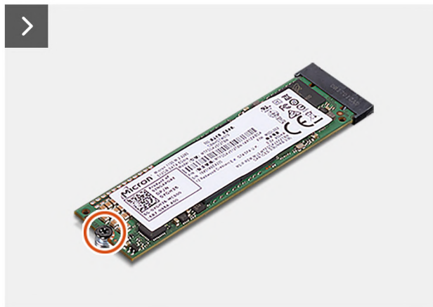
Afbeelding 33. De M.2 2280 PCIe SSD verwijderen
