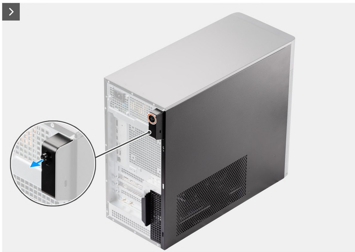
Afbeelding 9. De zijplaat verwijderen
