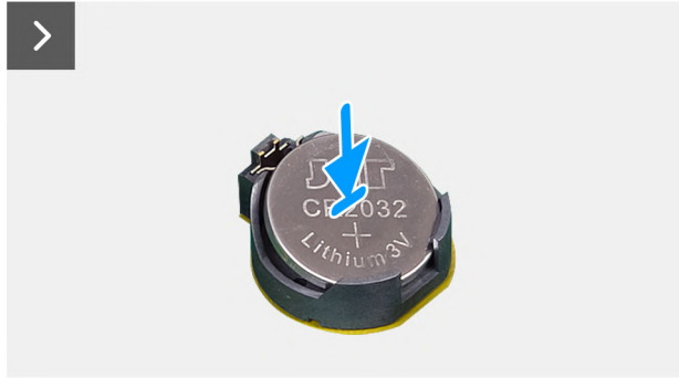
Afbeelding 16. De knoopcelbatterij plaatsen
