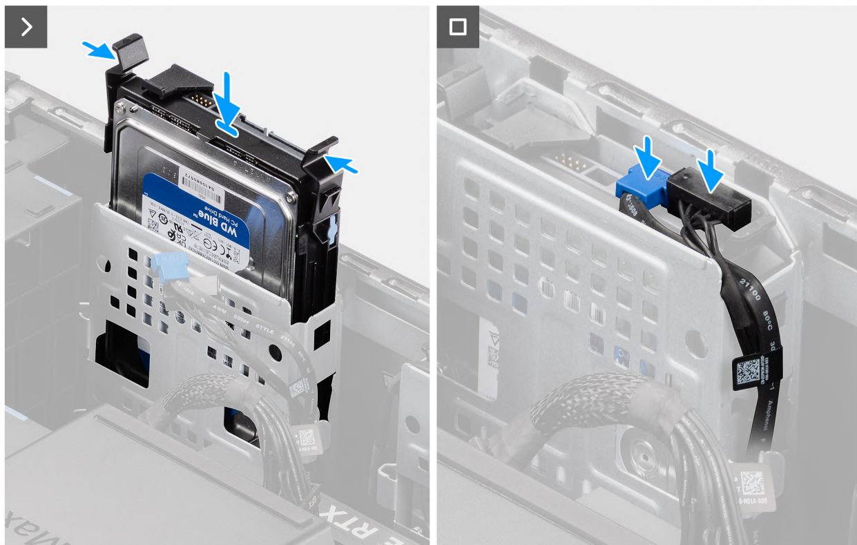
Afbeelding 30. De 3,5-inch harde-schijfeenheid vanuit bay 1 installeren
