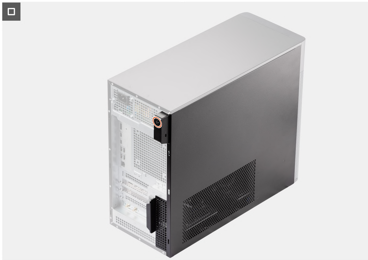
Afbeelding 12. De zijplaat plaatsen
