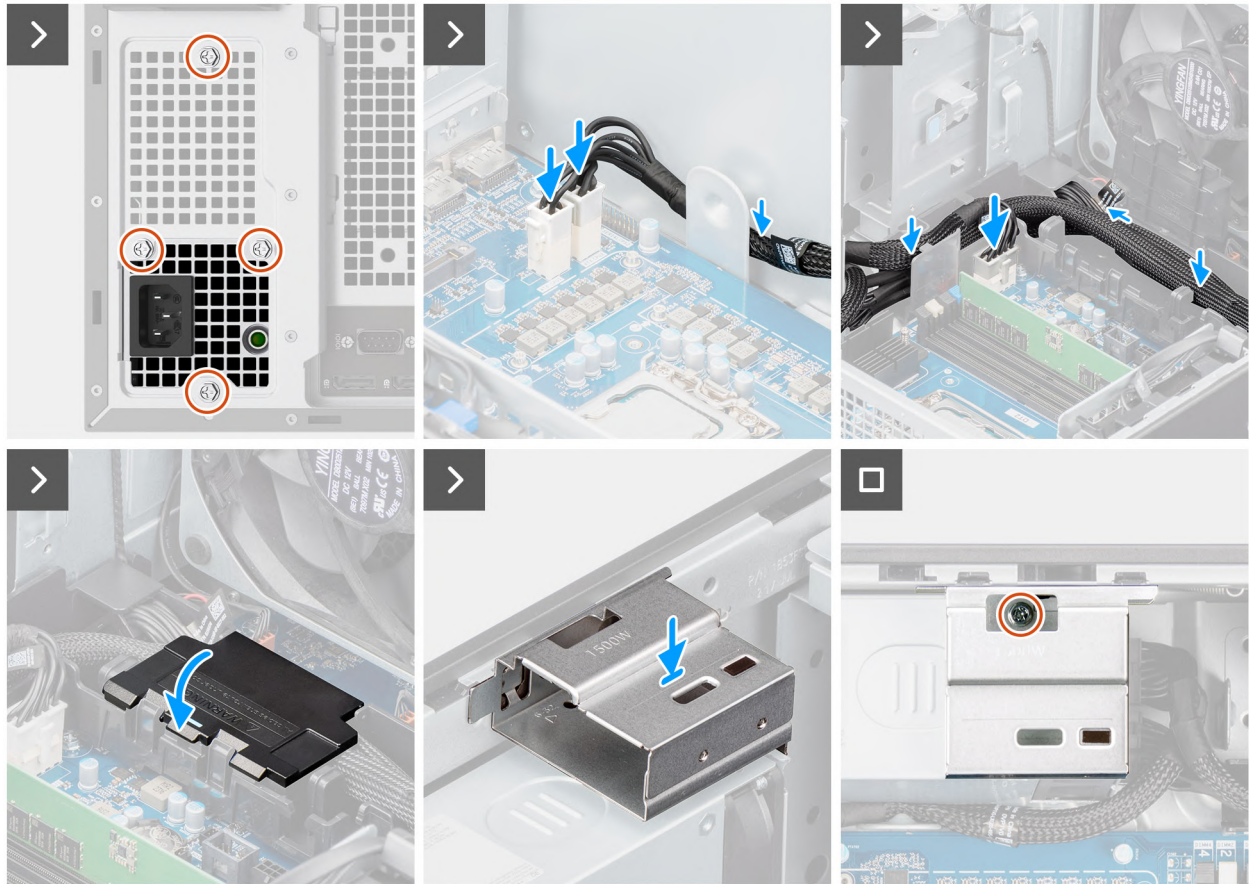
Afbeelding 56. De voedingseenheid van 1500 W plaatsen
