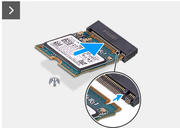
Afbeelding 32. De M.2 2230 PCIe SSD plaatsen
