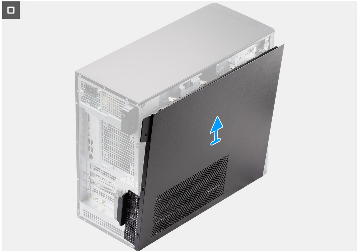
Afbeelding 10. De zijplaat verwijderen
