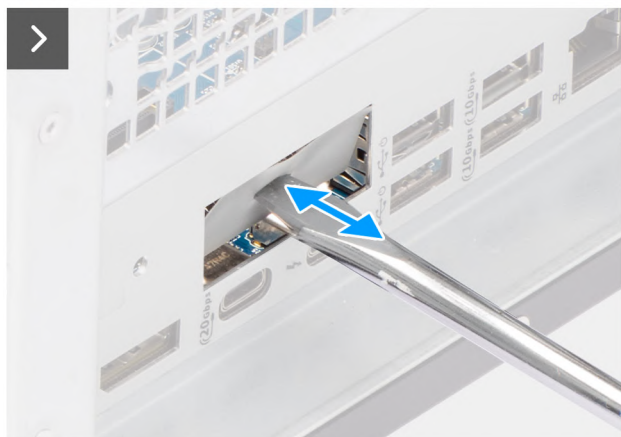
Afbeelding 80. De optionele Thunderbolt-module installeren
