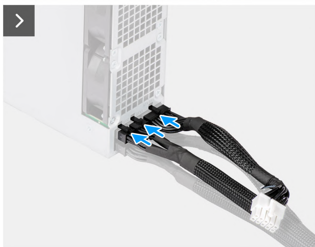
Afbeelding 55. De voedingseenheid van 1500 W plaatsen
