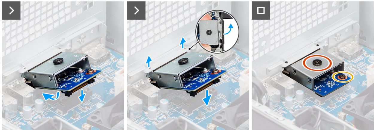
Afbeelding 87. De optionele VGA-module installeren.
