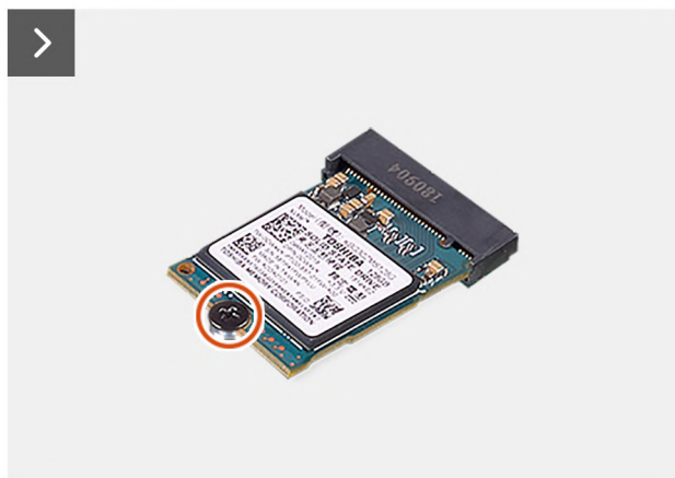
Afbeelding 31. De M.2 2230 PCIe SSD verwijderen
