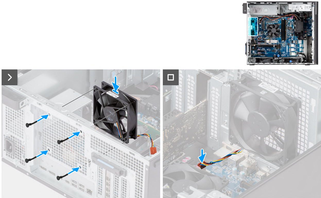
Afbeelding 50. De achterste ventilator voor 360 W PSU-systemen installeren
