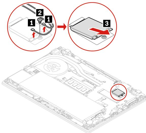
**Anmerkung:** Stellen Sie nach der Installation sicher, dass Sie das orangefarbige Kabel mit dem Anschluss mit der Kennzeichnung Orange (orange) und das blaue Kabel mit dem Anschluss mit der Kennzeichnung Blue (blau) verbinden.
