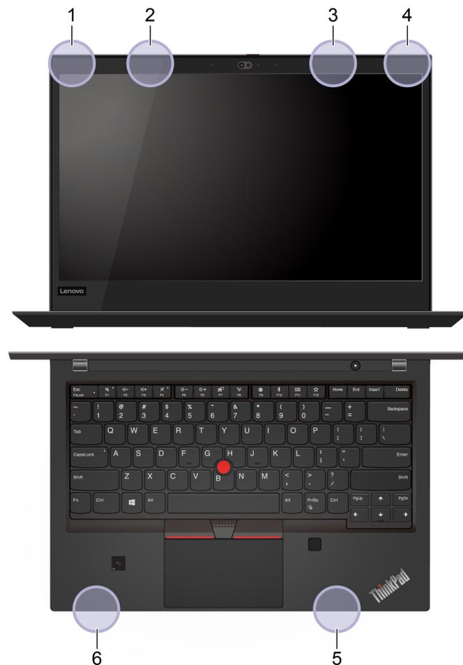
1. Antenne für drahtlose LAN-Verbindungen (Hauptantenne)
