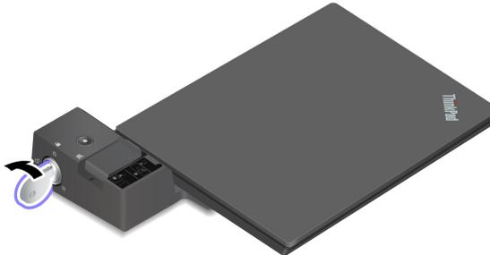
2. Schieben Sie die Verriegelung in die angezeigte Richtung **1**, um den Computer freizugeben. Fassen Sie dann an beide Seiten des Computers, um ihn zu entfernen **2**.
