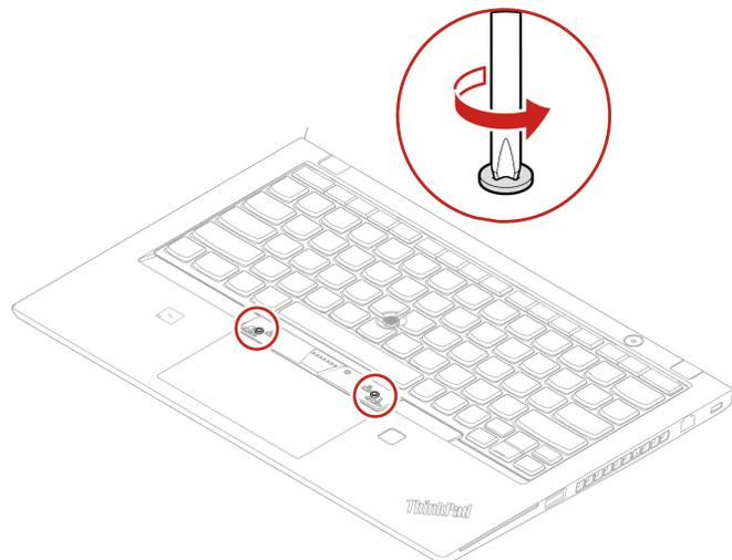
4. Setzen Sie die Laschen **c** und **d** wie dargestellt in die zwei Vertiefungen in der Nähe der beiden Schraubenköpfe ein.
