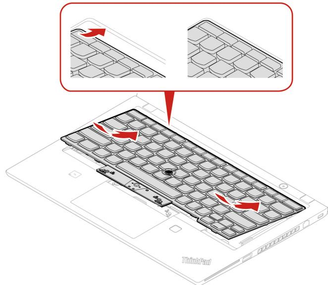
3. Schieben Sie die Tastatur in die durch die Pfeile angegebene Richtung. Vergewissern Sie sich, dass die Verriegelungen unter dem Tastaturrahmen gesichert sind.
