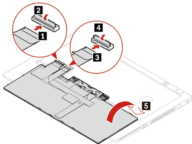
2. Setzen Sie die Tastatur wie abgebildet in die Tastaturblende ein. Vergewissern Sie sich, dass sich die obere Kante der Tastatur (die zum Bildschirm weisende Kante) unter der Tastaturblende befindet.
