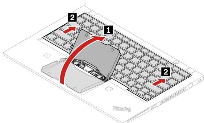
6. Schwenken Sie die Tastatur leicht nach oben, wie durch den Pfeil **1** dargestellt. Wenden Sie die Tastatur dann in die von Pfeil **2** angegebene Richtung.
