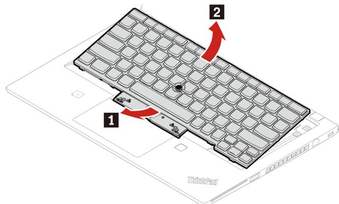
7. Legen Sie die Tastatur auf die Handablage, wie in der Abbildung dargestellt, und ziehen Sie die Steckverbinder ab. Entfernen Sie anschließend die Tastatur.
