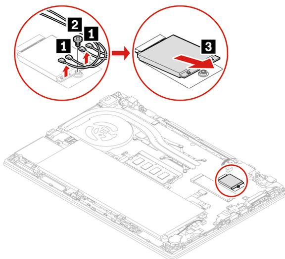
**Anmerkung:** Stellen Sie nach der Installation sicher, dass Sie das orangefarbene Kabel mit dem Anschluss mit der Kennzeichnung Orange (orange) an der Karte, das blaue Kabel mit dem Anschluss mit der Kennzeichnung Blue, das weiße und graue Kabel mit dem M1-Anschluss und das schwarze und graue Kabel mit dem M2-Anschluss verbinden.
