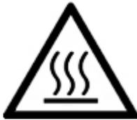
Dieses Symbol weist auf eine heiße Oberfläche oder Komponente hin. Beim Berühren dieser Oberfläche besteht Verletzungsgefahr.
