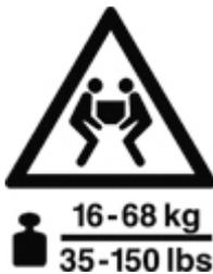
Wenn ein Gerät oder eine Baugruppe mit diesen Symbolen gekennzeichnet ist, sollte das Gerät oder die Baugruppe aufgrund des hohen Gewichts nur von mehreren Personen bewegt werden.
