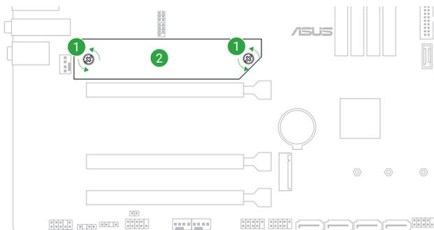
3. (optionnel) Installez la protection en caoutchouc pour module M.2 fournie lorsque vous installez un module M.2 simple face. N'installez pas la protection en caoutchouc pour module M.2 fournie sur un module M.2 double-face.
