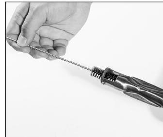
**SCHRITT 04** Bürsten Sie die gesamte Außenfläche des Brenners, um Schmutz zu entfernen.
