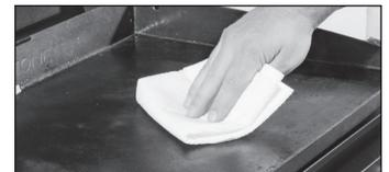
**SCHRITT 05** Tragen Sie eine dünne Schicht Speiseöl auf, um die Würze zu erhalten und die Grillplatte zu schützen.
