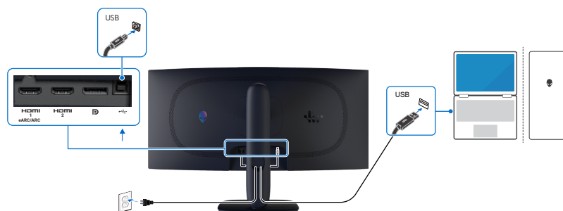
Abbildung 26. Das USB-Type-B-Kabel (Type-B auf Type-A) anschließen
