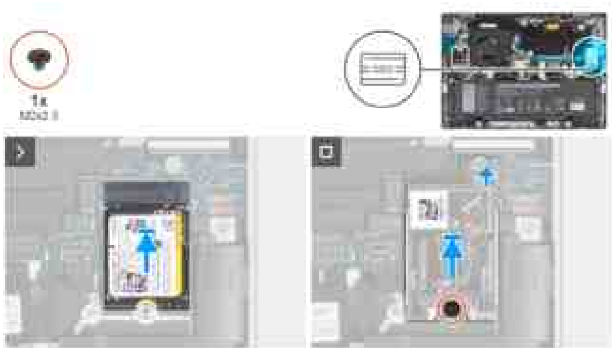
Abbildung 24. Einbauen der SSD
