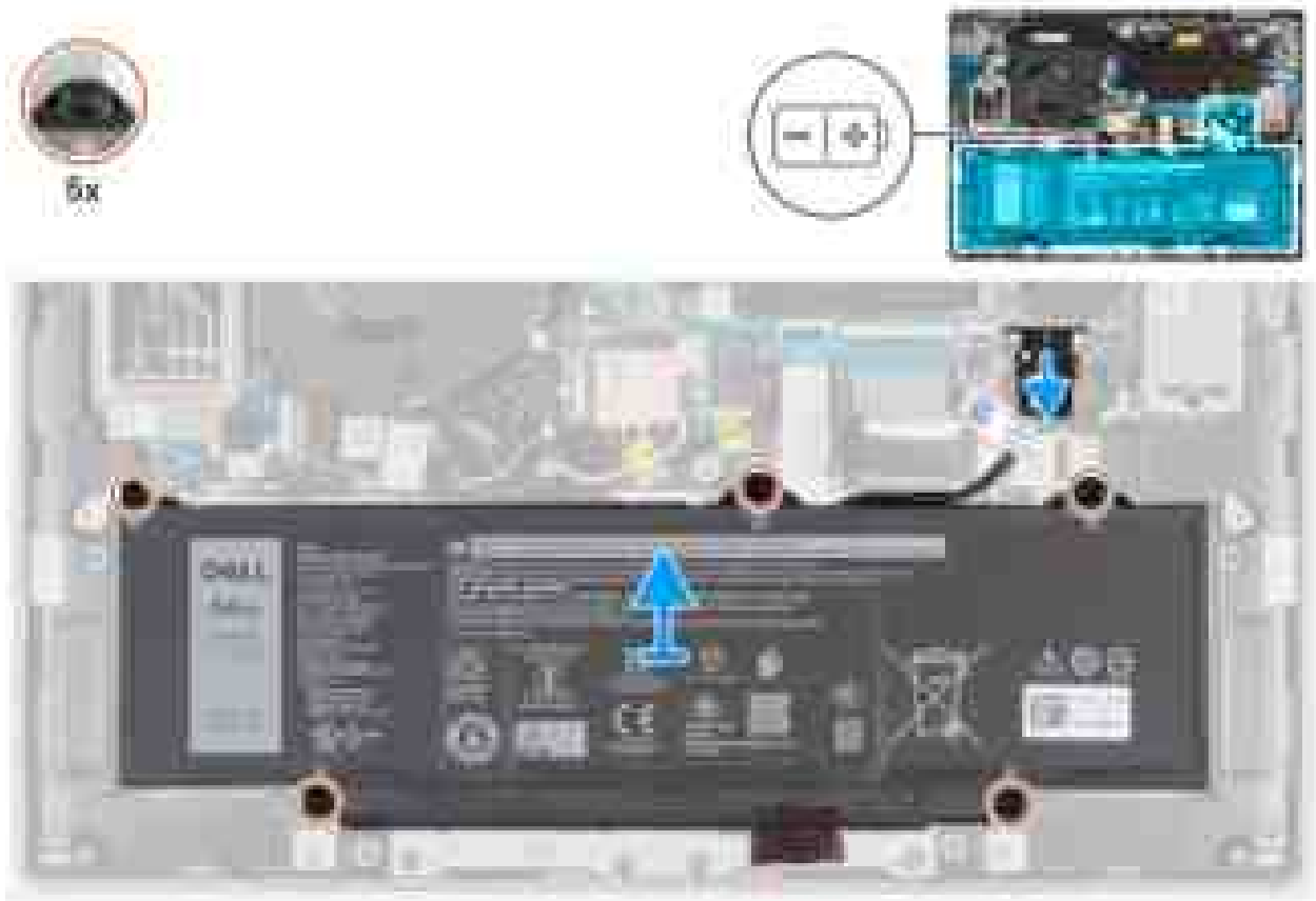
Abbildung 40. Entfernen des Akkus
