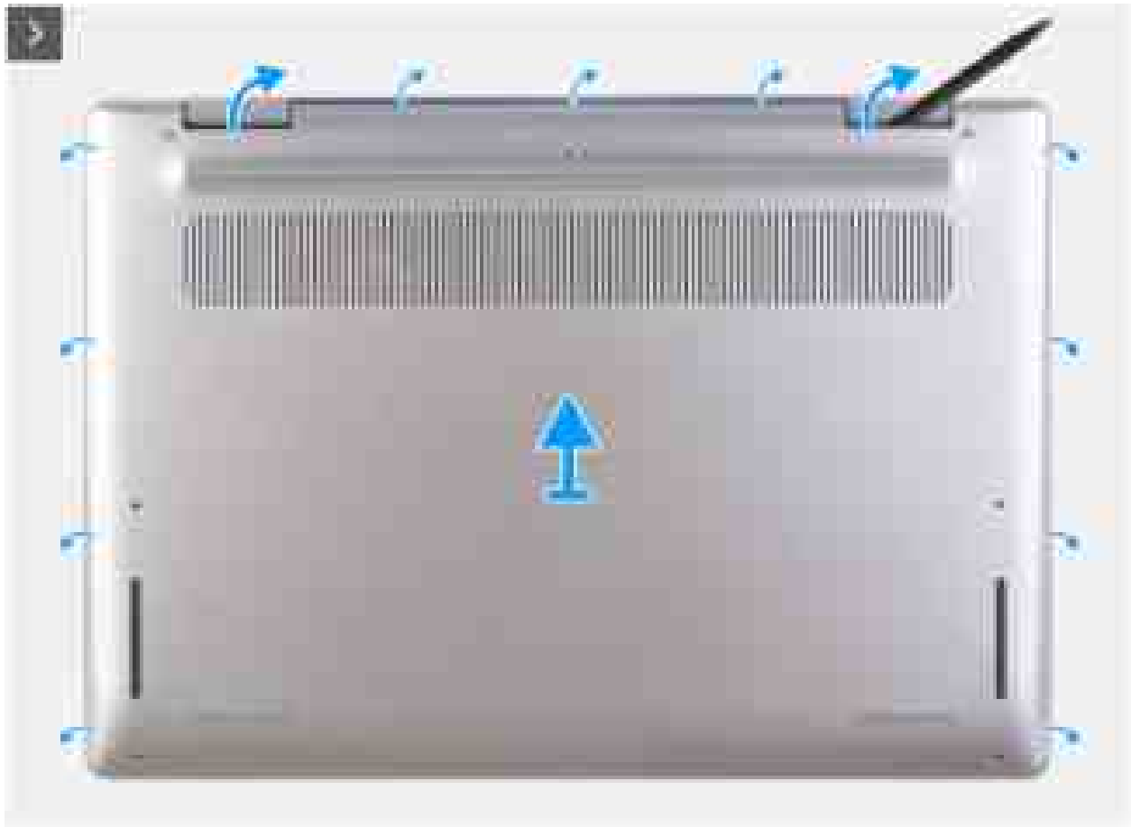
Abbildung 17. Entfernen der Bodenabdeckung
