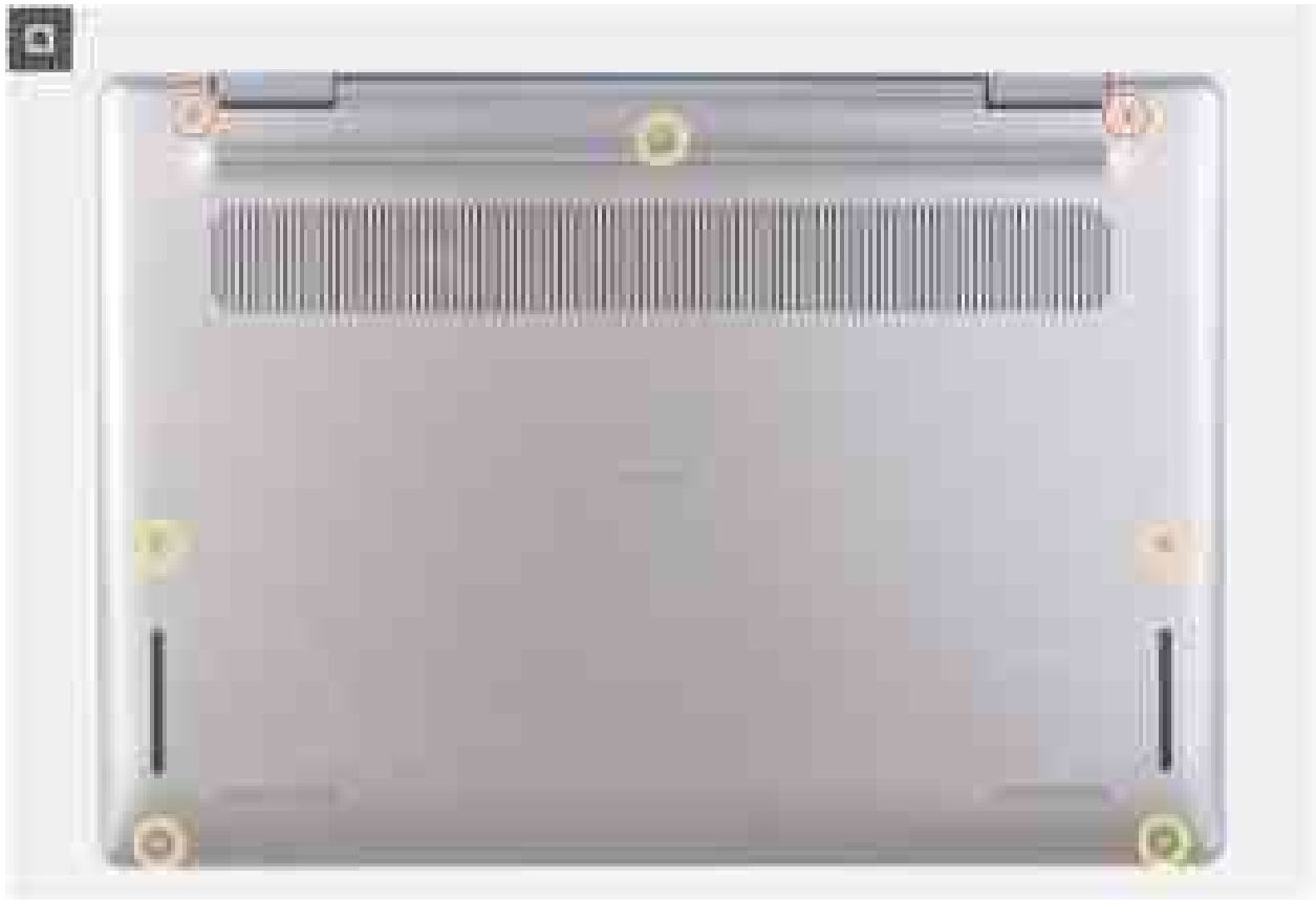
Abbildung 21. Einsetzen und Anziehen der Schrauben
