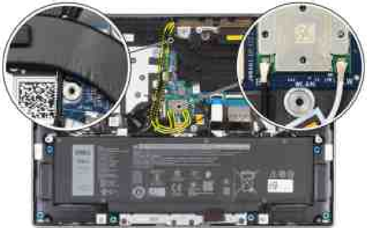
Abbildung 63. Installieren der WLAN-Antennenkabel
