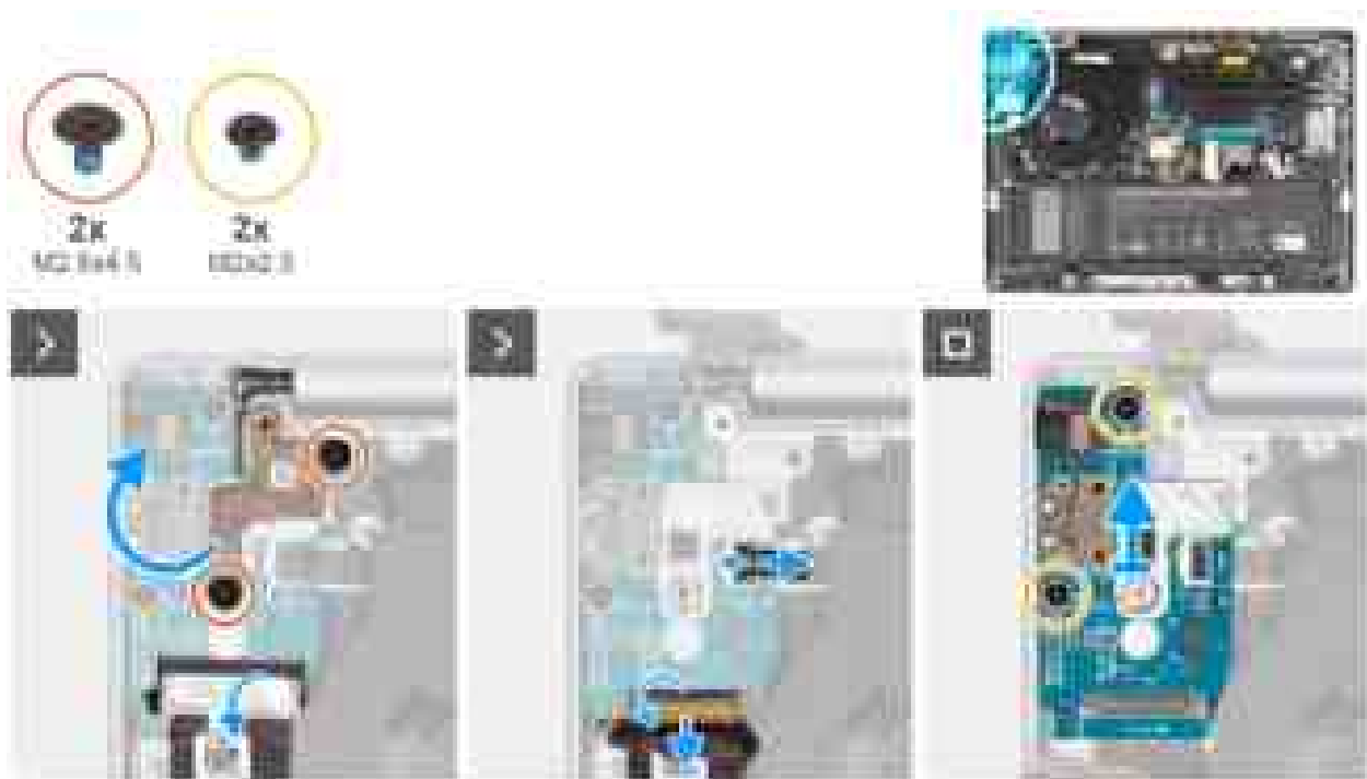
Abbildung 83. Entfernen der I/O-Platine (bei Computern nur mit WLAN-Unterstützung)
