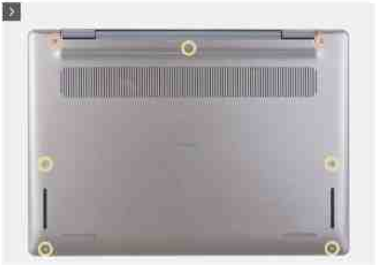
Abbildung 16. Entfernen der Bodenabdeckung
