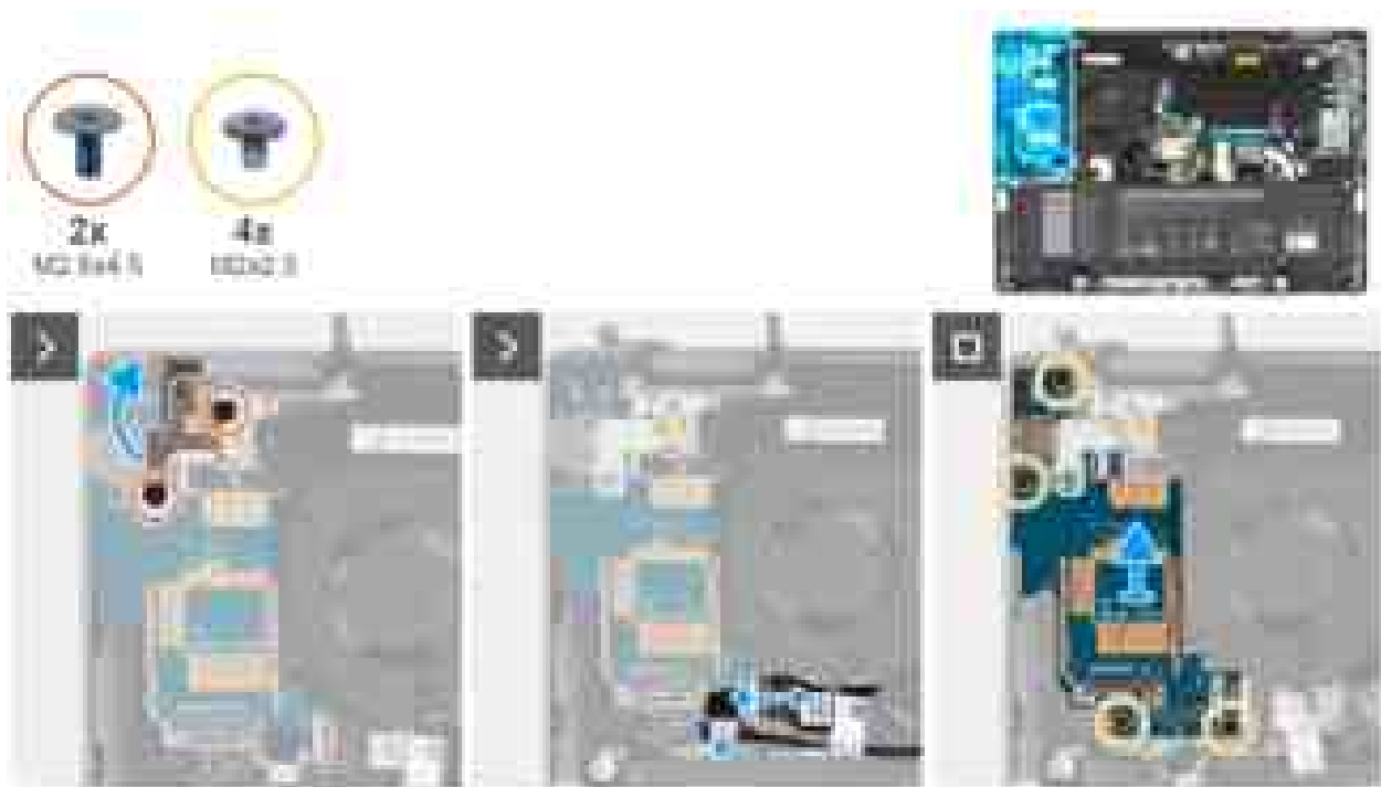
Abbildung 85. Entfernen der I/O-Platine (Computer mit WWAN-Unterstützung)
