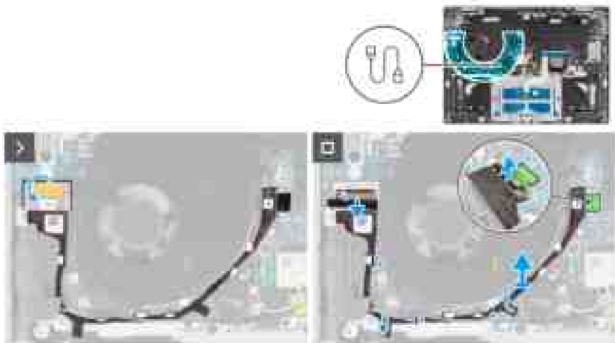
Abbildung 50. Entfernen des I/O-Platinenkabels (bei Computern mit WLAN-Unterstützung)
