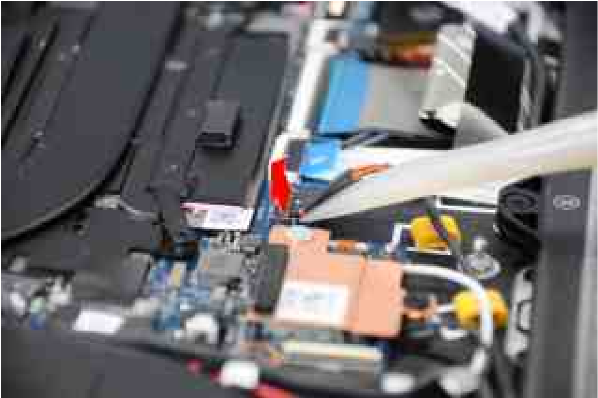
Abbildung 33. Hebeln Sie das Lautsprecherkabel vom Anschluss ab
