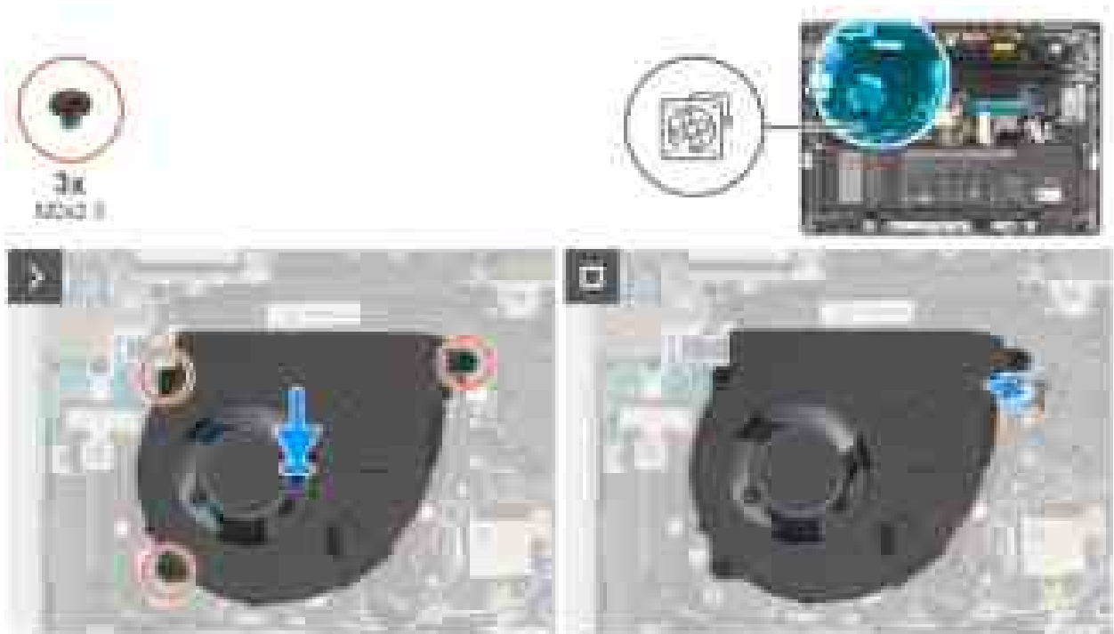
Abbildung 37. Installieren des Lüfters (bei Computern nur mit WLAN-Unterstützung)
