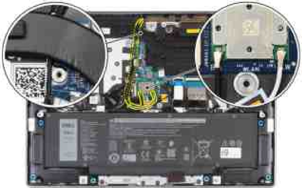
Abbildung 72. Installieren der WLAN-Antennenkabel
