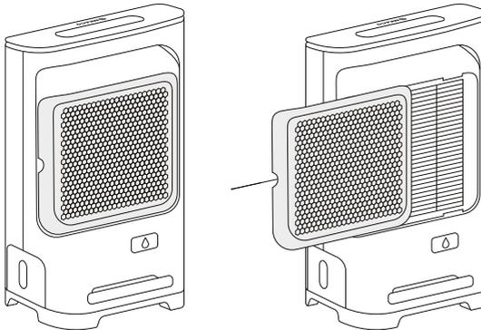
Der Staubfilter ist ein Filter mit langer Lebensdauer und sollte daher nicht ausgetauscht werden müssen (außer aus Verschleißgründen). Bei regelmäßigem Gebrauch kann sich der Filter mit Staub und Schmutzpartikeln zusetzen. Der Filter muss mindestens alle zwei Wochen gereinigt werden (andernfalls kann die Garantie für das Gerät erlöschen). Bitte befolgen Sie die nachstehenden Schritte.
