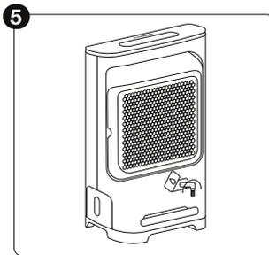
5 Setzen Sie das Verbindungsstück für den Schlauch vollständig ein und drehen Sie es dann, um es zu sichern (Sie können es nach links oder nach rechts drehen).
