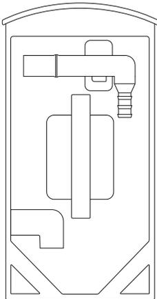
Im Inneren des Wasserbehälters befindet sich ein Schwimmer. Es ist wichtig, dass der Schwimmer NICHT aus dem Wasserbehälter entfernt wird. Der Schwimmer misst den Wasserstand im Wasserbehälter und veranlasst den Sensor, den Luftentfeuchter auszuschalten, wenn der Wasserbehälter voll ist. Wenn sich der Schwimmer nicht in dem Wasserbehälter befindet, läuft der Luftentfeuchter nicht.
