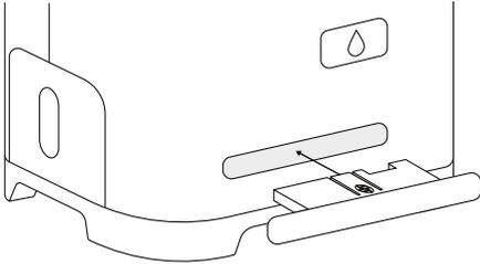
Befestigen Sie die Kabelaufwicklung an der unteren Rückseite des Luftentfeuchters. Achten Sie darauf, dass sie richtig herum eingesetzt ist und die Aussparung nach oben gerichtet ist.
