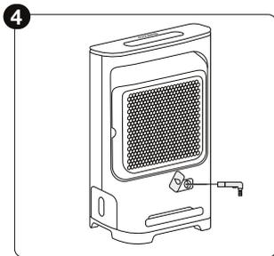
4 Öffnen Sie die schwarze Dichtung auf der Rückseite des Luftentfeuchters und setzen Sie das Verbindungsstück für den Schlauch ein.
