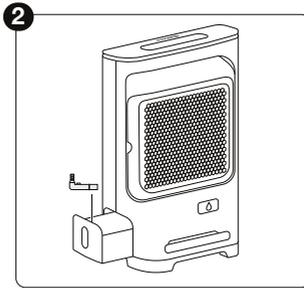
2 Entfernen Sie das Verbindungsstück für den Schlauch vom Deckel des Wassertanks.
