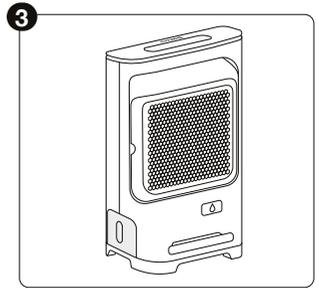
3 Setzen Sie den Wasserbehälter wieder in den Luftentfeuchter ein.
