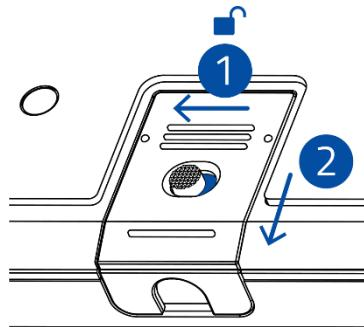
2. Hebe den Kabelclip an und verbinde das Kabel (USB Typ C auf USB Typ A) mit dem USB Typ-C-Anschluss des Arcade-Controllers.
