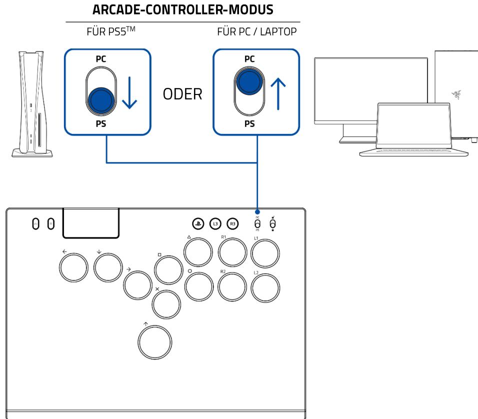
2. Verbinde den Controller mit PS5™ oder PC per USB-Kabel (Typ A auf Typ C).
