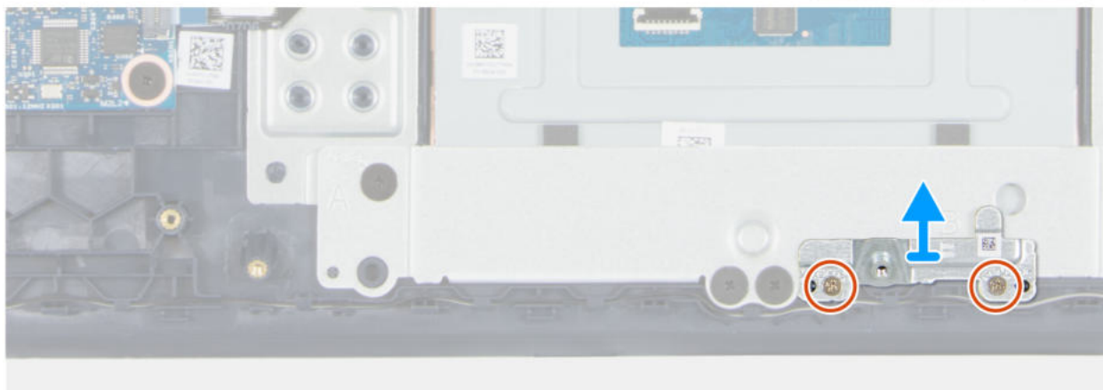
Abbildung 42. Entfernen der Akkualterung
