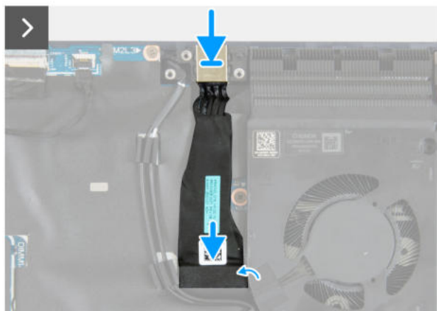
Abbildung 39. Einbauen des Netzadapteranschlusses
