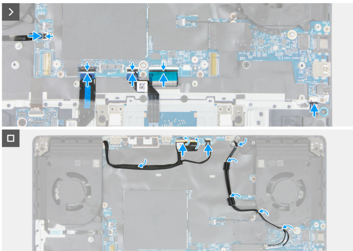
Abbildung 57. Einbauen der Systemplatine
