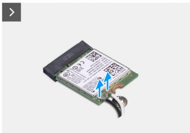
Abbildung 34. Entfernen der Wireless-Karte
