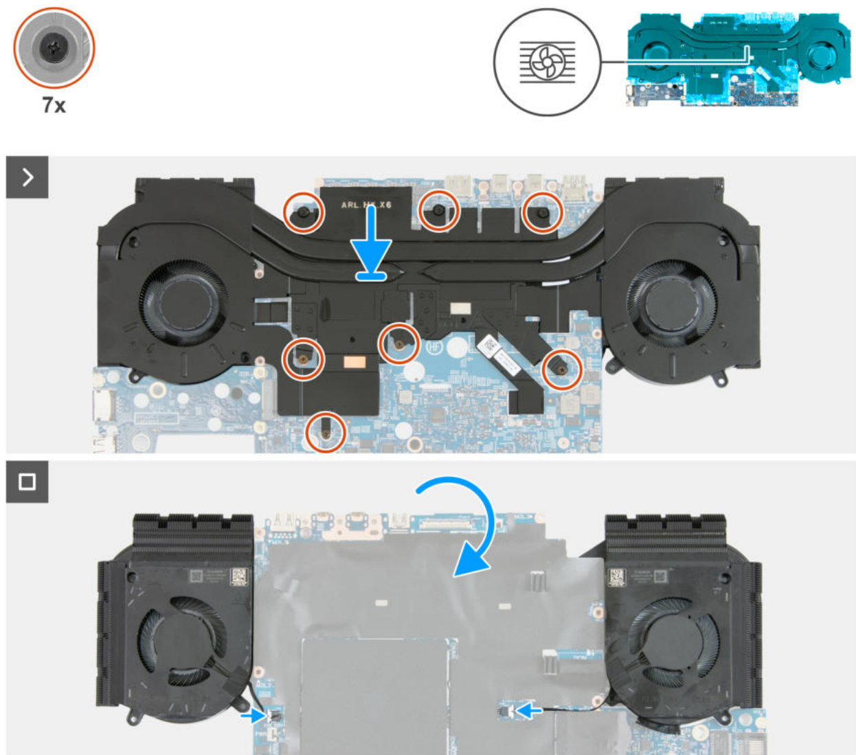
Abbildung 62. Installieren der Lüfter- und Kühlkörperbaugruppe
