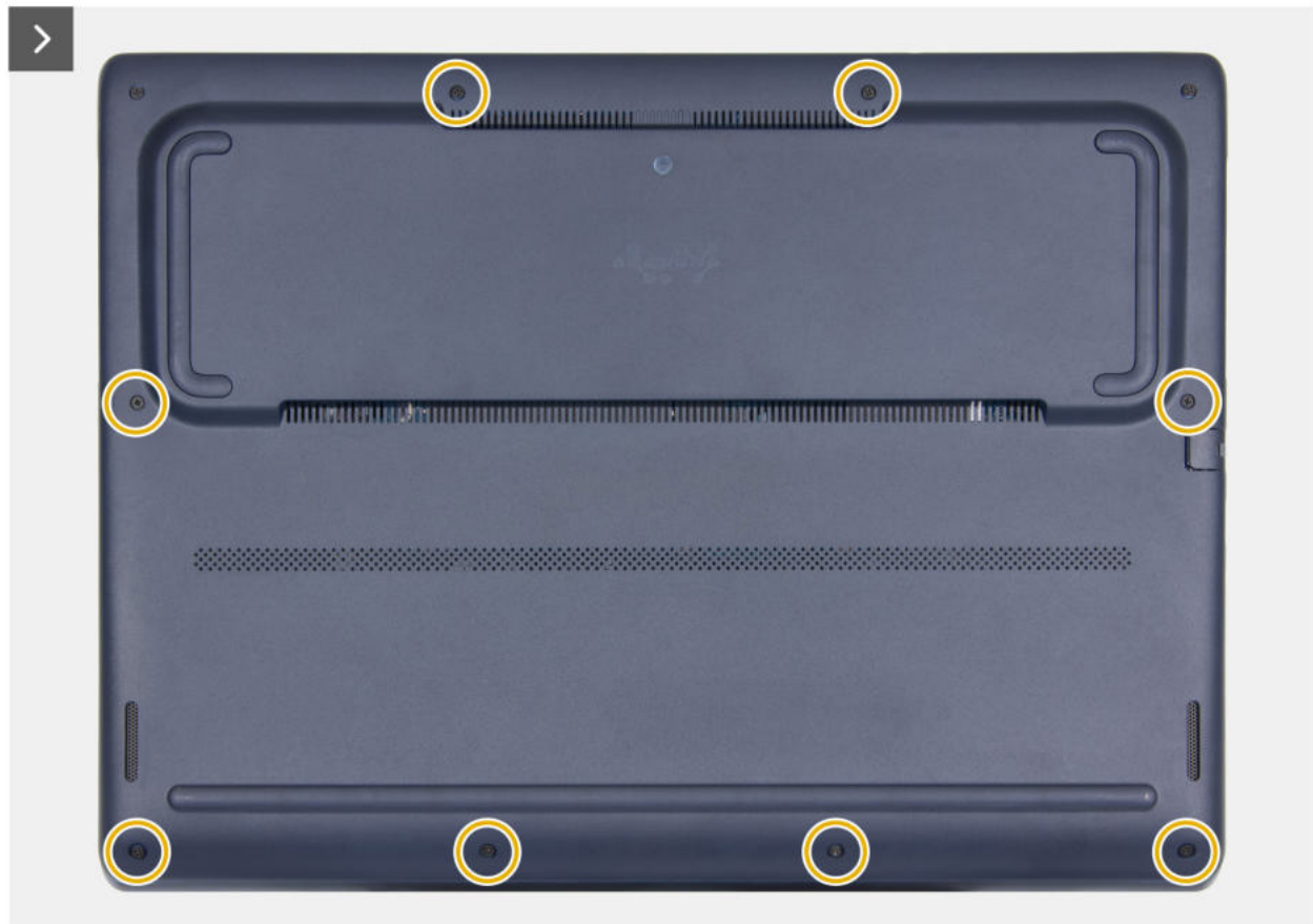
Abbildung 10. Entfernen der acht Schrauben an der Bodenabdeckung
