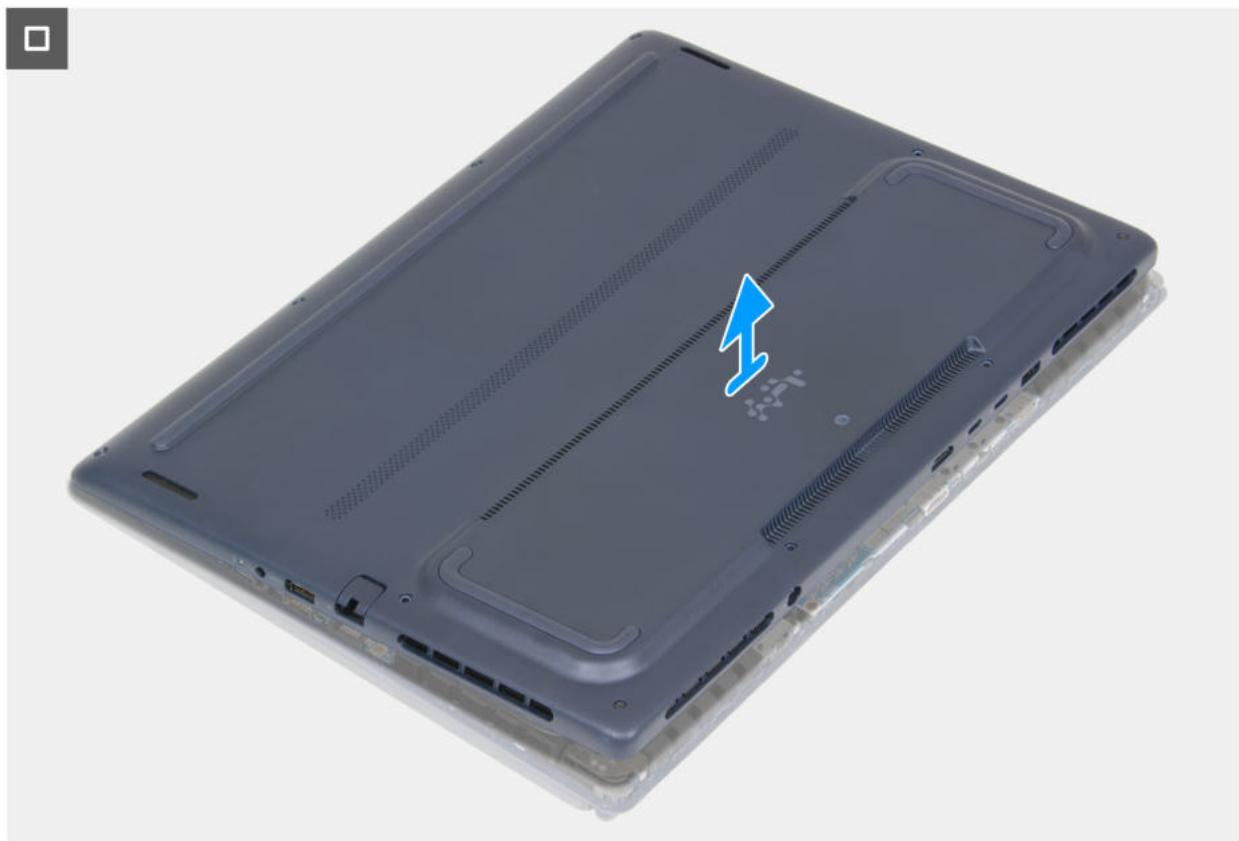
Abbildung 13. Entfernen der Bodenabdeckung
