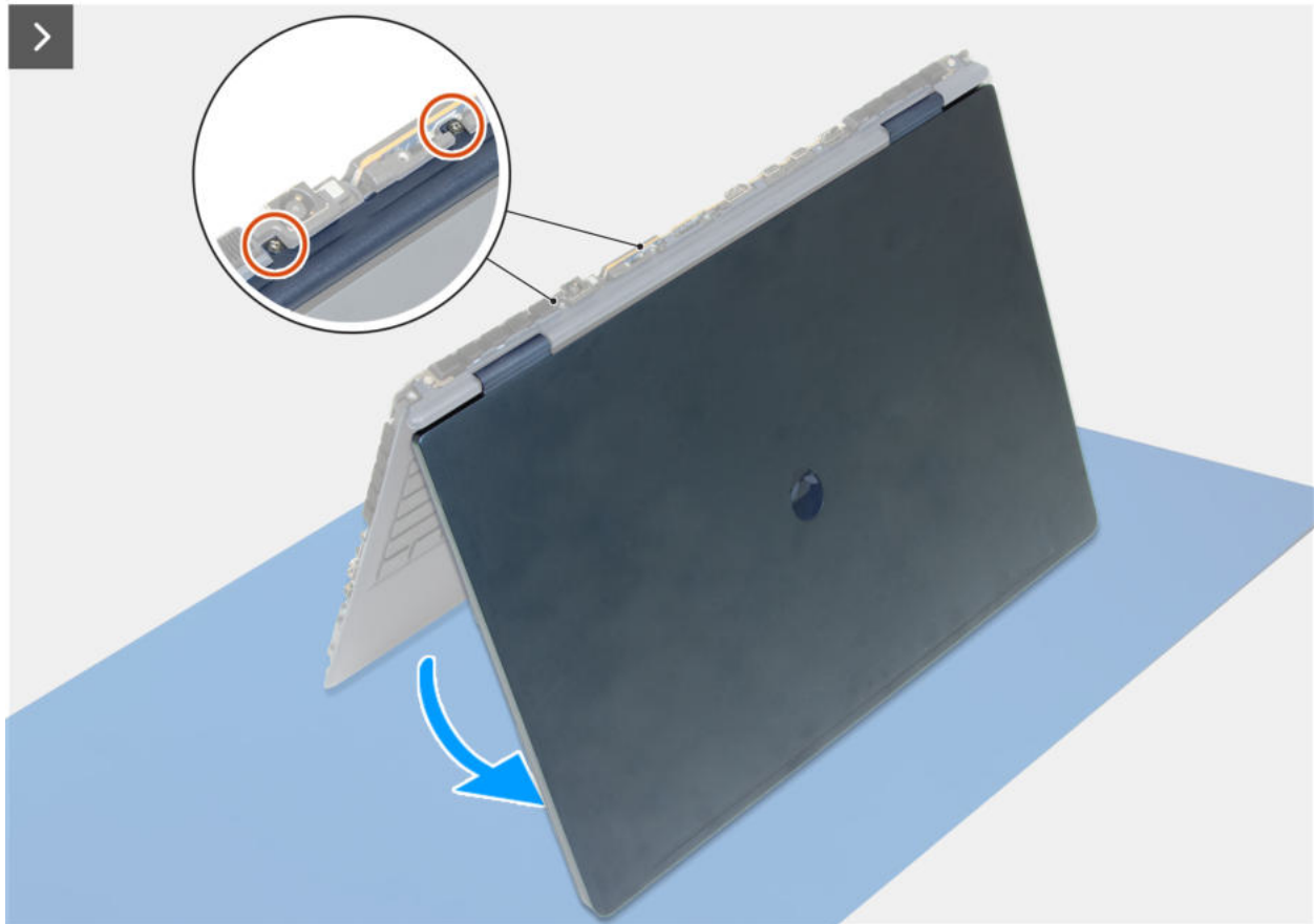
Abbildung 68. Entfernen der Mittelleiste
