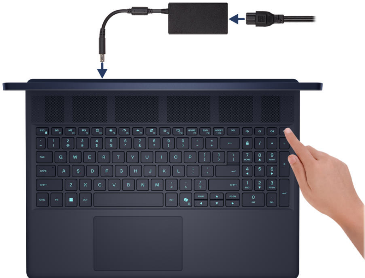
Abbildung 8. Anschließen des Netzteils und Drücken des Netzschalters
