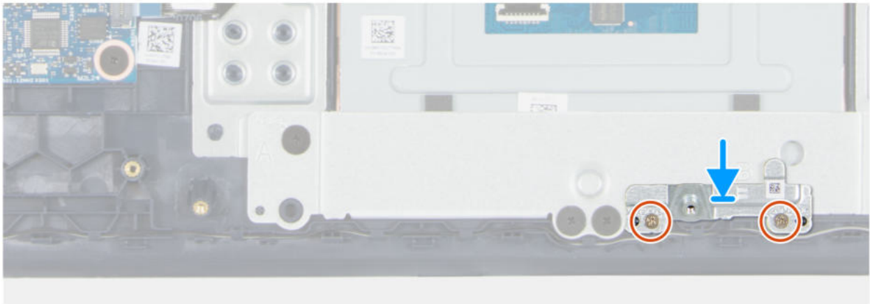
Abbildung 43. Installieren der Akkuhalterung
