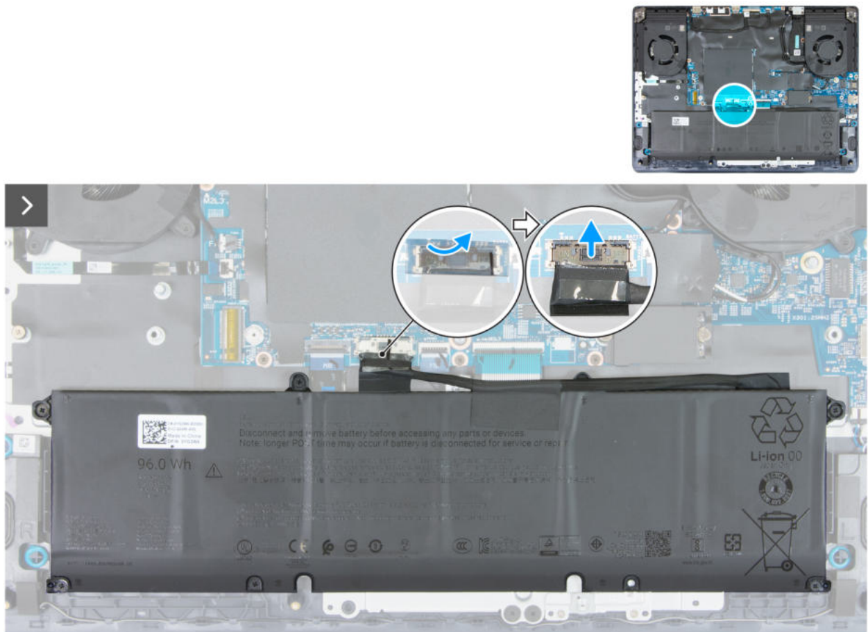
Abbildung 14. Trennen des Akkukabels
