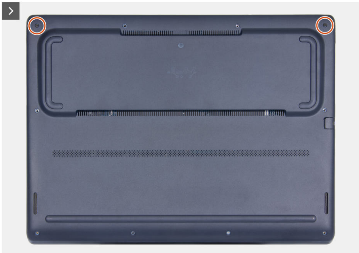
Abbildung 11. Lösen der unverlierbaren Schrauben an der Bodenabdeckung
