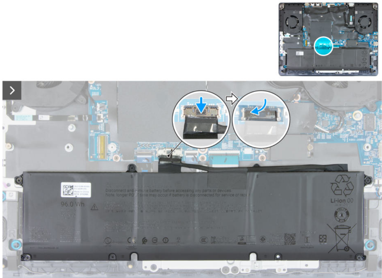
Abbildung 15. Verbinden des Akkukabels
