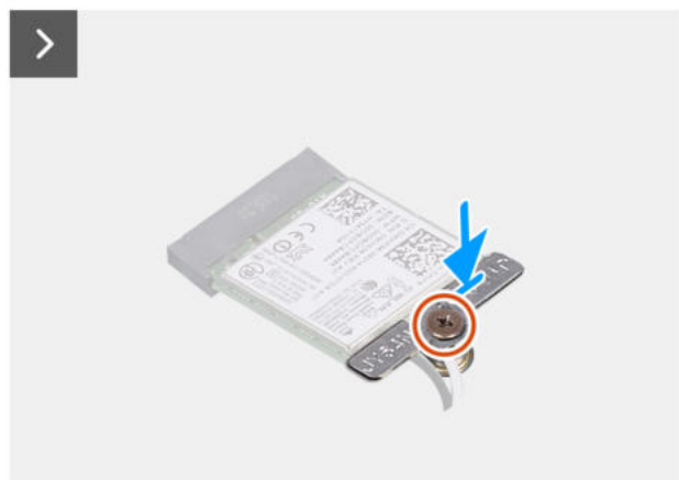
Abbildung 35. Installieren der Wireless-Karte
