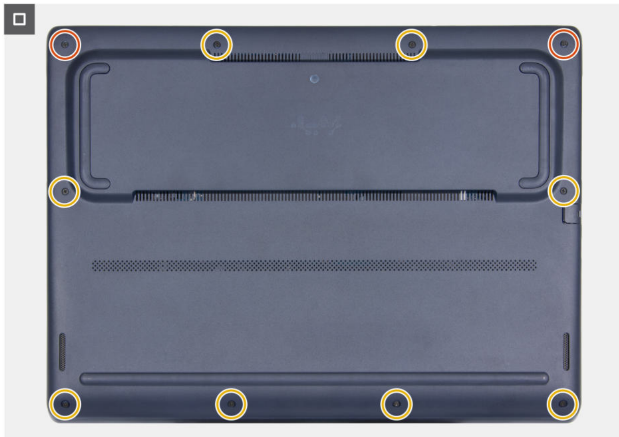
Abbildung 17. Anbringen der Bodenabdeckung
