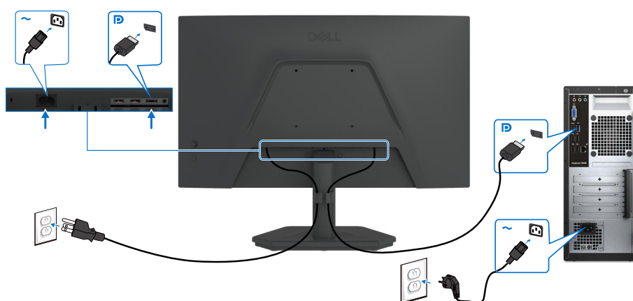
Figure 15. Branchement du câble DisplayPort
