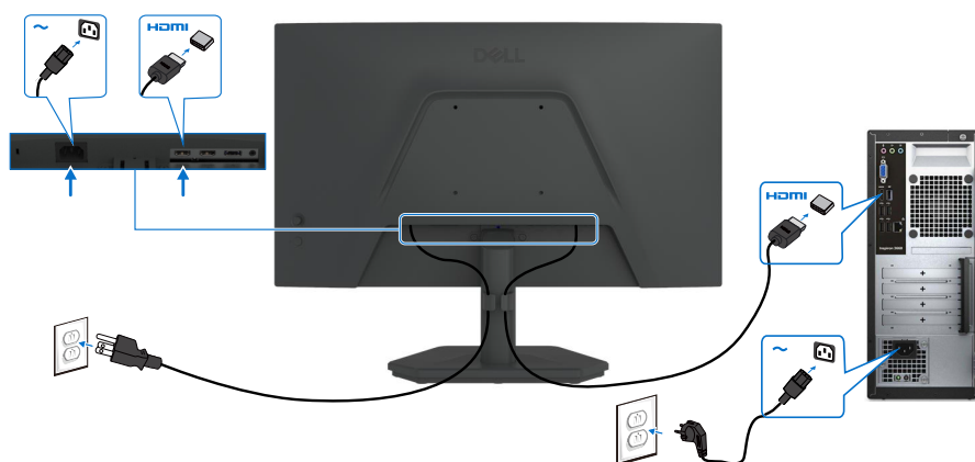
Figure 14. Branchement du câble HDMI
