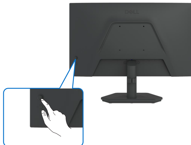
Figure 20. Utilisation du joystick
