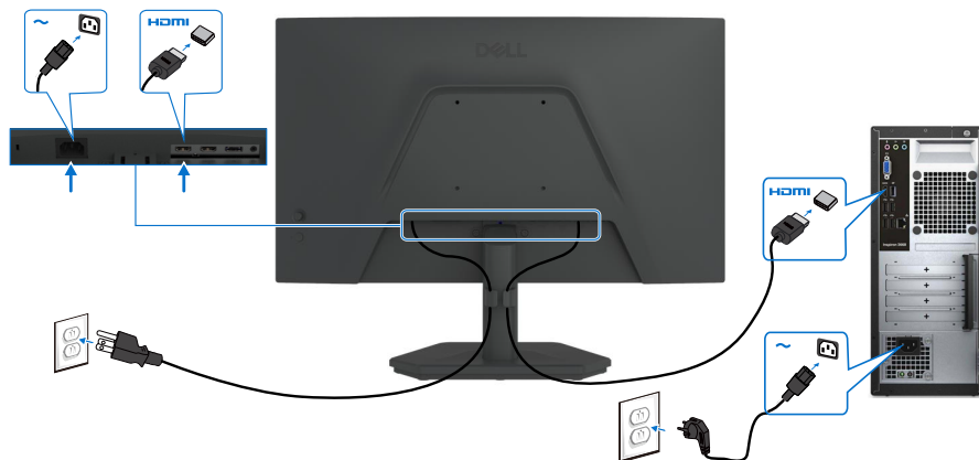
Abbildung 14. Anschließen des HDMI-Kabels
