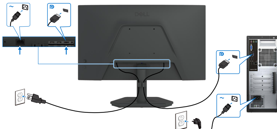
Abbildung 15. Anschließen des DisplayPort-Kabels
