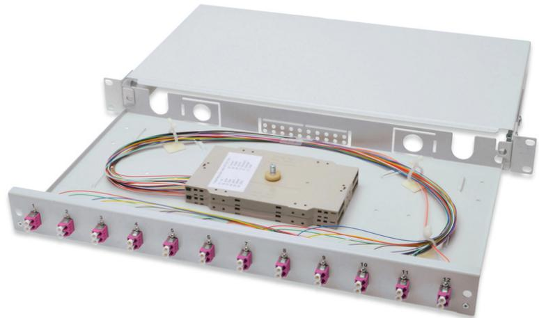
**LWL Spleißbox, 1HE, bestückt, 12x LC DX, OM4 inkl. Spleißkassette, gefärbte Pigtails, Kupplungen**
