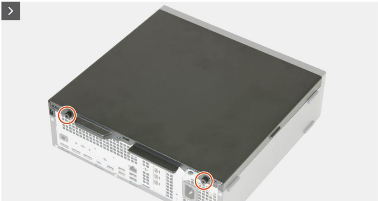
Abbildung 6. Entfernen der Seitenabdeckung
