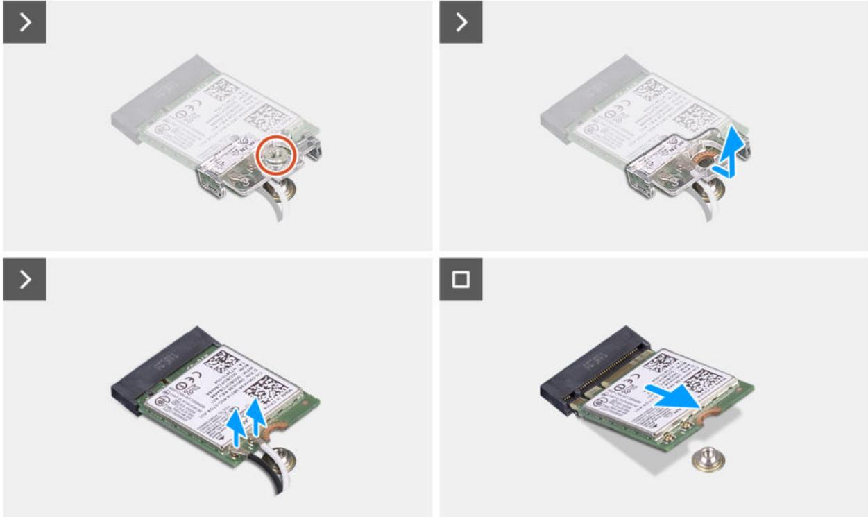
Abbildung 35. Entfernen der Wireless-Karte
