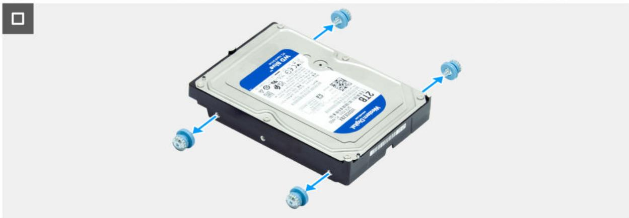
Abbildung 53. Entfernen der Festplatte
