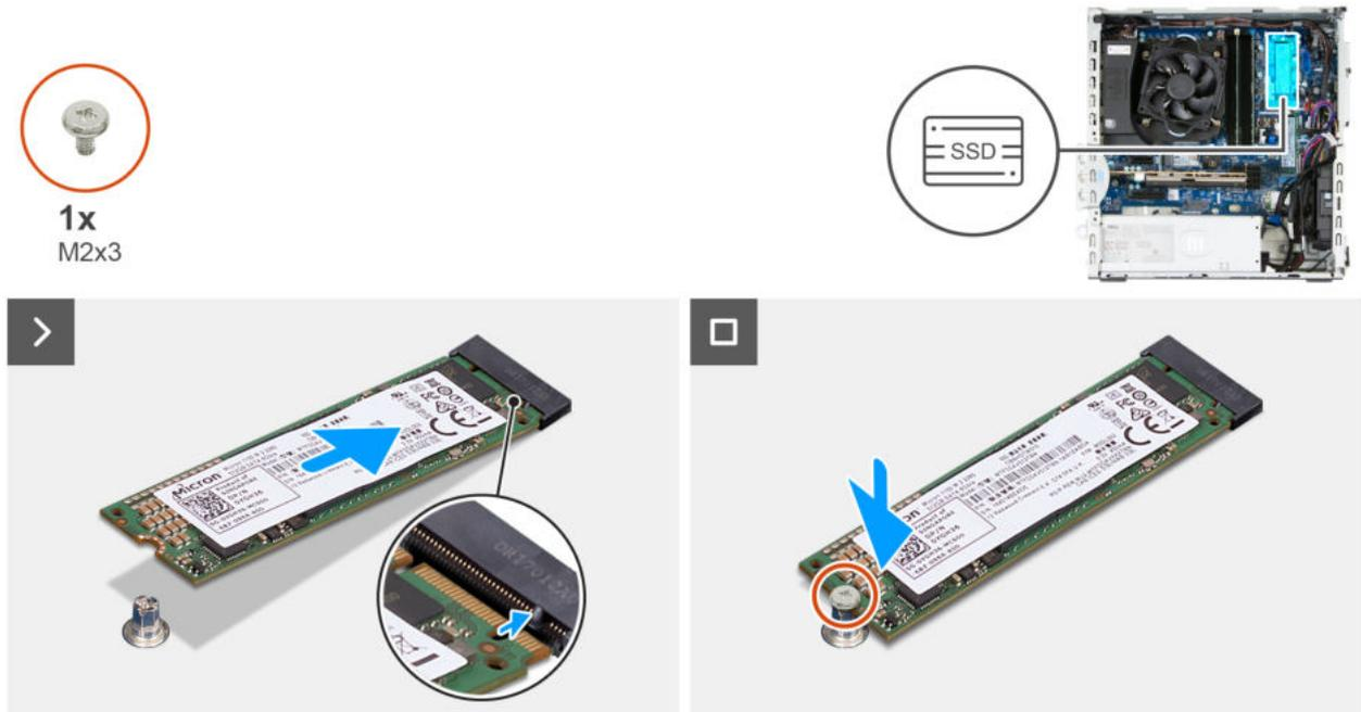
**Abbildung 32. Installieren des M.2 2280-SSD-Laufwerks in Steckplatz 2**
