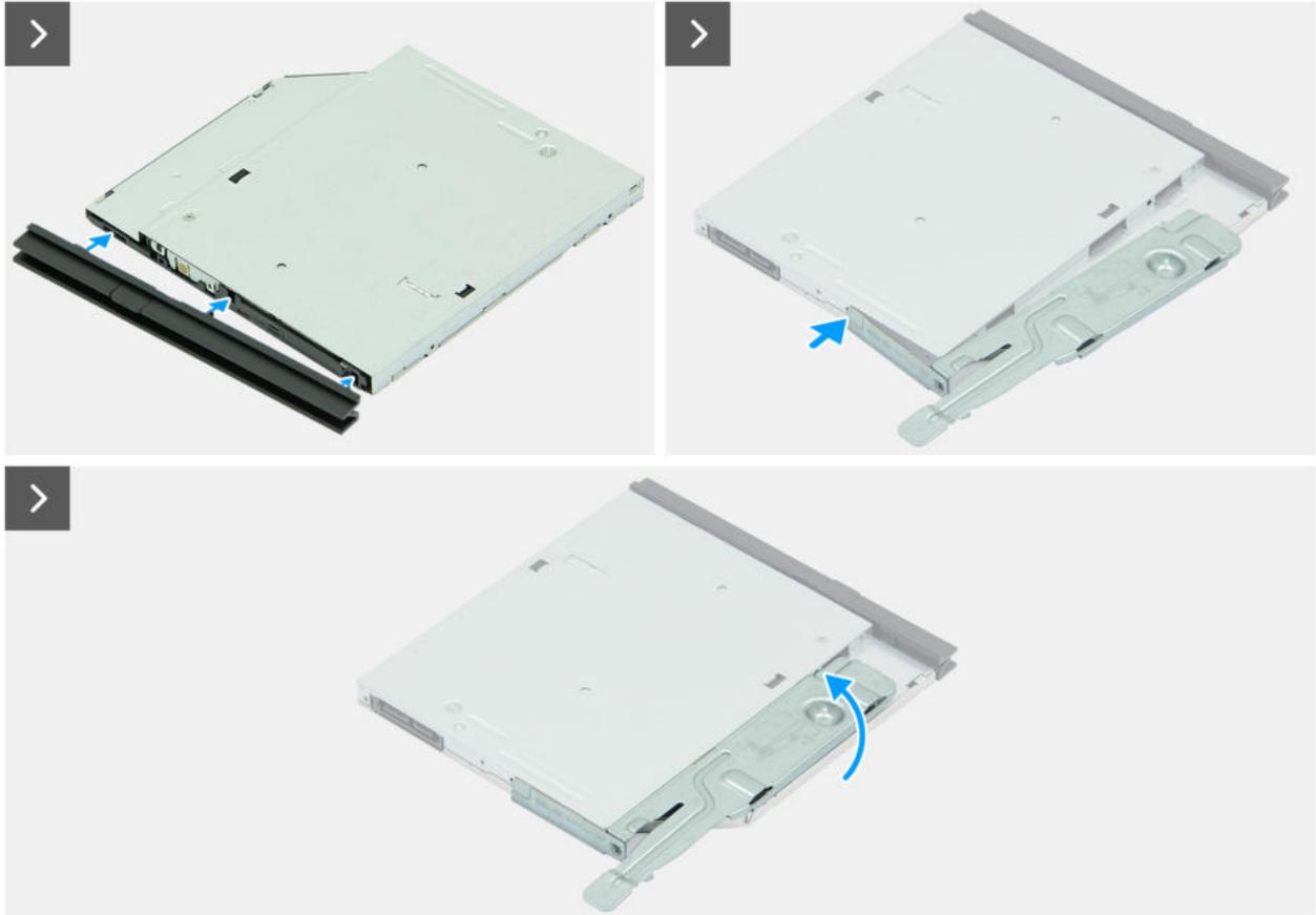
Abbildung 47. Installieren des optischen Laufwerks
