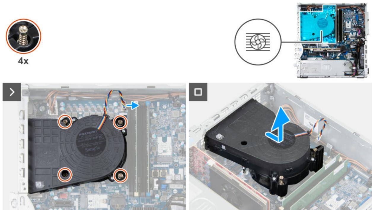
Abbildung 80. Entfernen der Prozessorlüfter- und Kühlkörperbaugruppe (Dell Pro Slim Plus QBS1250)
