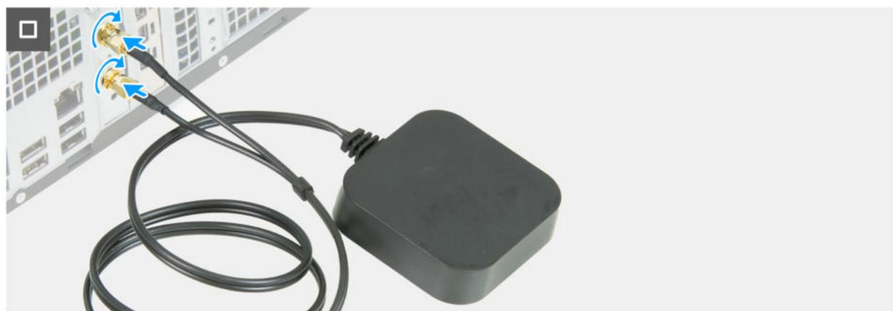
Abbildung 44. Installieren der Puck-Antennen-Erweiterungskarte
