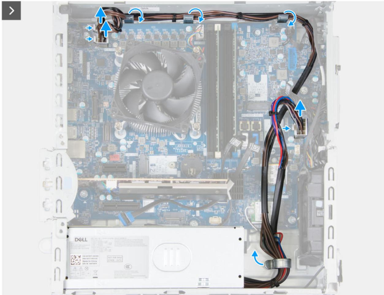
Abbildung 76. Installieren der Stromversorgungseinheit
