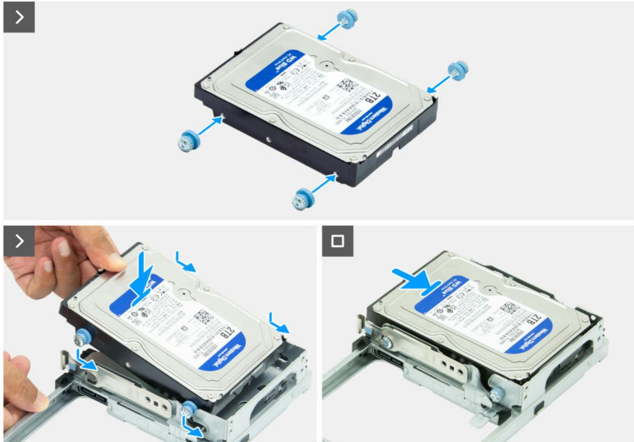
Abbildung 54. Einsetzen des Festplattenlaufwerks
