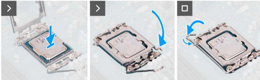
Abbildung 85. Einbauen des Prozessors
