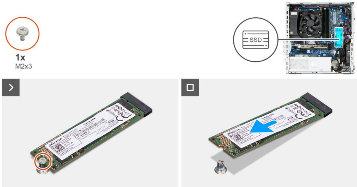
Abbildung 24. Entfernen des M.2 2280-SSD-Laufwerks aus Steckplatz 0
