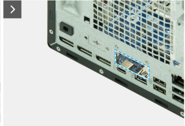
Abbildung 65. Installieren des optionalen Anschlussmoduls
