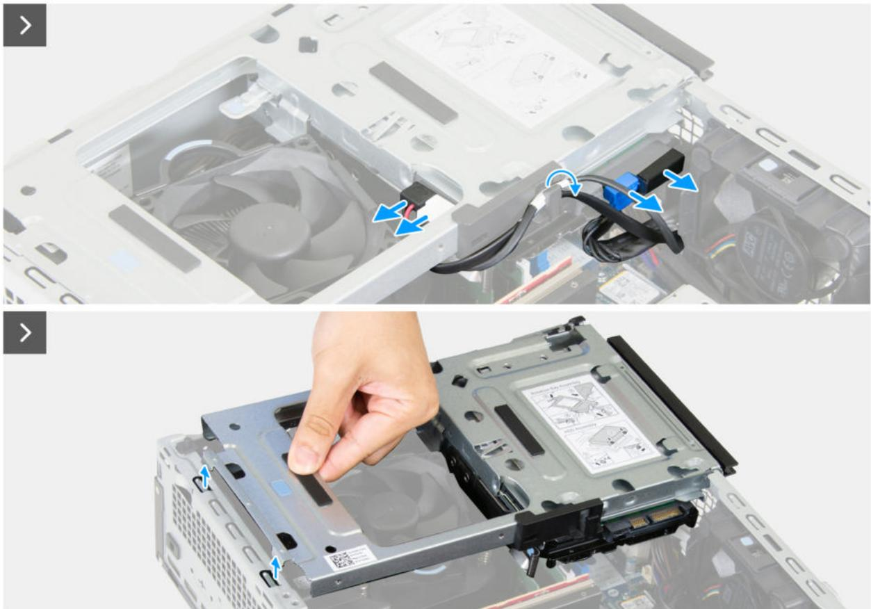
Abbildung 49. Entfernen des Laufwerksschachts
