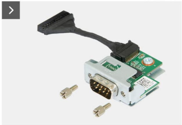
Abbildung 70. Installieren des seriellen Anschlussmoduls
