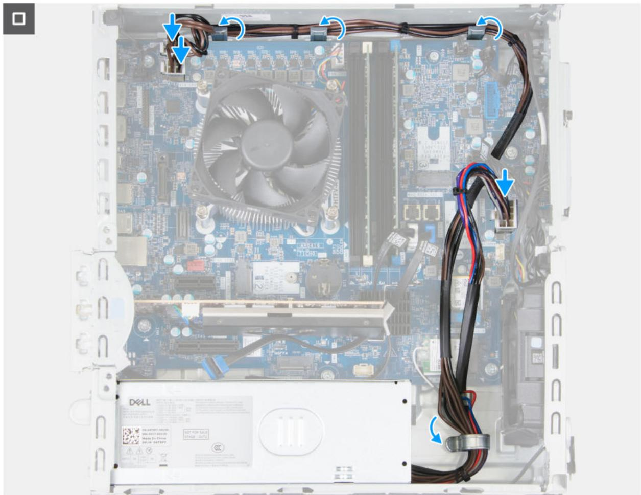
**Abbildung 79. Installieren der Stromversorgungseinheit**
