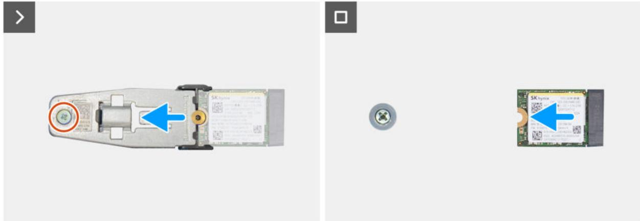
Abbildung 29. Entfernen des M.2 2230-SSD-Laufwerks aus Steckplatz 2
