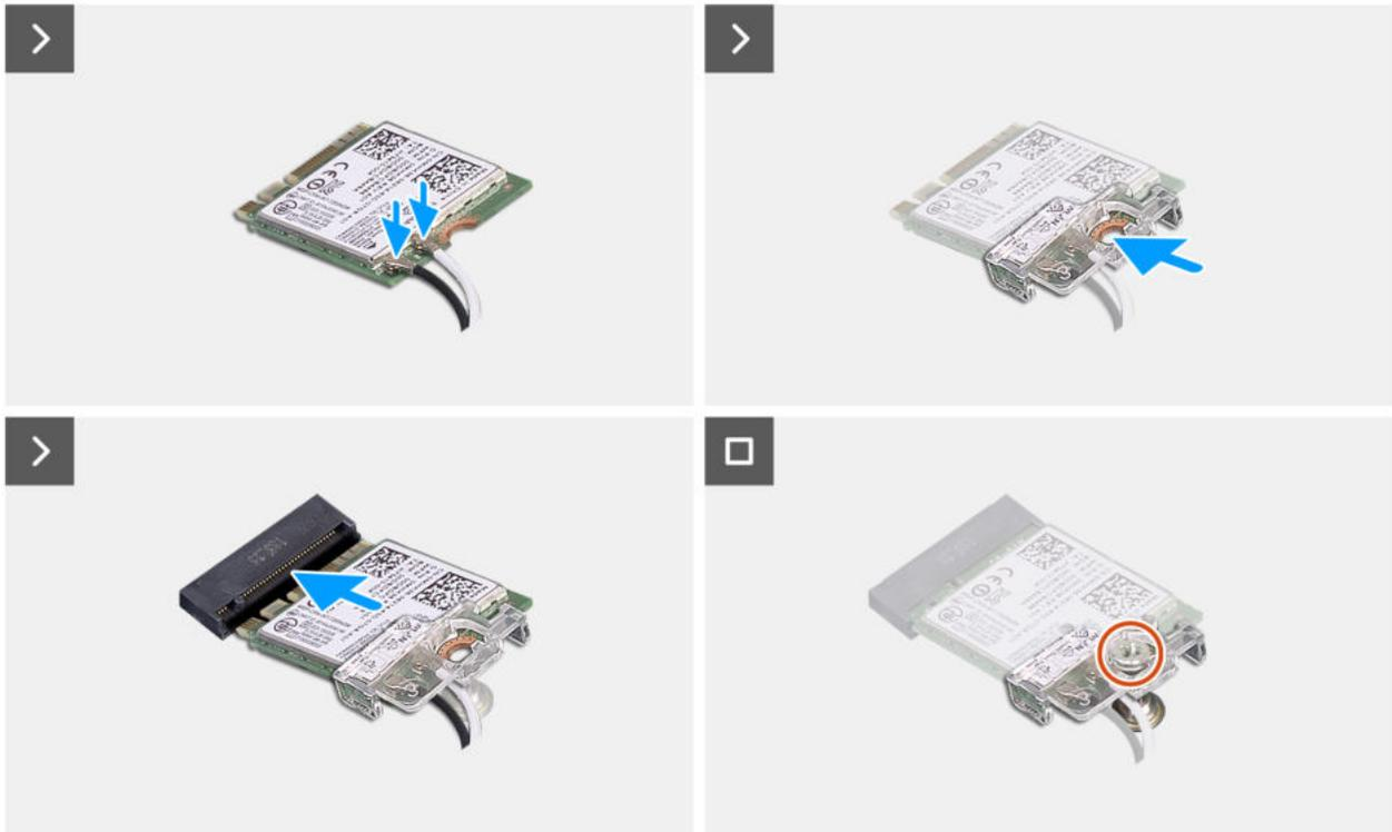
Abbildung 36. Installieren der Wireless-Karte
