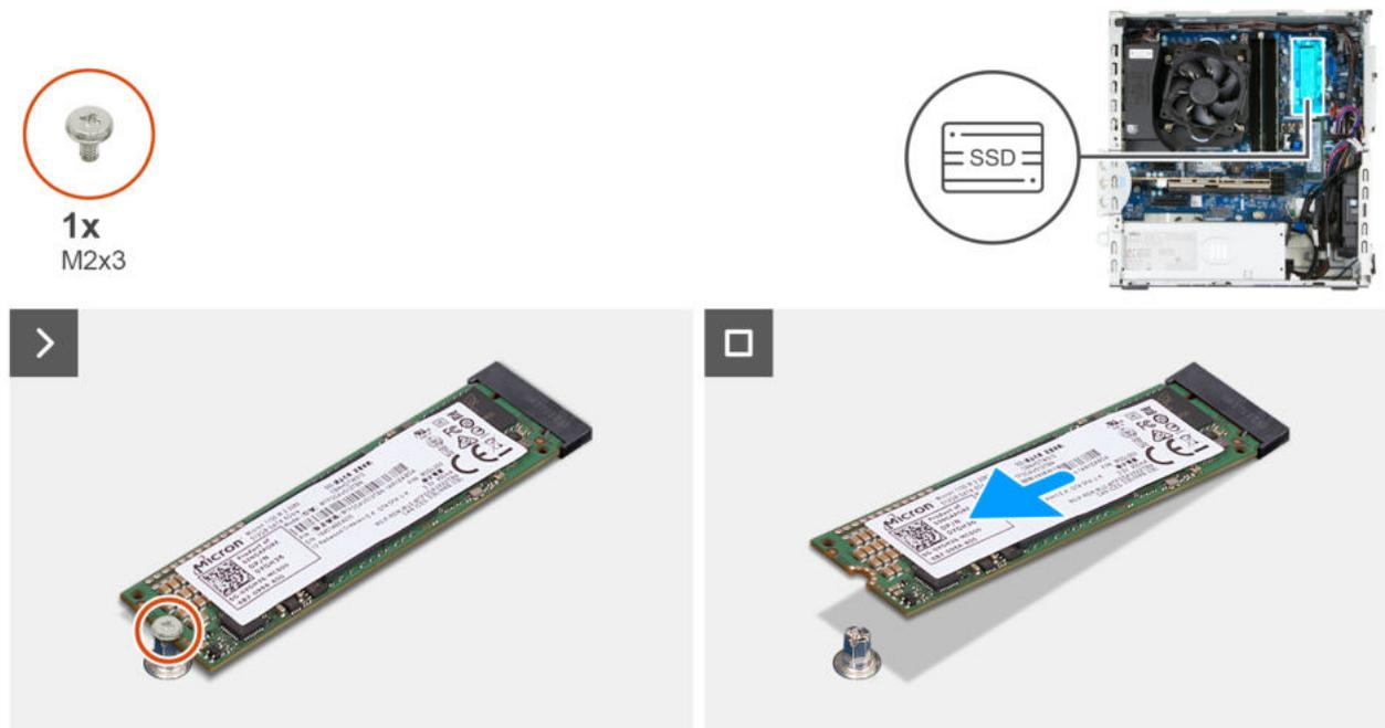
Abbildung 31. Entfernen des M.2 2280-Solid-State-Laufwerks aus Steckplatz 2
