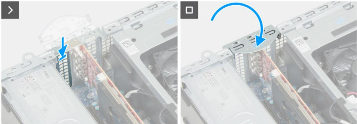
**Abbildung 38. Entfernen der Solid-State-Laufwerk-Erweiterungskarte**
