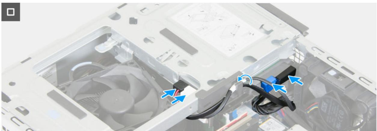
Abbildung 52. Installieren des Laufwerksschachts
