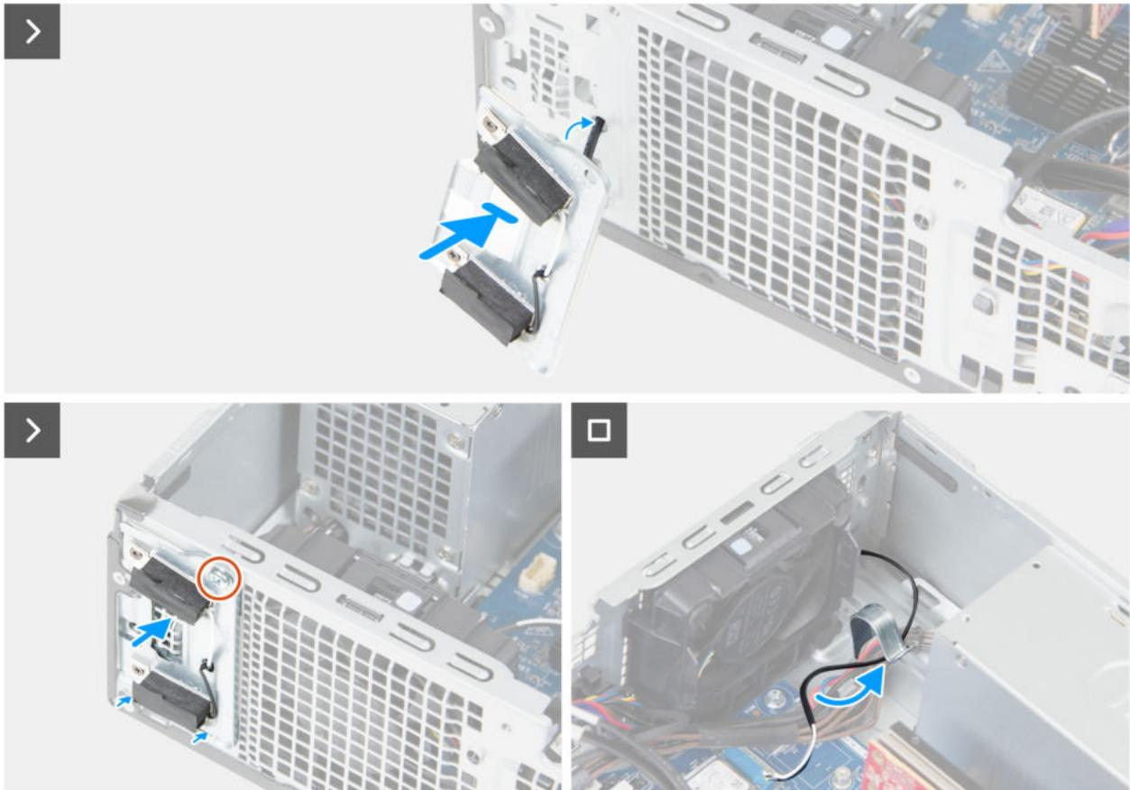
Abbildung 75. Einbauen der Antennenmodule
