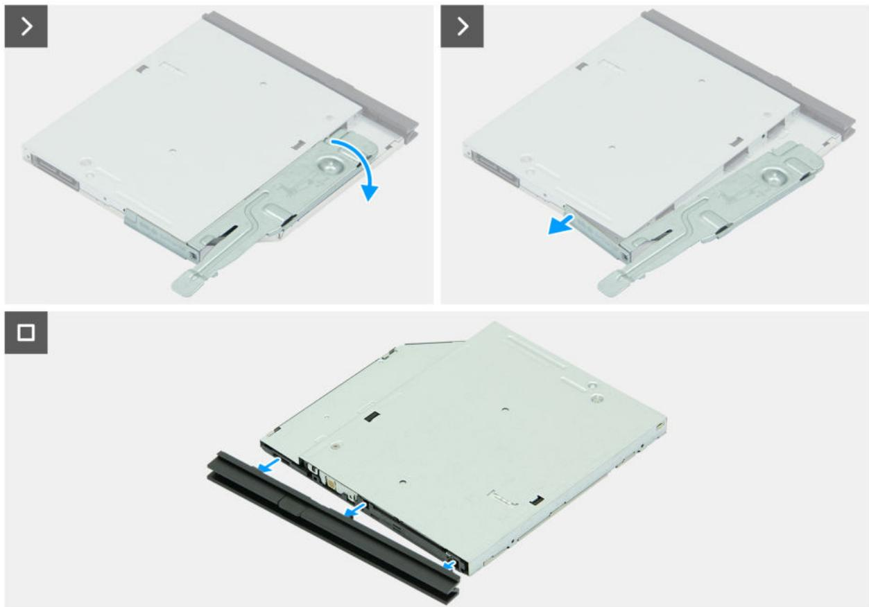
Abbildung 46. Entfernen des optischen Laufwerks
