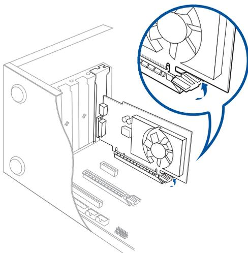
6. Verwenden Sie einen Schraubendreher und eine Schraube, um die Grafikkarte am Gehäuse zu fixieren.
