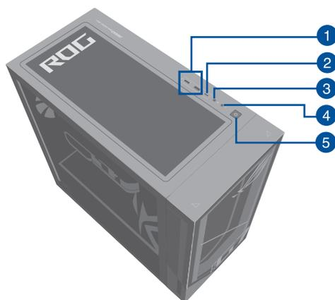
1. **USB 3.2 (Gen1)-Anschlüsse.** Die Universal Serial Bus 3.2 (Gen1) (USB 3.2 Gen1)-Anschlüsse sind kompatibel mit USB 3.2 (Gen1)-Geräten wie Mäusen, Druckern, Scannern, Kameras, PDAs und anderen.
