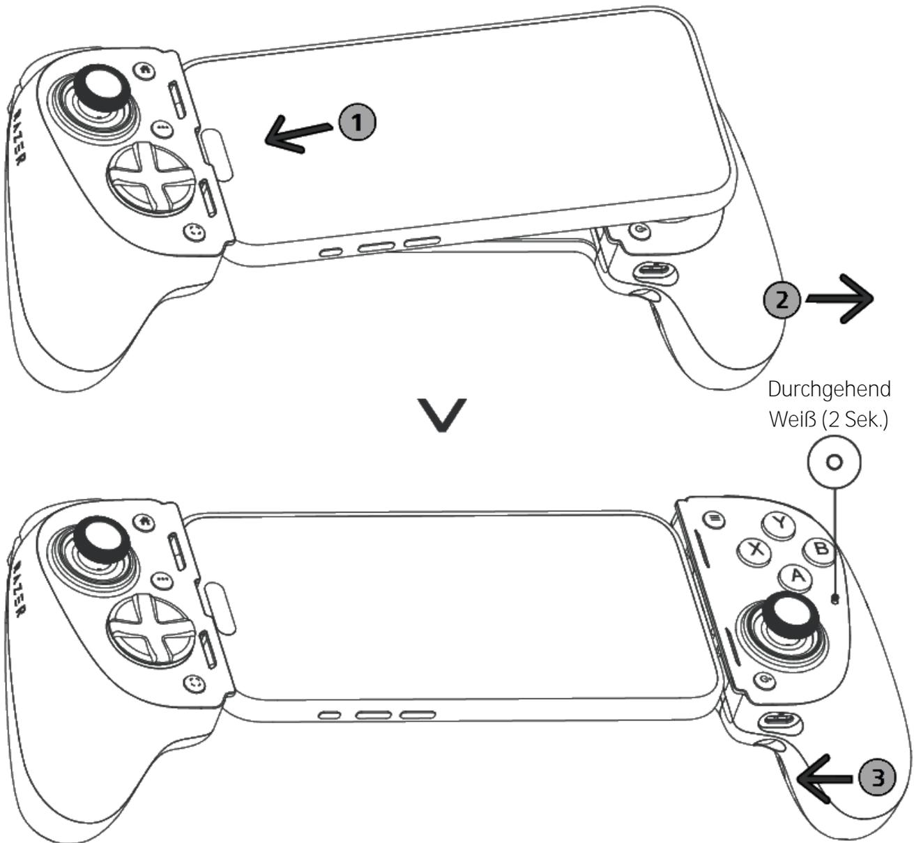
**i** Maximal unterstützte Abmessungen: 12,32 mm (Dicke, inklusive Kamera) x 208,9 mm (Länge).
