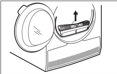
2. Öffnen Sie die Kondensatorabdeckung.
