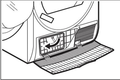
4. Klappen Sie den Kondensatordeckel nach unten.
