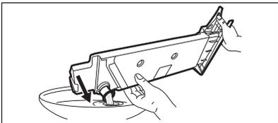
3. Drücken Sie die Kunststoffverbindung wieder ein und setzen Sie den Wasserbehälter wieder in das Gerät.
