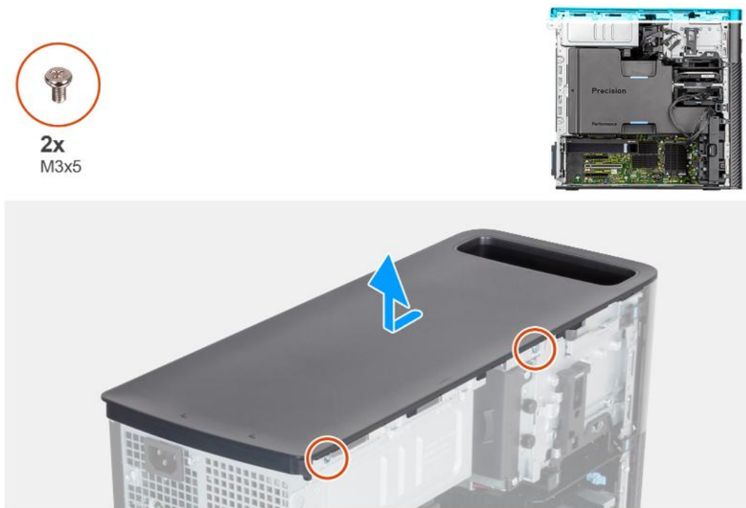
Abbildung 3. Entfernen der oberen Abdeckung
