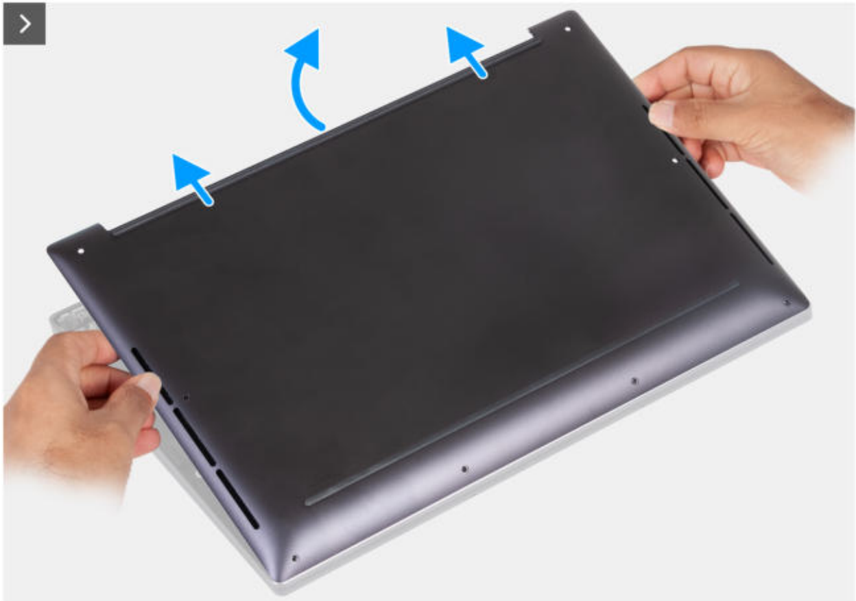
Abbildung 3. Abheben der Bodenabdeckung von der Handauflagenbaugruppe
