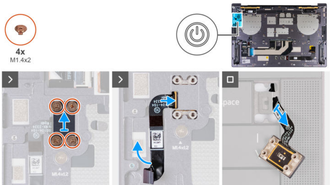
Abbildung 30. Entfernen des Netzschalters mit Fingerabdruck-Lesegerät
