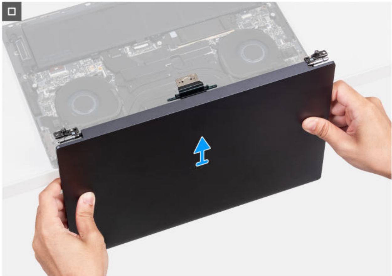
Abbildung 22. Einbauen der Bildschirmbaugruppe
