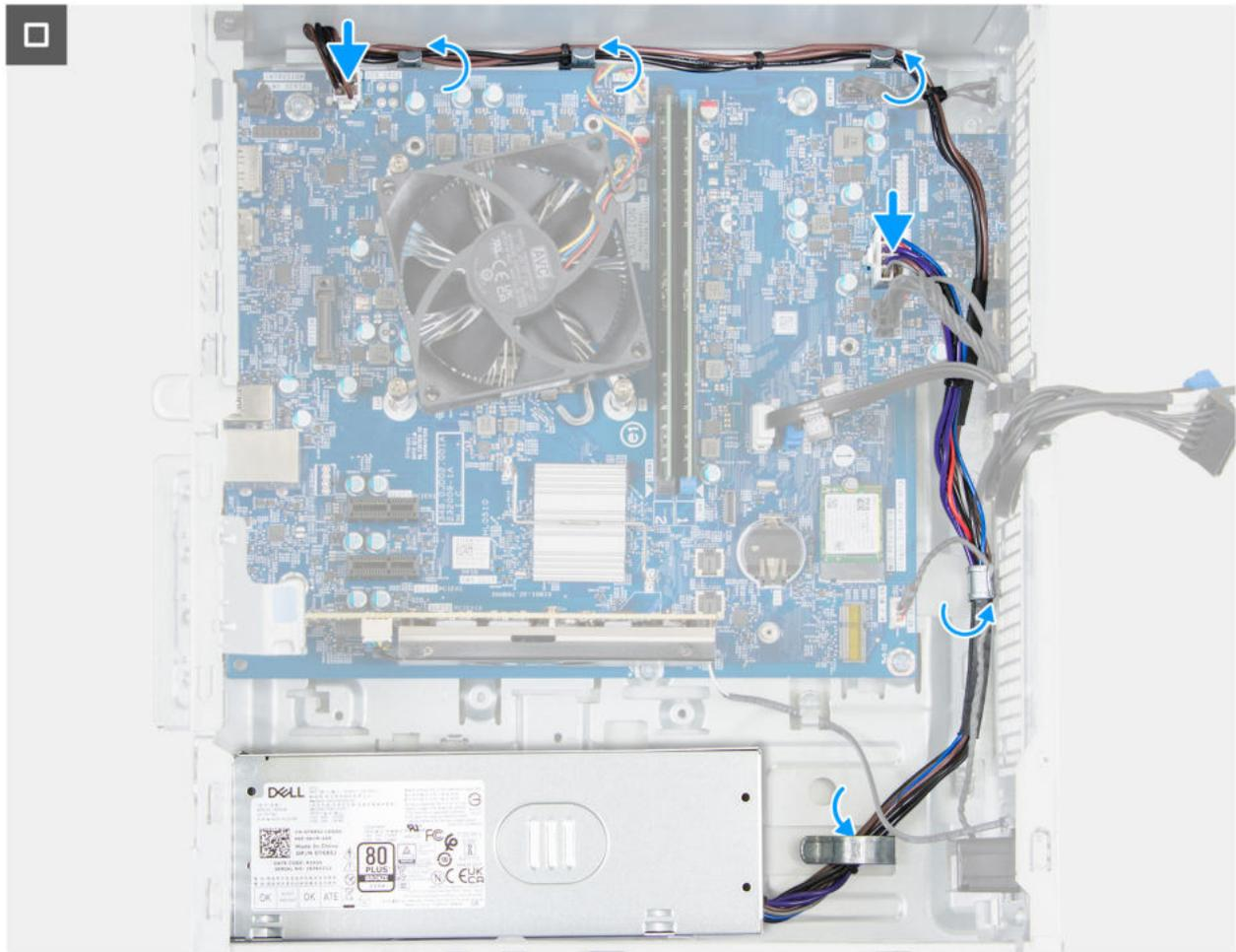
**Abbildung 64. Installieren der Stromversorgungseinheit**
