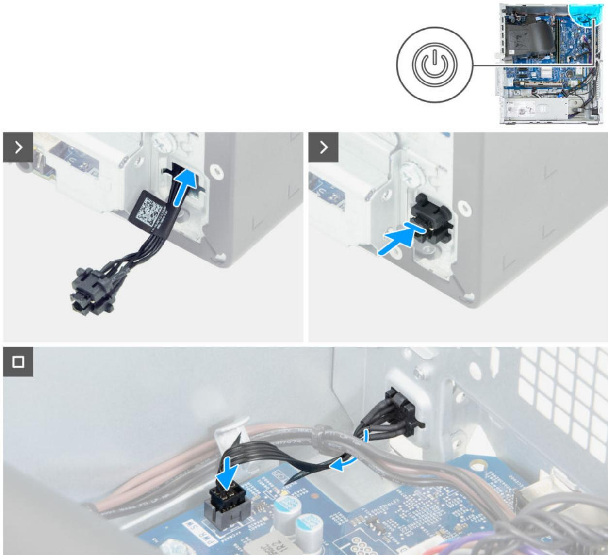
Abbildung 50. Installieren des Netzschalters
