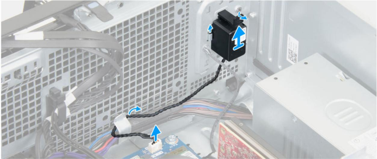
**Abbildung 24. Entfernen des internen Lautsprechers**
