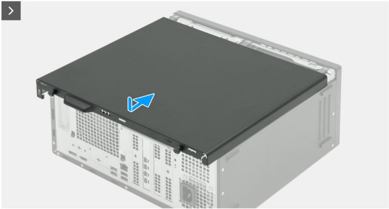
Abbildung 14. Installieren der linken Abdeckung
