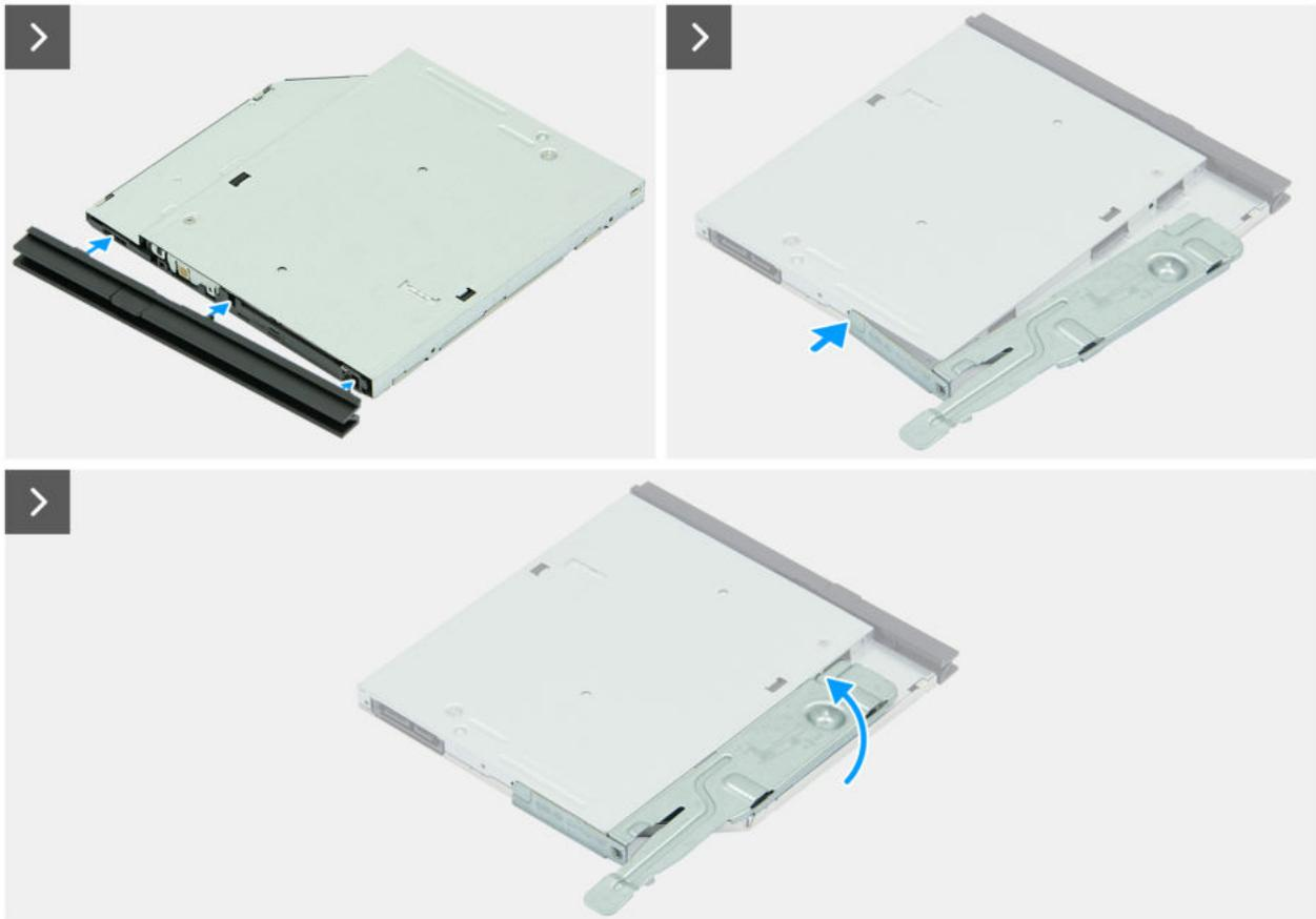
Abbildung 39. Installieren des optischen Laufwerks
