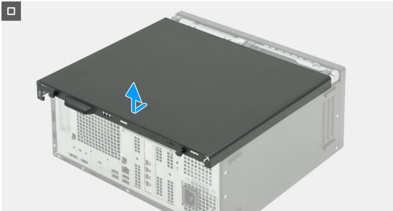
**Abbildung 13. Entfernen der linken Abdeckung**
