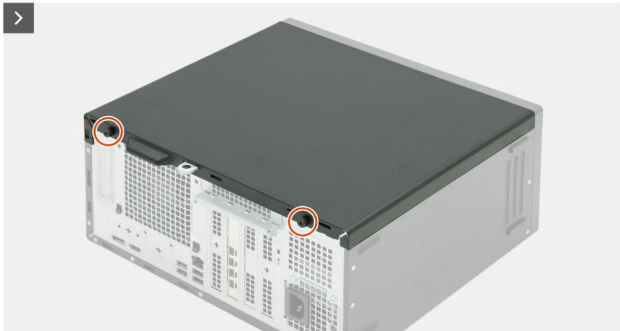
Abbildung 12. Entfernen der linken Abdeckung
