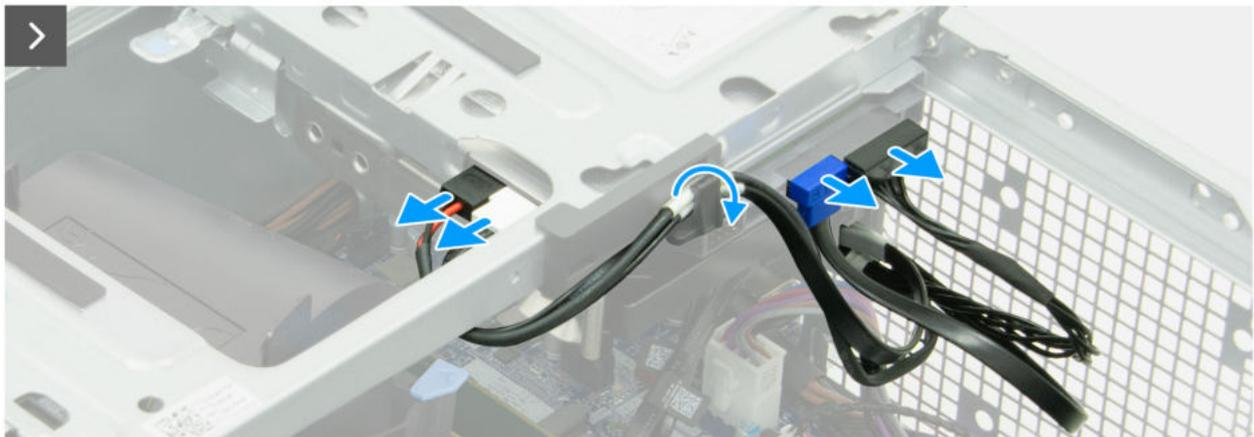
Abbildung 41. Entfernen des Laufwerksschachts
