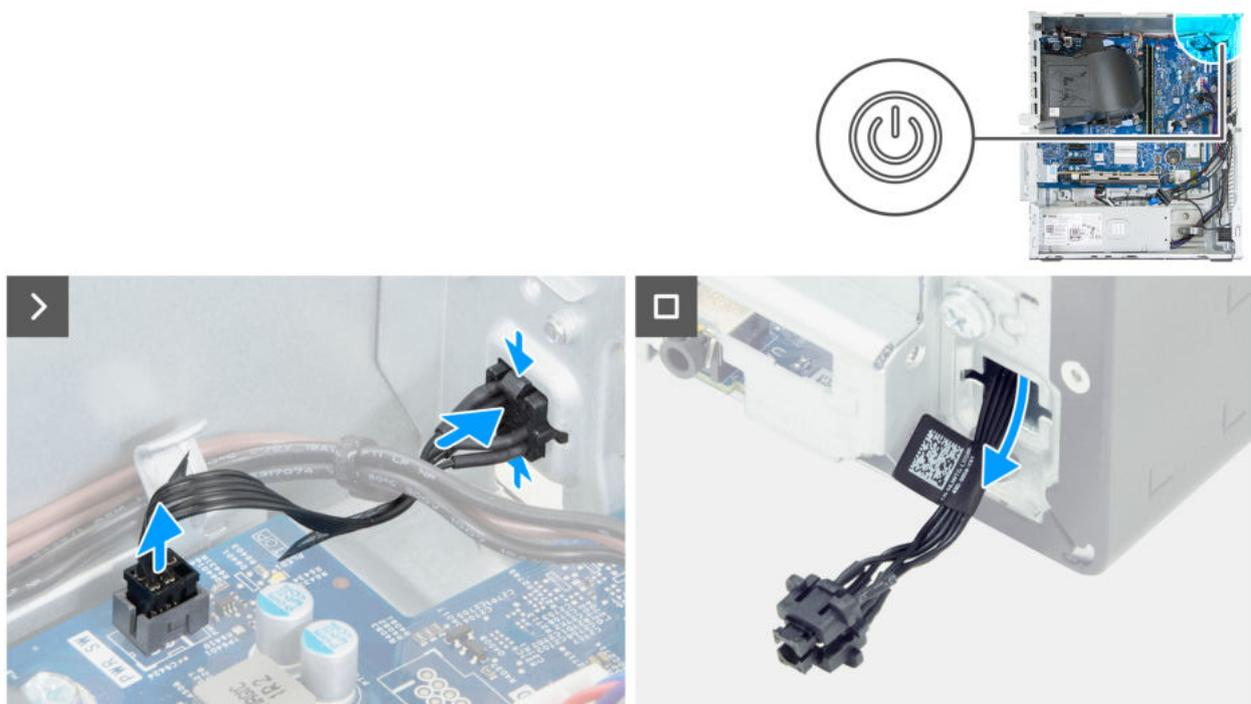
Abbildung 49. Entfernen des Netzschalters
