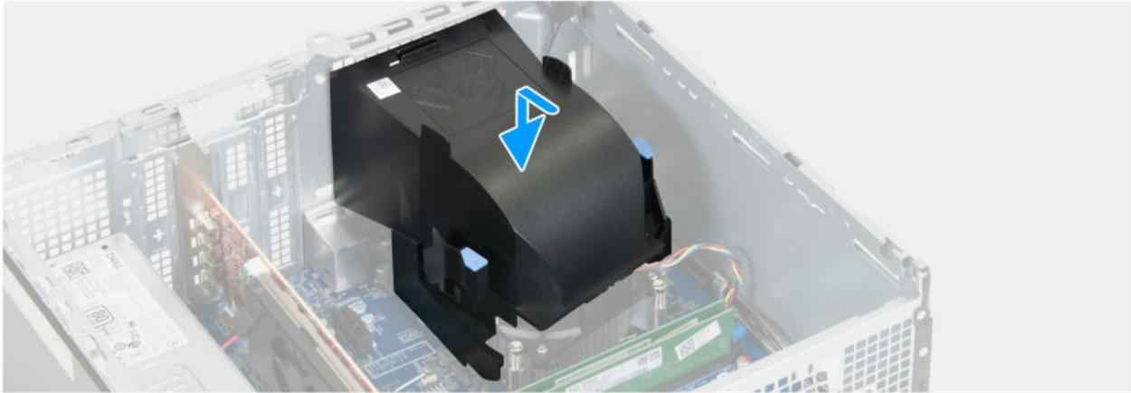
Abbildung 52. Abbildung: Einbauen der Lüfterverkleidung
