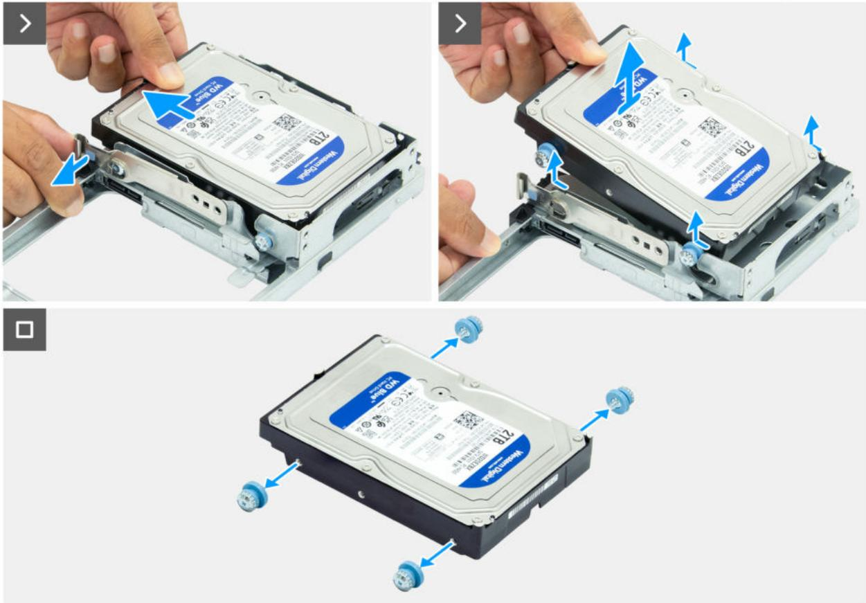
Abbildung 45. Entfernen der Festplatte
