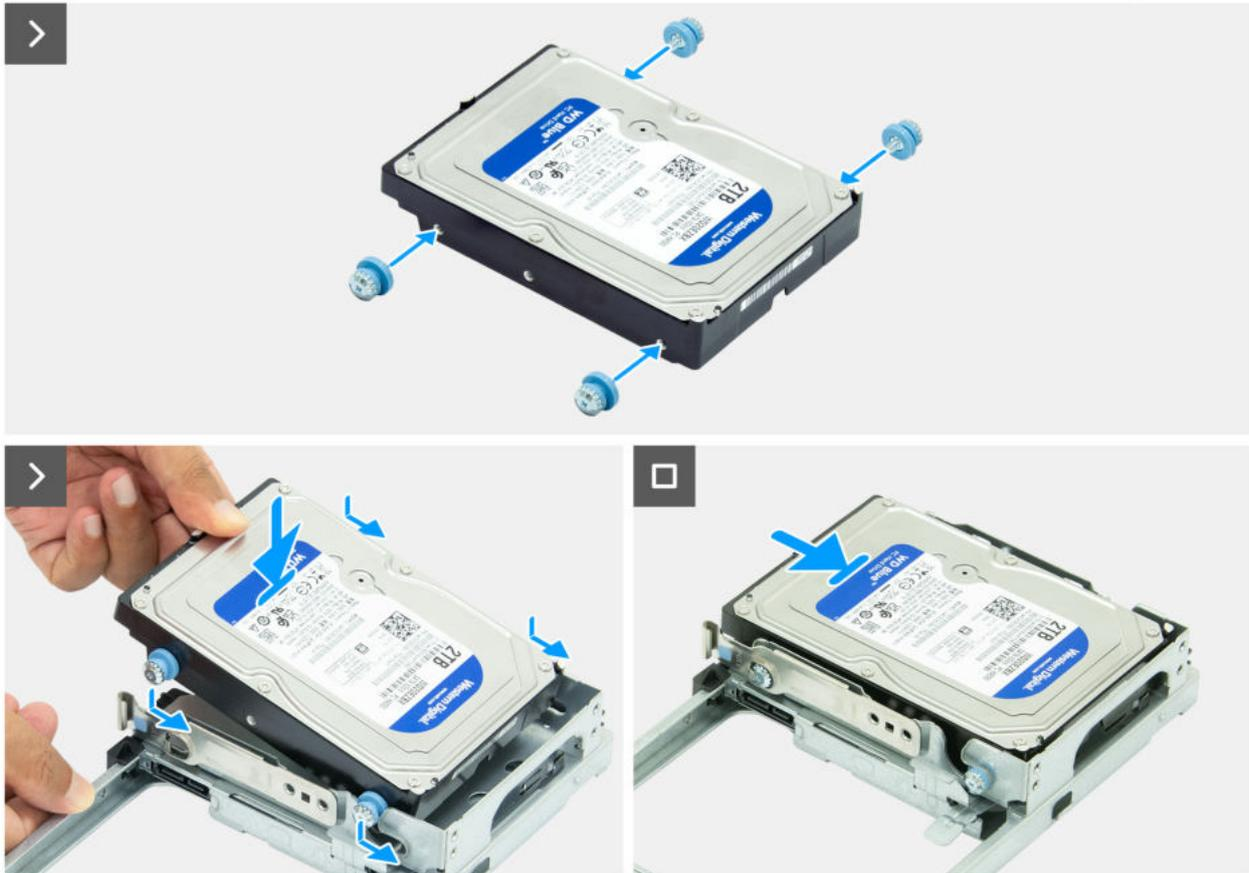
Abbildung 46. Einsetzen des Festplattenlaufwerks
