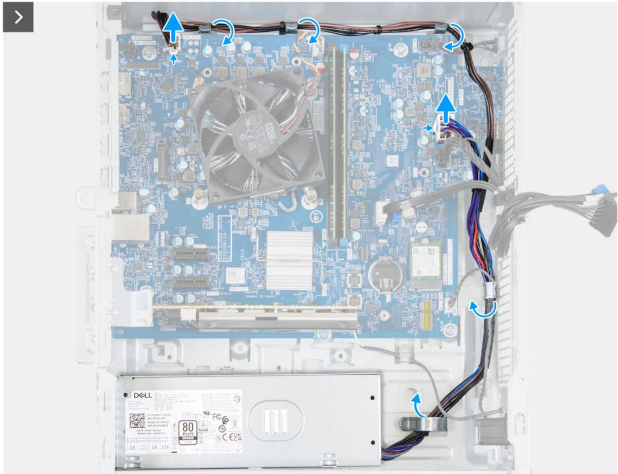
Abbildung 61. Entfernen der Stromversorgungseinheit
