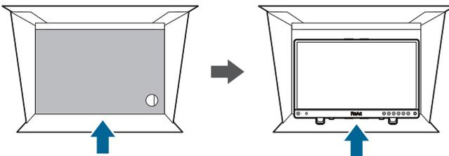
Für die Montage positionieren Sie die Haube zwischen der Halterung und dem Monitor und befestigen dann den Monitor am Montageset.
