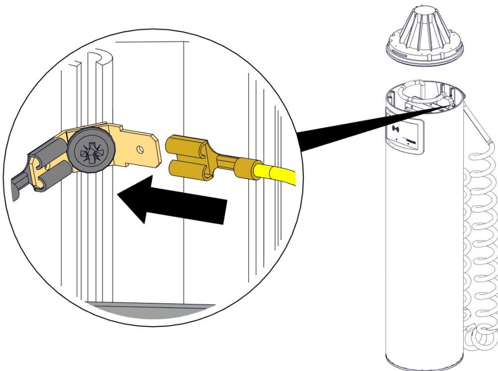
Abbildung 18. Erdung der Leuchtaufnahme
