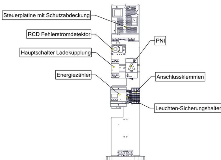
Abbildung 1. Vorderseite des Geräteträgerblech
