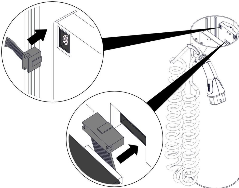
Abbildung 14. Anschluss RFID-Modul
