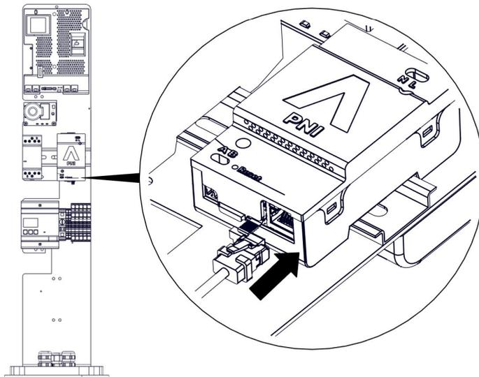
Abbildung 8. Anschluss des Netzwerkkabels
