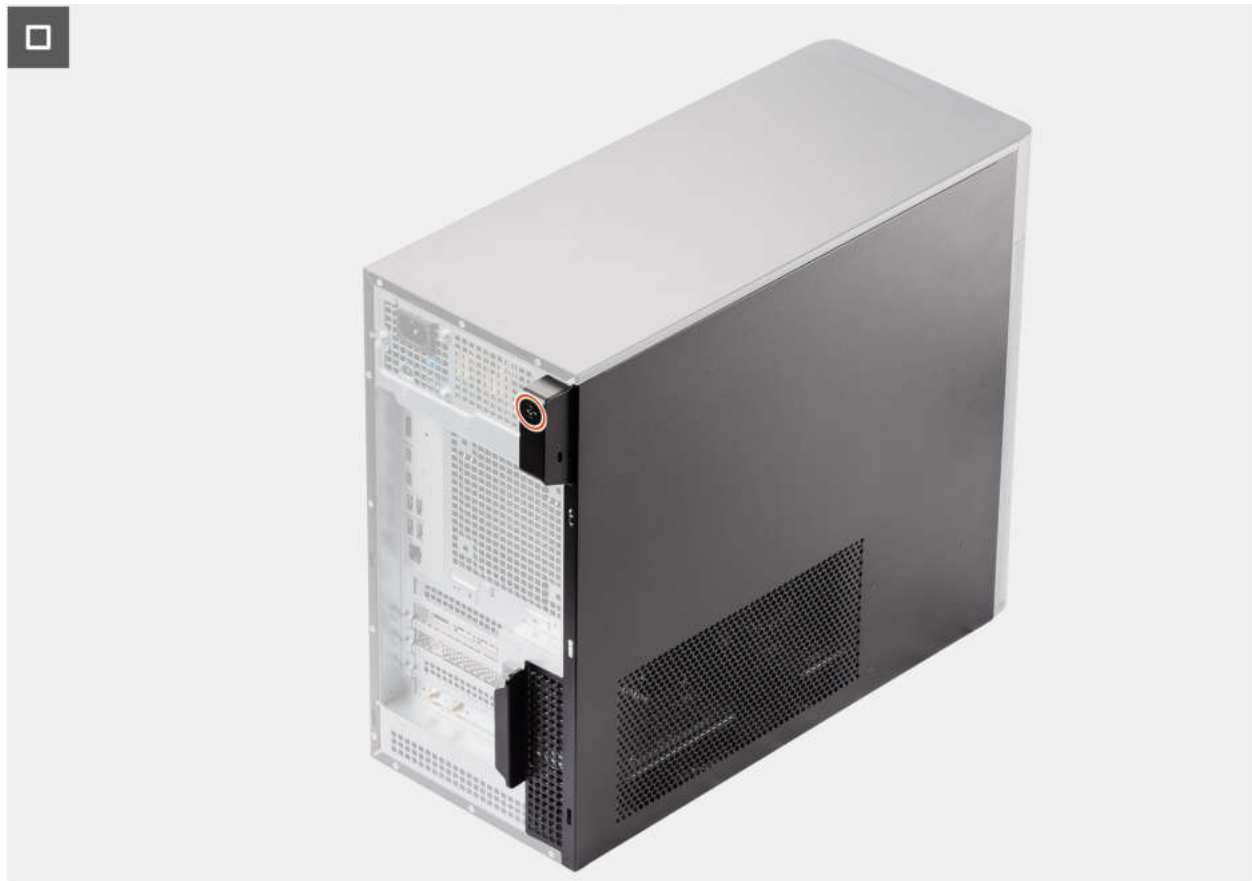
Abbildung 12. Anbringen der Seitenabdeckung
