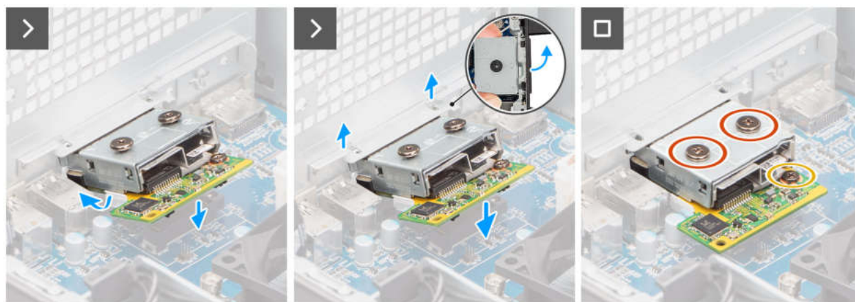
Abbildung 75. Installieren des optionalen optischen 5-GbE-Moduls
