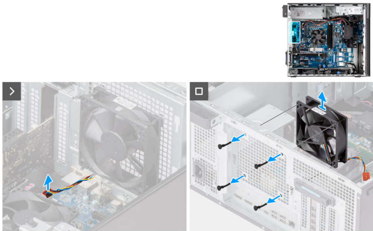
Abbildung 49. Entfernen des hinteren Lüfters bei Systemen mit 360-W-Netzteilen
