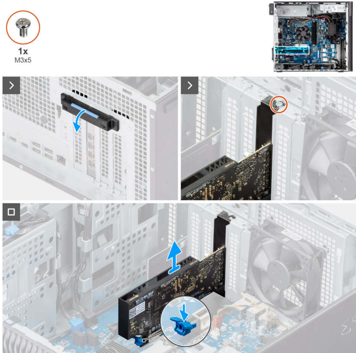
Abbildung 37. Entfernen der Grafikkarte
