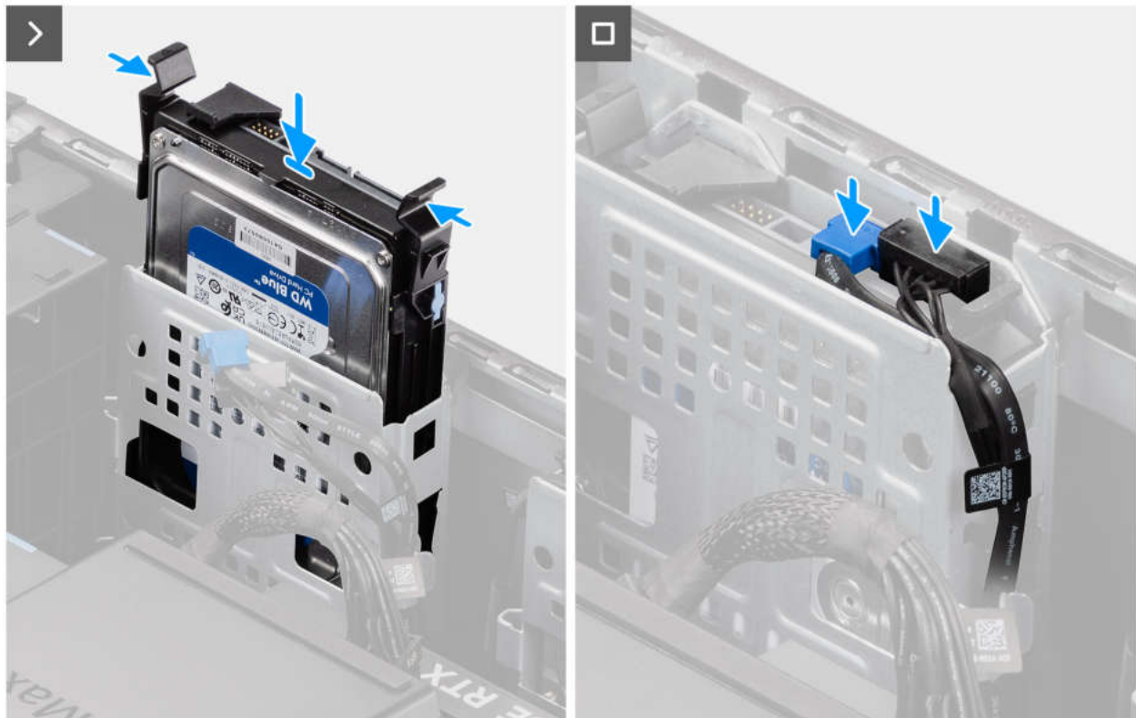
Abbildung 30. Installieren der 3,5-Zoll-Festplattenbaugruppe in Schacht 1
