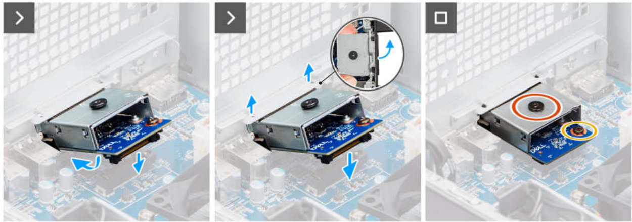
Abbildung 87. Installieren des optionalen VGA-Moduls
