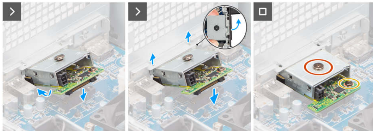
Abbildung 84. Installieren des optionalen USB-Moduls
