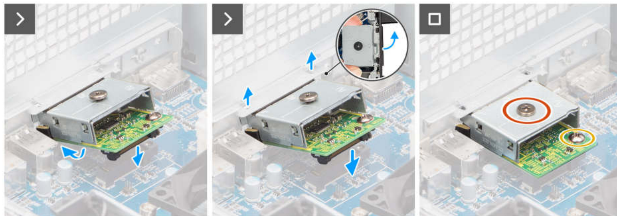
Abbildung 69. Installieren des optionalen DisplayPort-Moduls
