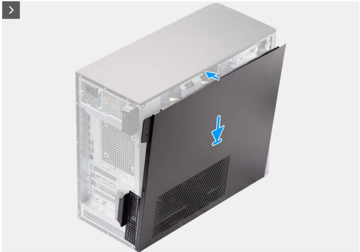
Abbildung 11. Anbringen der Seitenabdeckung
