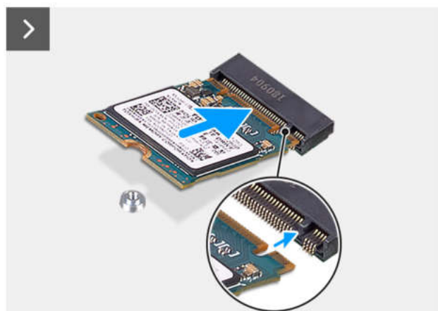
Abbildung 32. Einbauen des M.2 2230-PCIe-SSD-Laufwerks
