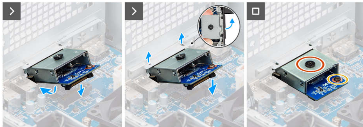
Abbildung 72. Installieren des optionalen HDMI-Moduls
