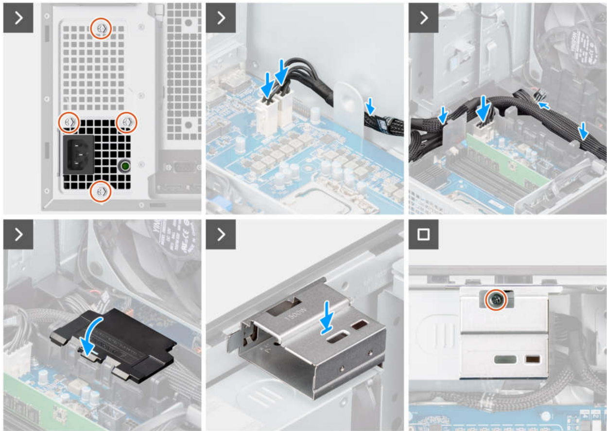
Abbildung 56. Installieren der 1500-W-Stromversorgungseinheit
