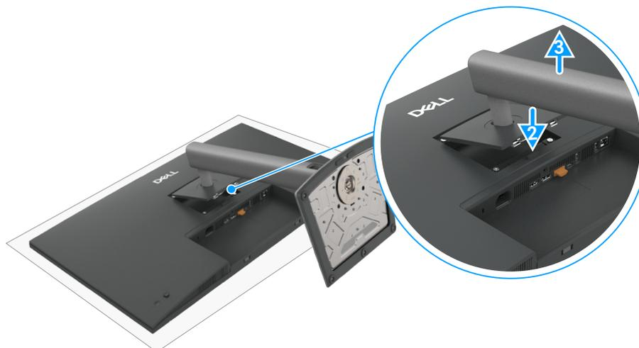
**Abbildung 55. Monitorständer entfernen**
