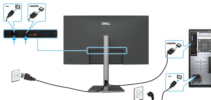
Abbildung 28. HDMI-Kabel anschließen
