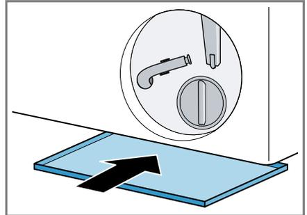
6. Den Entleerungsschlauch aus der Halterung nehmen.
