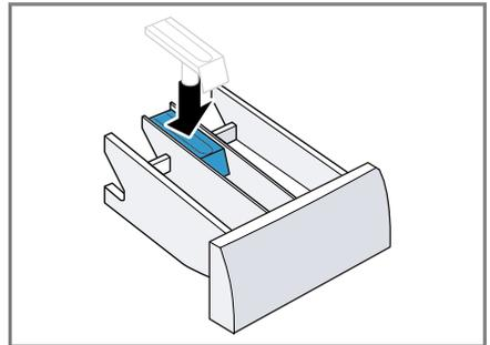
6. Die Öffnung für die Waschmittelschublade reinigen.
