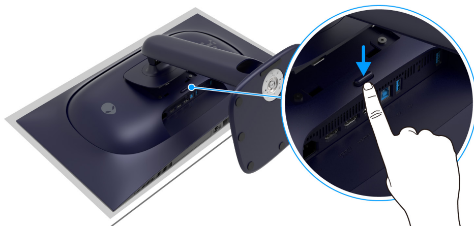
Figuur 30. Houd de ontgrendelingsknop van de standaard ingedrukt
