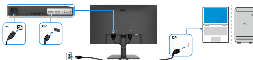
Abbildung 16. Anschließen des DP-Kabels
