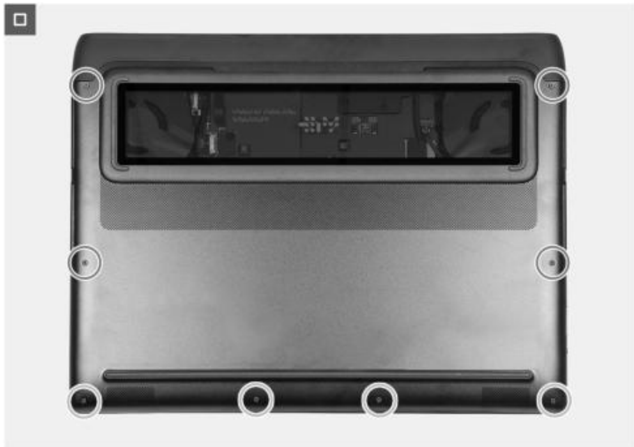
Abbildung 16. Die Schrauben der Bodenabdeckung wieder anbringen
