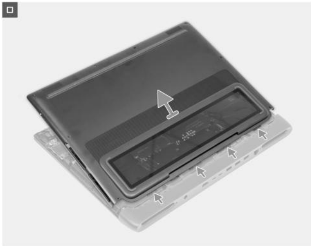
Abbildung 11. Anheben der Bodenabdeckung
