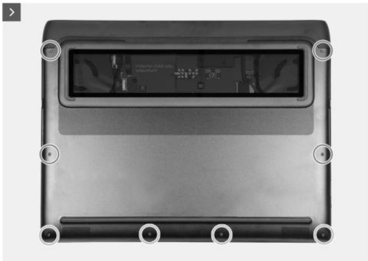
Abbildung 9. Entfernen der Schraube für die Bodenabdeckung
