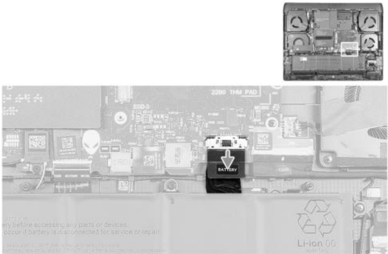
Abbildung 12. Trennen des Akkukabels
