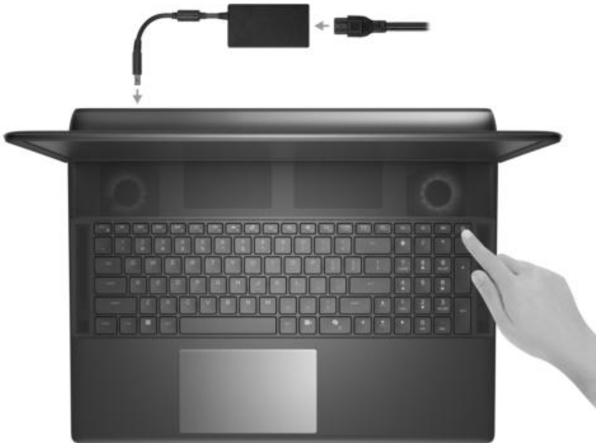
Abbildung 6. Anschließen des Netzteils und Drücken des Netzschalters
