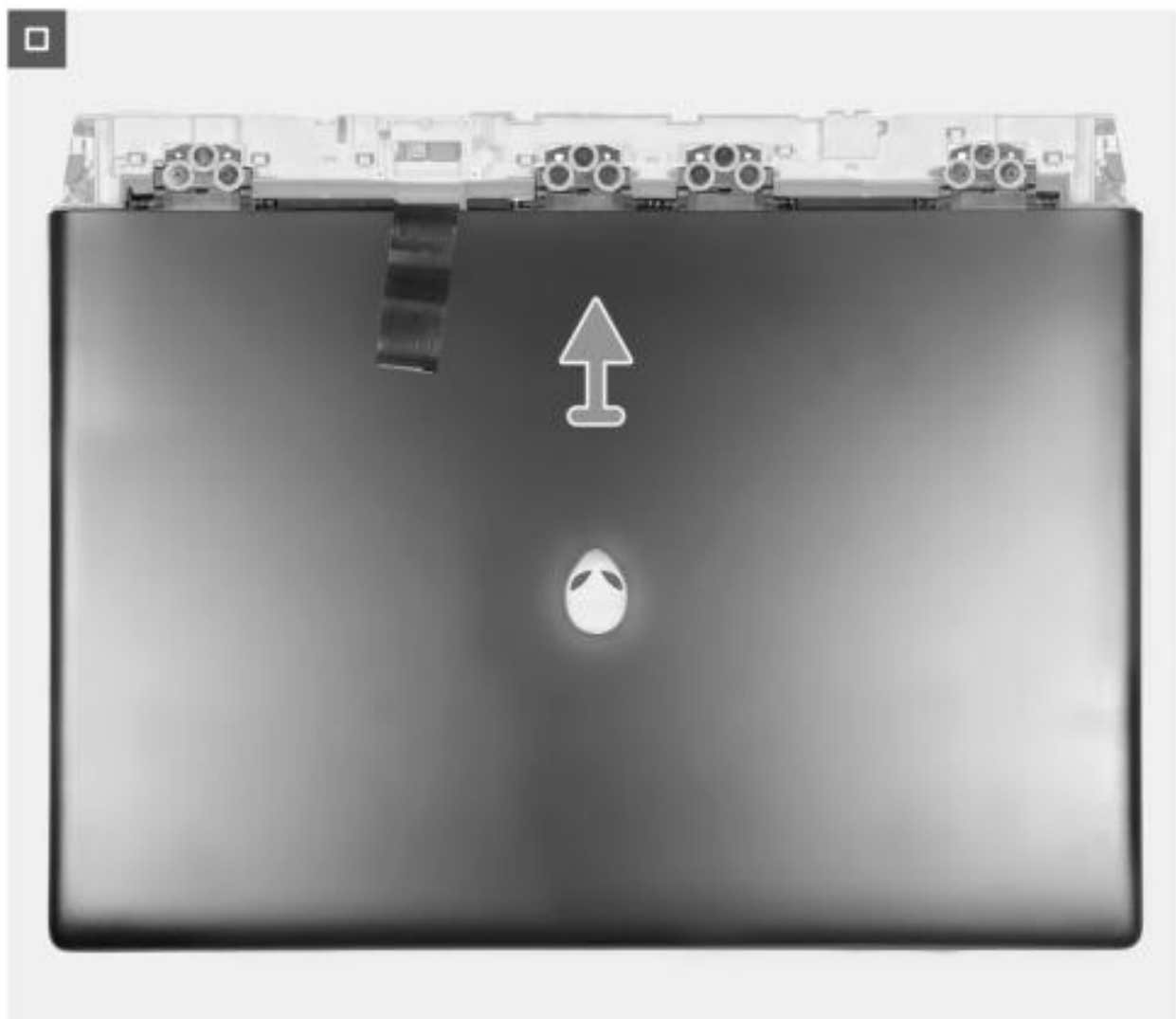
Abbildung 53. Entfernen der Bildschirmbaugruppe
