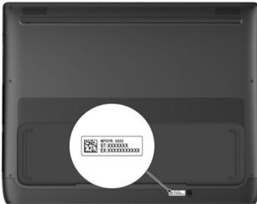
Abbildung 5. Position des Service-Tags/Express-Servicecodes
