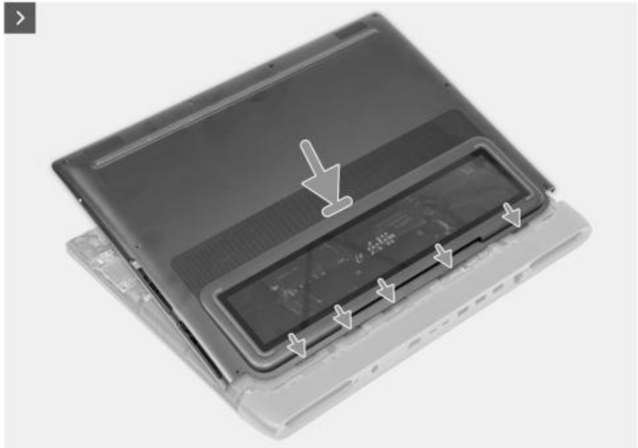
Abbildung 14. Schieben der Bodenabdeckung
