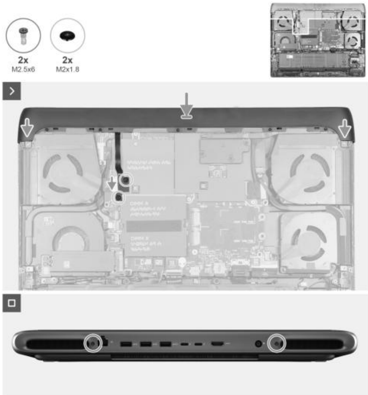
Abbildung 32. Installieren der hinteren E/A-Abdeckung
