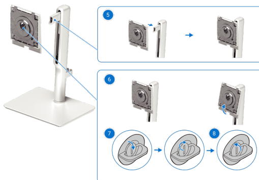
Abbildung 13. Installation der VESA-Abdeckung und der Ständererhöhung
