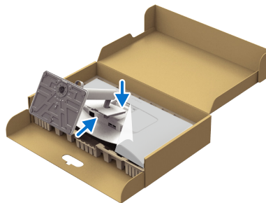
Abbildung 15. Ständereinheit am Display anbringen
