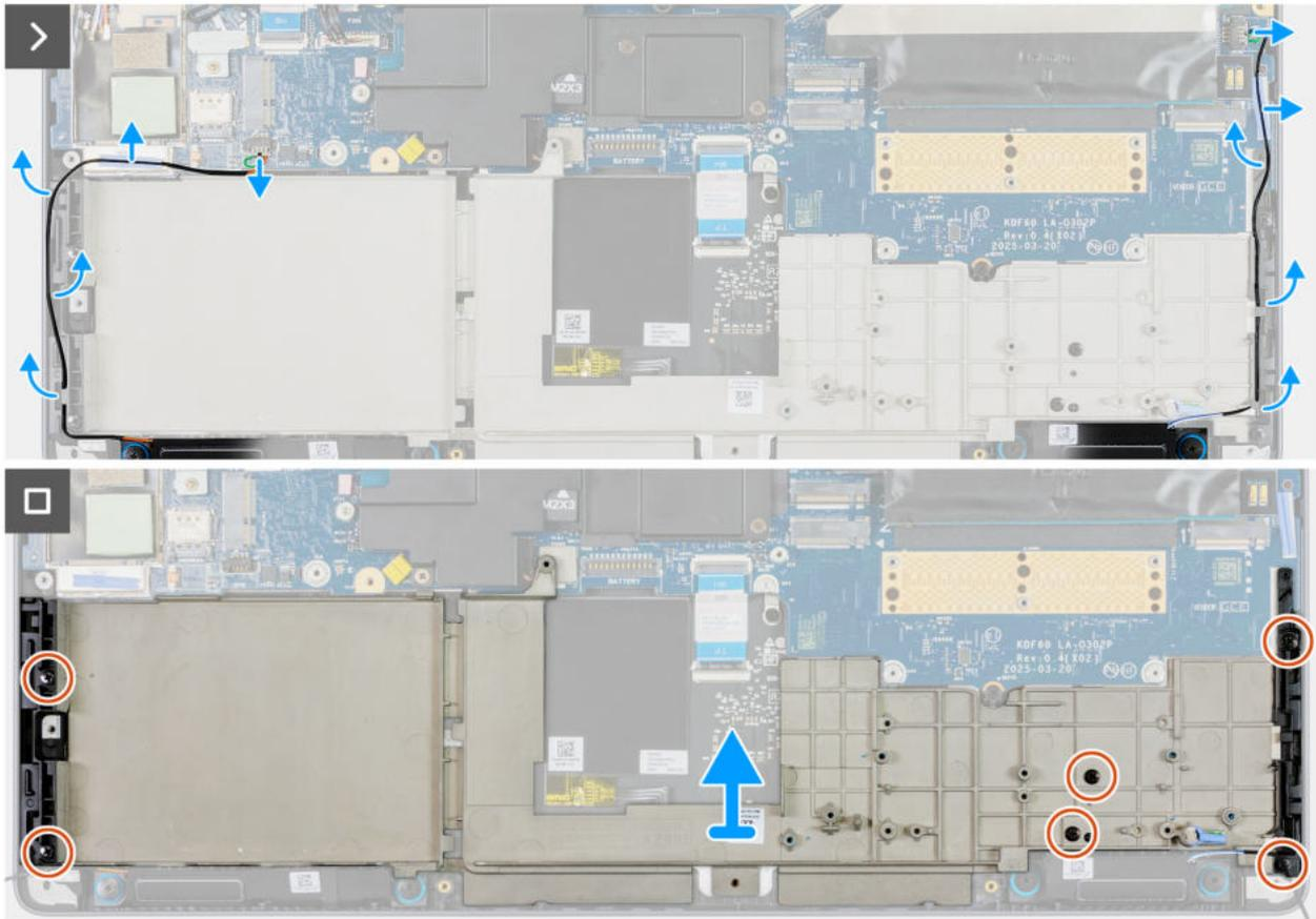
Abbildung 79. Entfernen des inneren Rahmens
