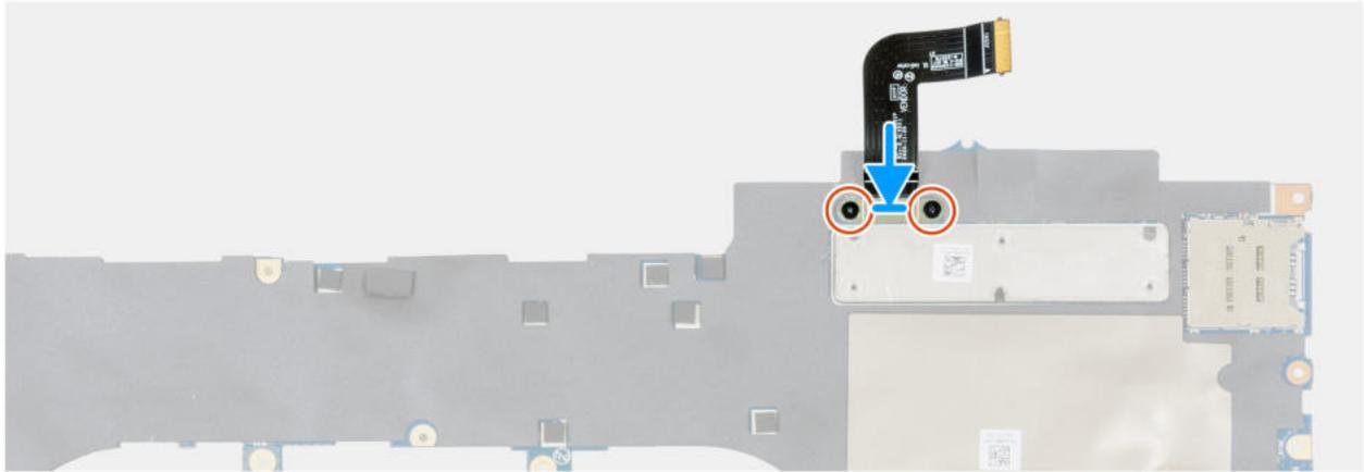
**Abbildung 120. Einbauen des USH-Platinenkabels**
