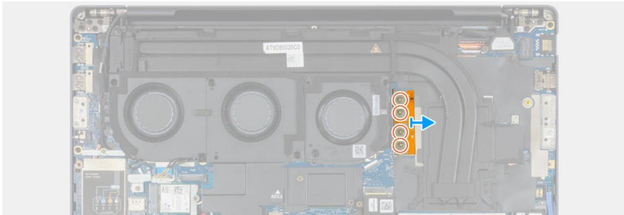
Abbildung 55. Entfernen des integrierten FPC-Trägerverbinders
