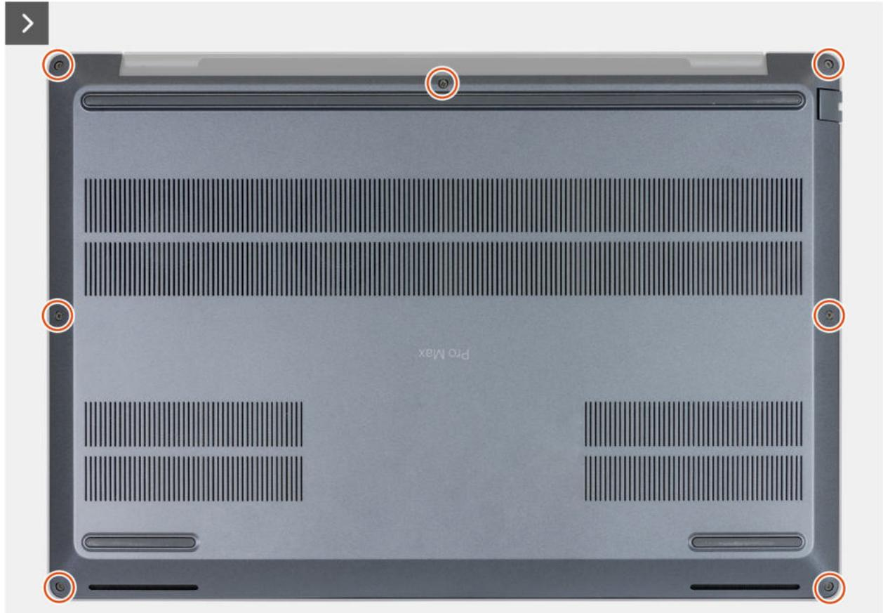
Abbildung 24. Lösen der unverlierbaren Schrauben
