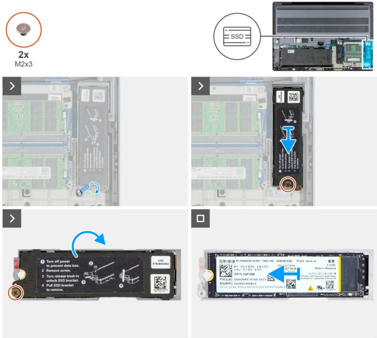
Abbildung 34. Entfernen der M.2-2280-SSD aus Steckplatz 1 (SSD1)
