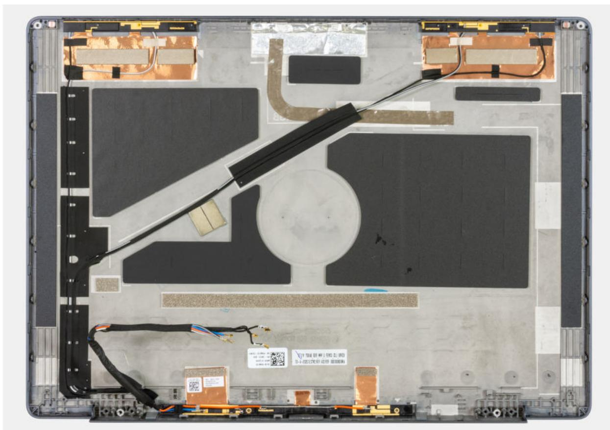
Abbildung 108. Hintere Bildschirmrückabdeckung
