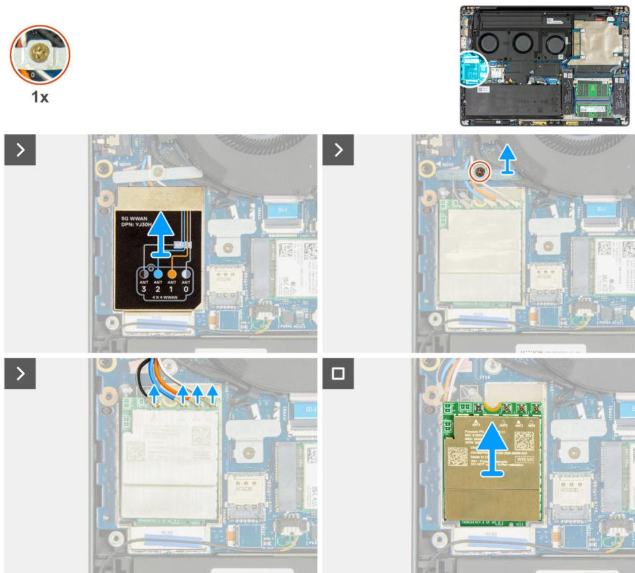
Abbildung 50. Entfernen der WWAN-Karte
