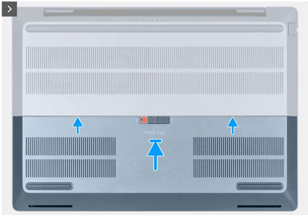
Abbildung 16. Schieben Sie die Schiebetür in Richtung Computer
