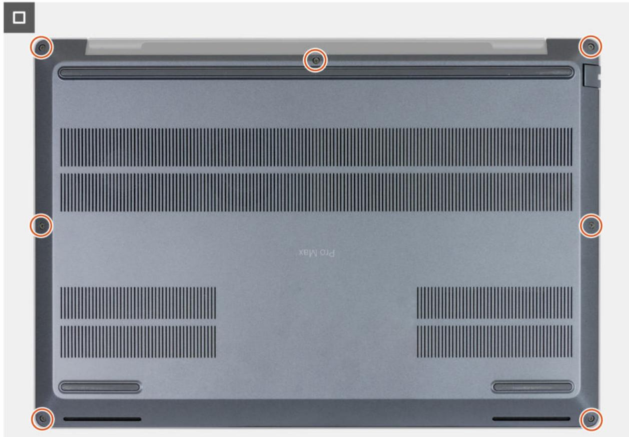
Abbildung 29. Festziehen der unverlierbaren Schrauben
