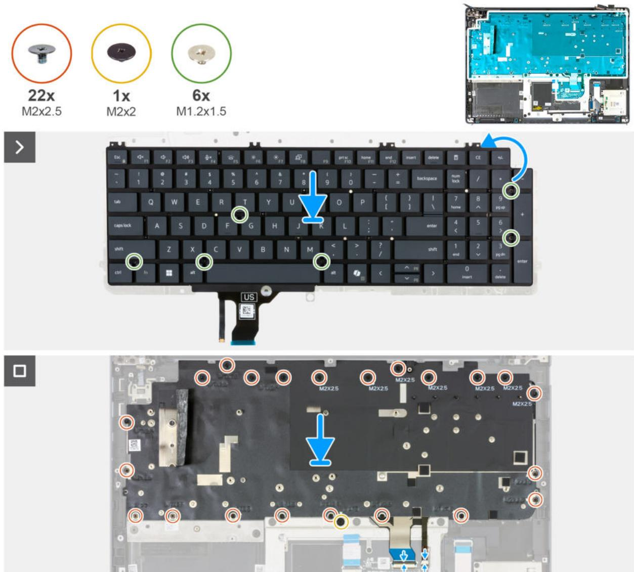
Abbildung 122. Einbauen der Tastatur
