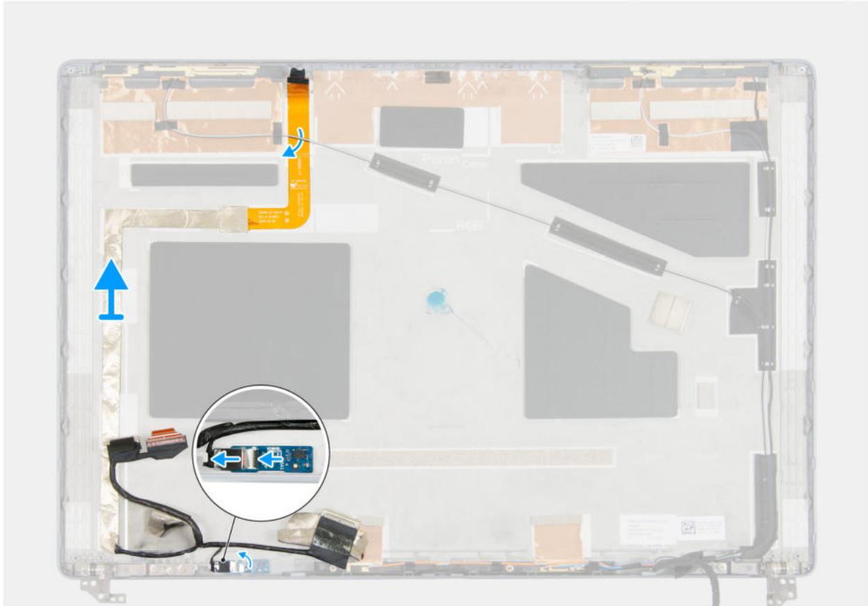
Abbildung 106. Entfernen des Bildschirmkabels
