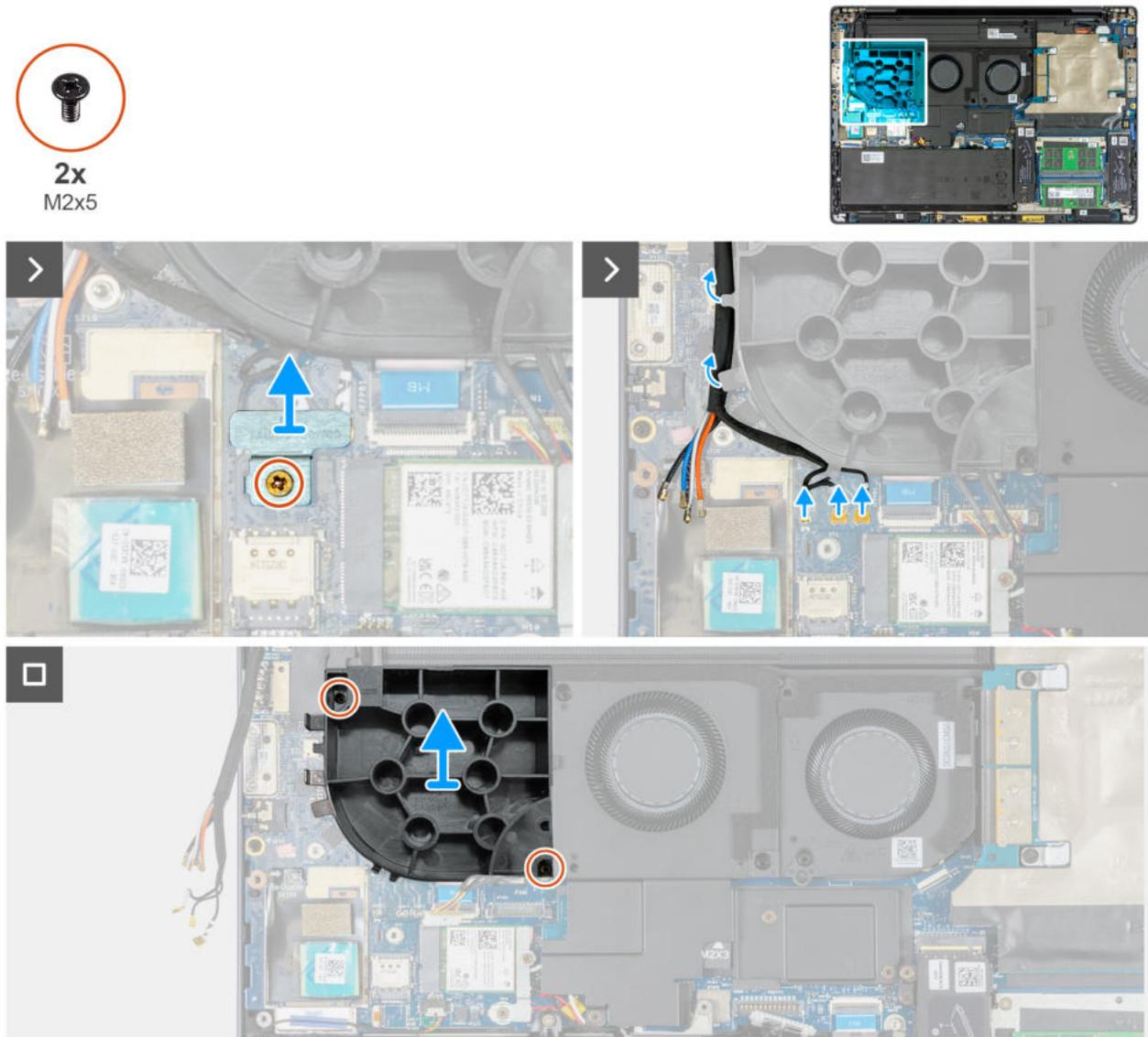
Abbildung 59. Entfernen des Dummy-Lüfters
