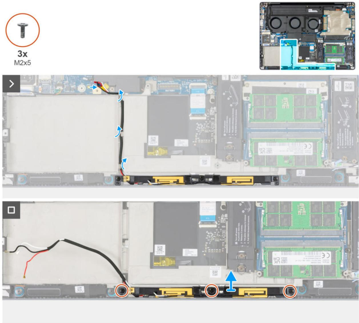
**Abbildung 77. Entfernen des WLAN-Antennenmoduls**
