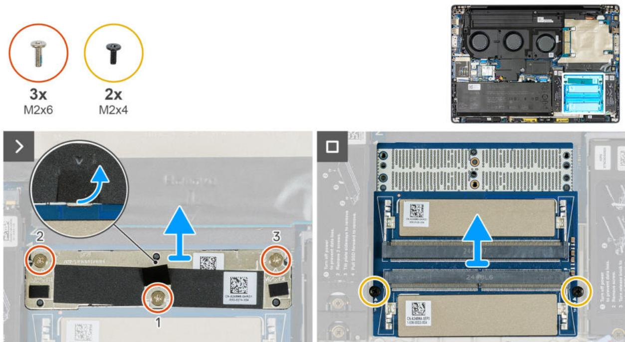
Abbildung 67. Entfernen der Arbeitsspeicher-Zwischenplatte
