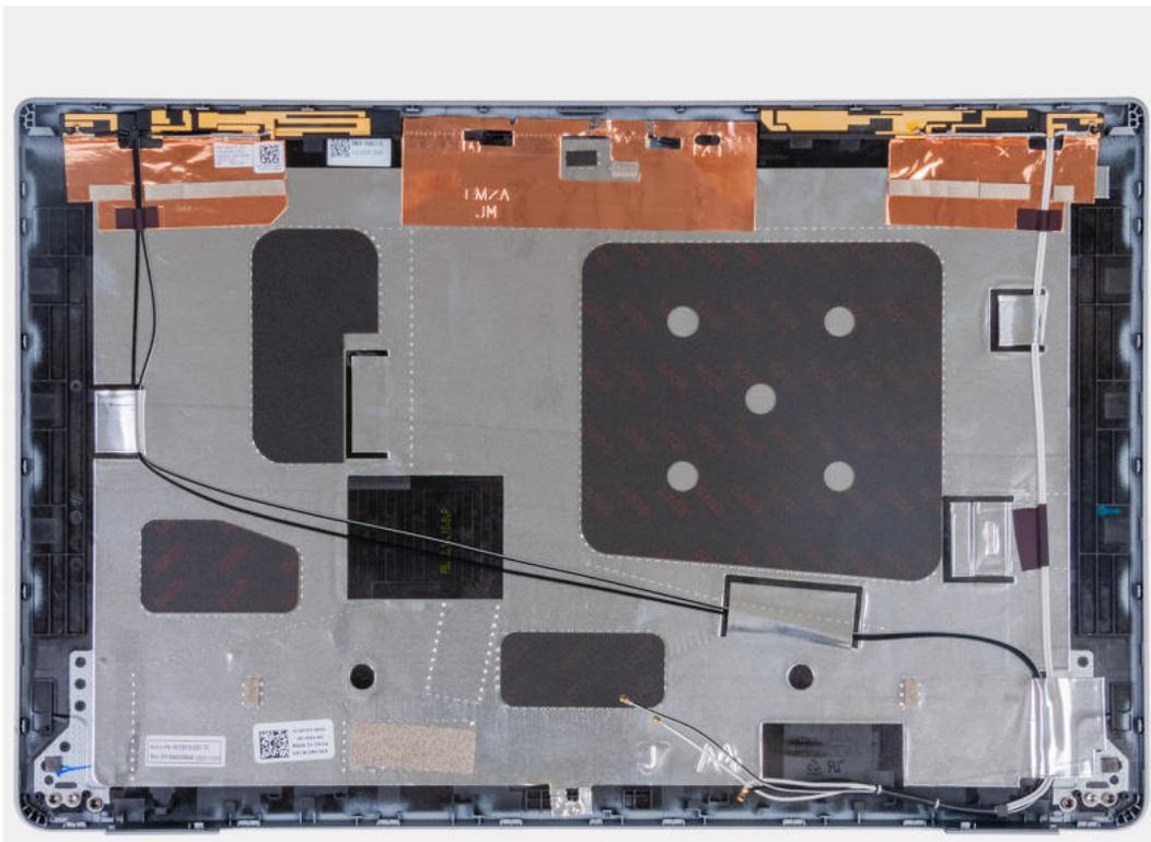
Abbildung 109. Hintere Bildschirmrückabdeckung
