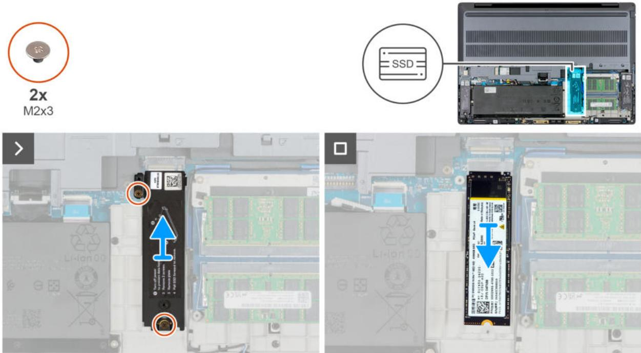
Abbildung 38. Entfernen der M.2-2280-SSD aus Steckplatz 2 (SSD2)
