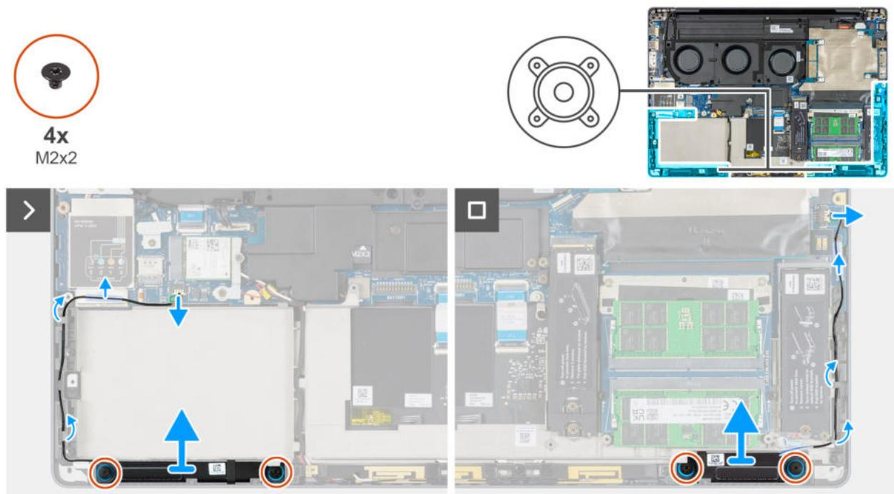
Abbildung 81. Entfernen der Lautsprecher
