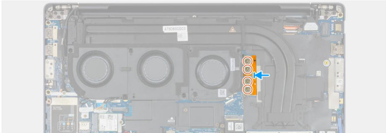
Abbildung 56. Installieren des integrierten FPC-Trägerverbinders
