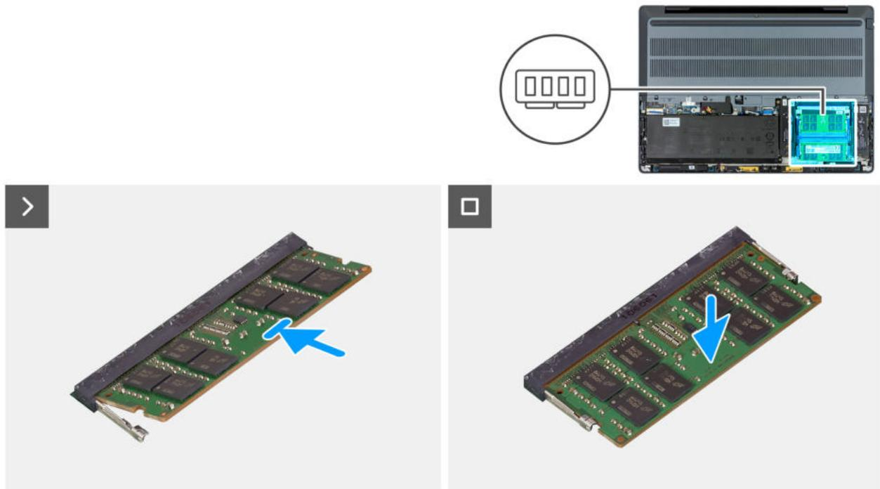
Abbildung 31. Einsetzen des Speichermoduls
