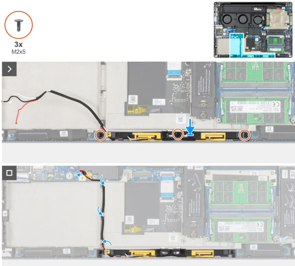
Abbildung 78. Einbauen des WLAN-Antennenmoduls
