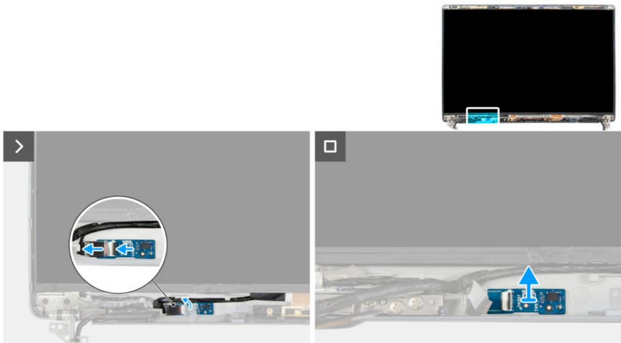
Abbildung 101. Entfernen der Sensorplatine
