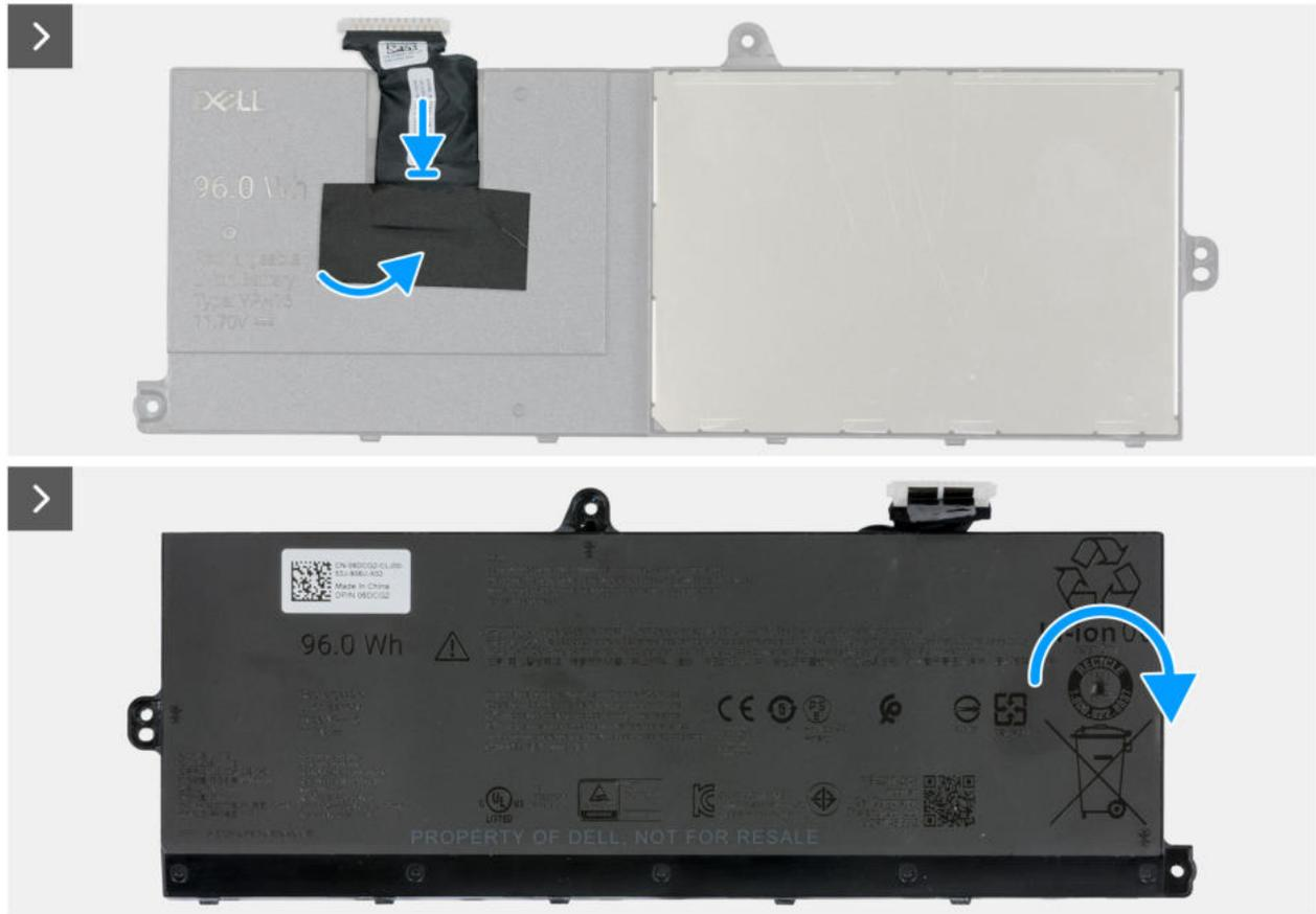
Abbildung 44. Austauschen des Akkukabels
