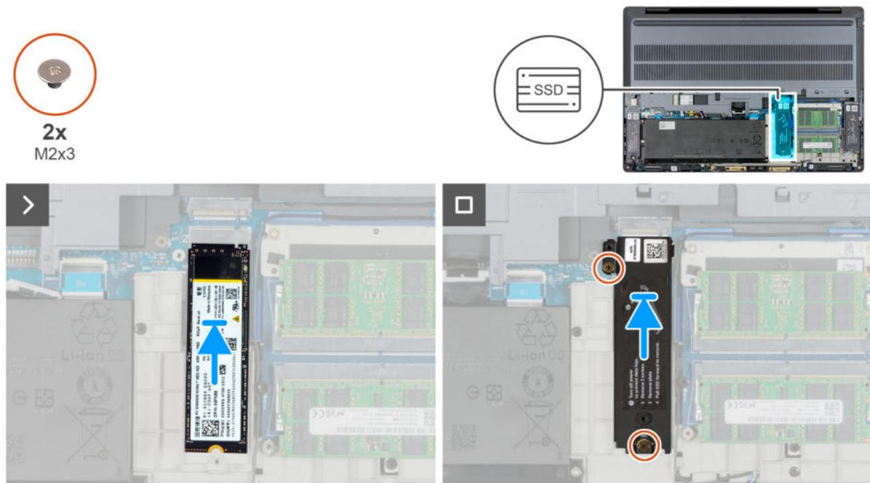
Abbildung 39. Installieren der M.2-2280-SSD in Steckplatz 2 (SSD2)
