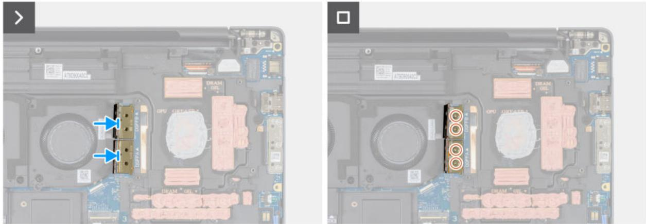
Abbildung 58. Installieren des separaten FPC-Trägerverbinders
