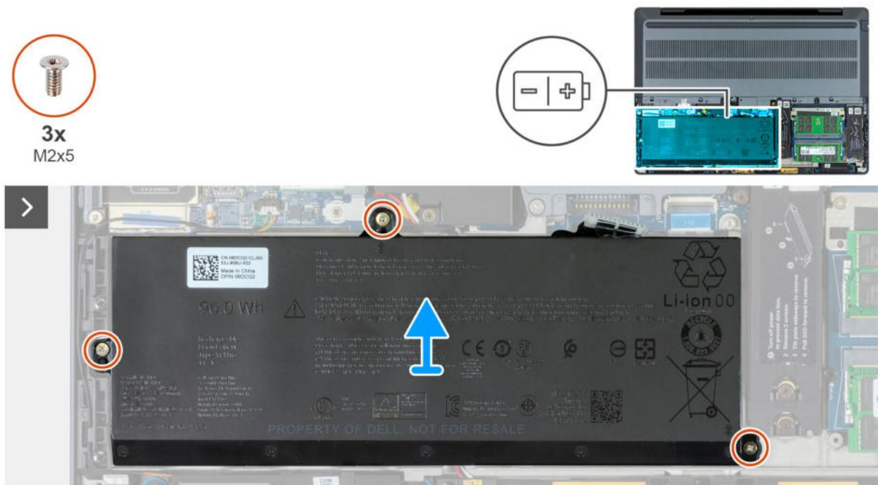
Abbildung 42. Entfernen des Akkus
