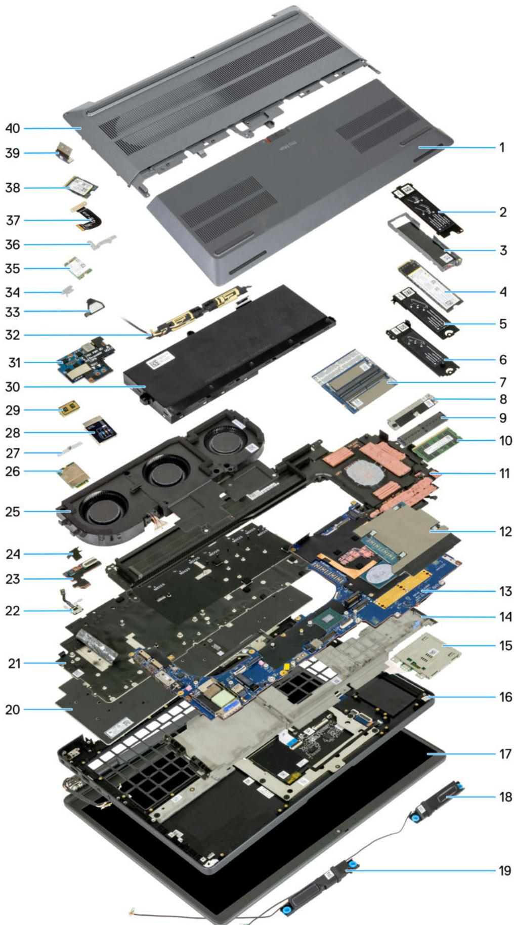
Abbildung 9. Hauptkomponenten von Dell Pro Max 16 Plus MB16250
