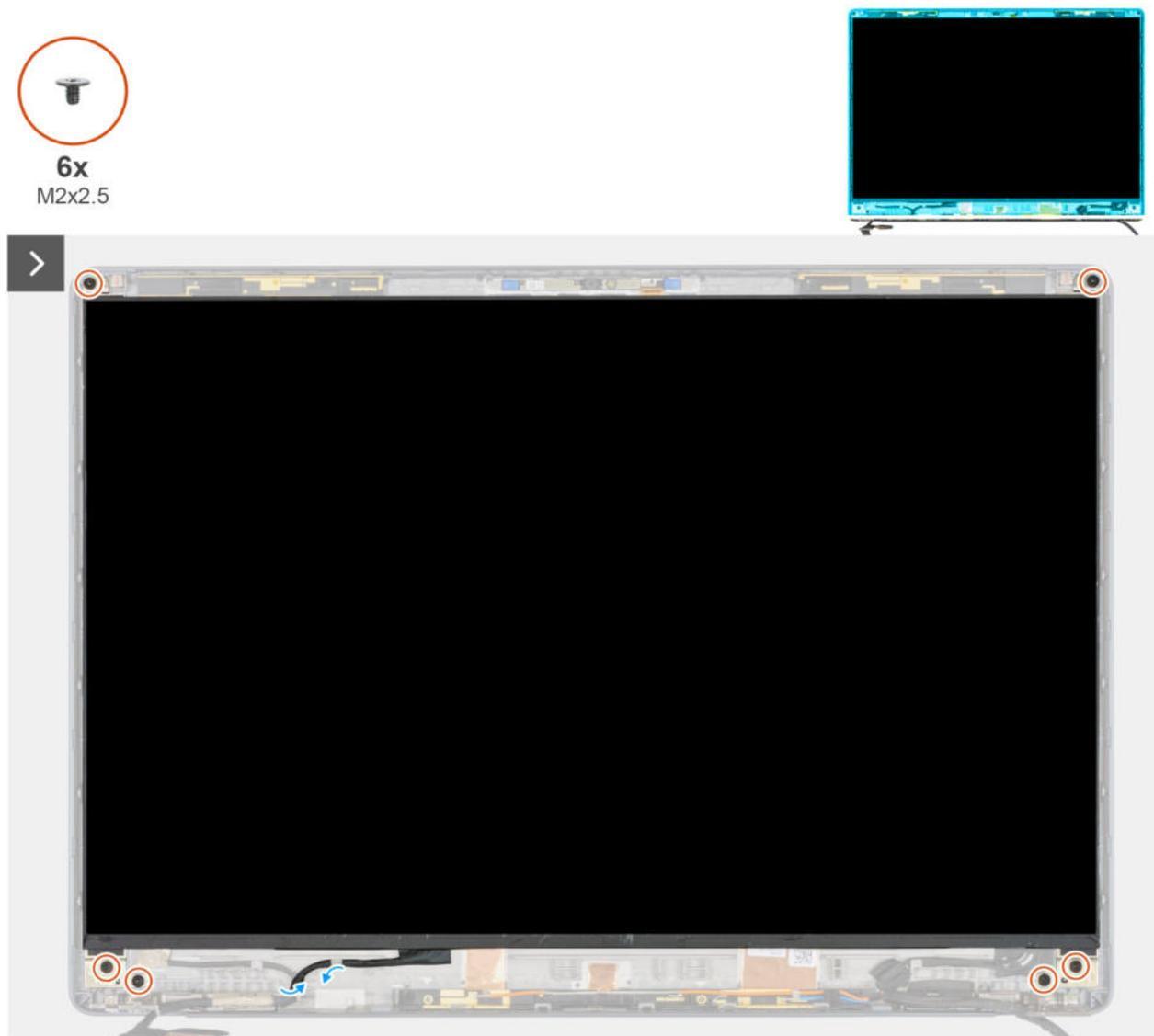
Abbildung 91. Entfernen des Bildschirms für Touchscreen-Displays
