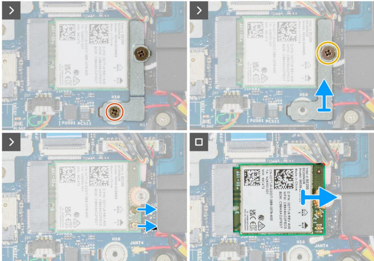
Abbildung 46. Entfernen der WLAN-Karte
