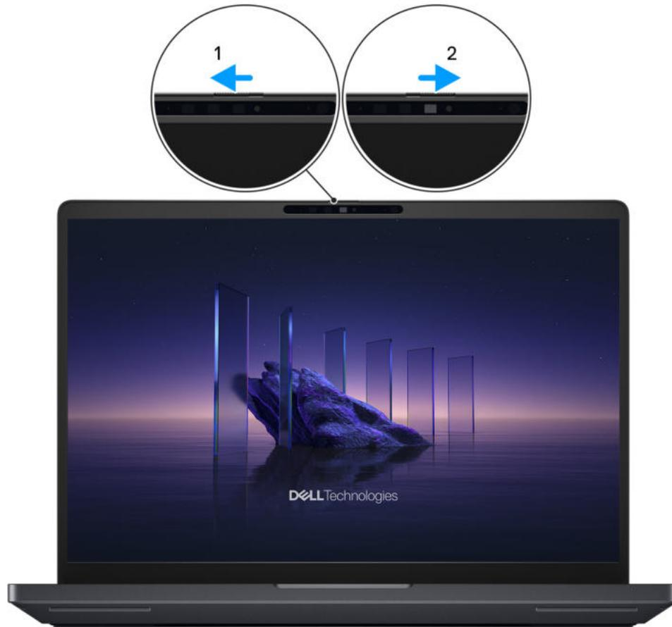
Abbildung 8. Kameraverschluss
