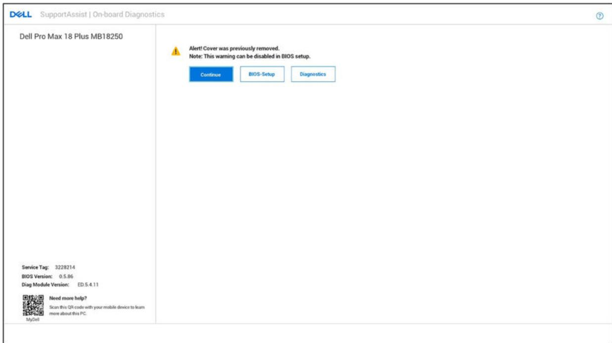
Abbildung 135. Gehäuseeingriffswarnung mit "Starten blockieren bis gelöscht" auf AUS gesetzt
