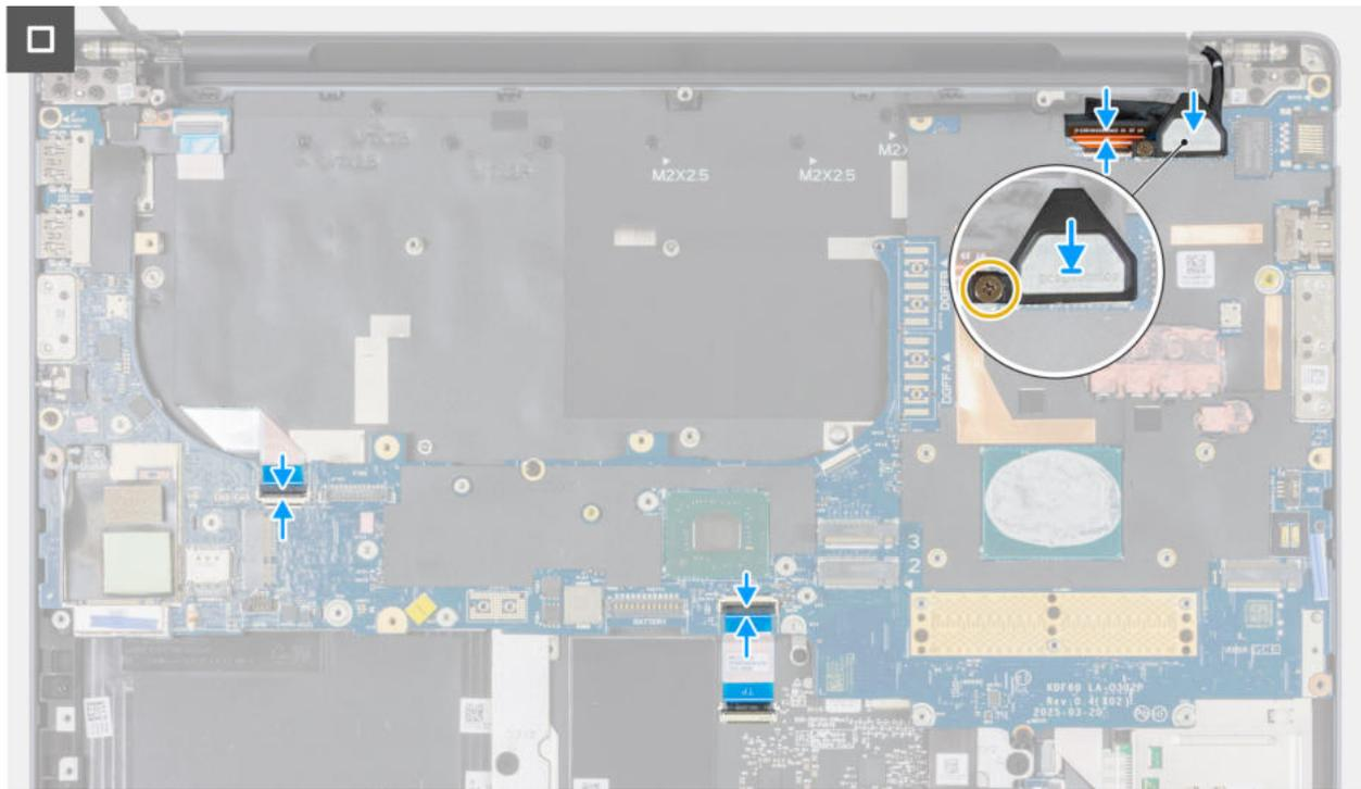
**Abbildung 116. Einbauen der Systemplatine**
