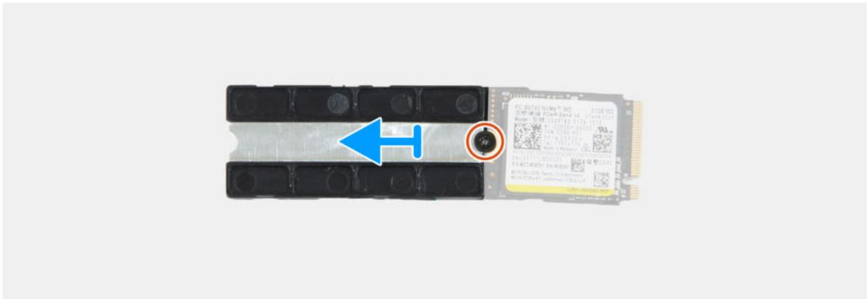
Abbildung 40. Entfernen des M.2-2230-Solid-State-Laufwerks
