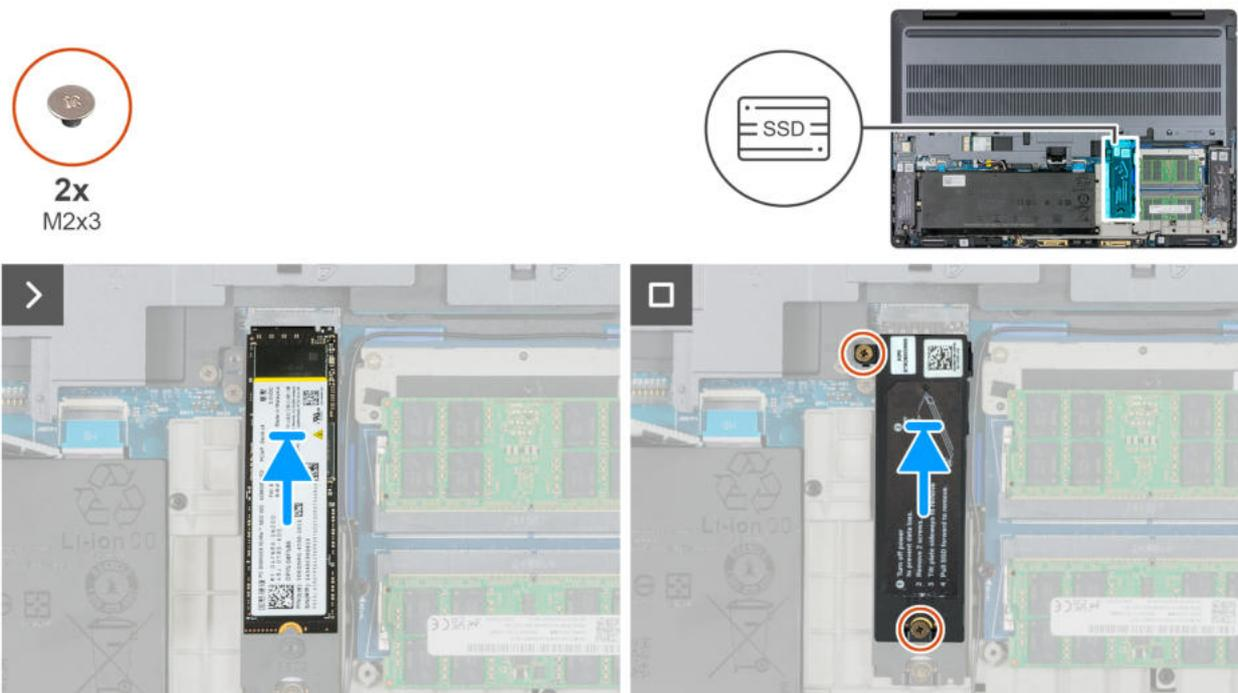
Abbildung 37. Installieren der M.2-2280-SSD in Steckplatz 3 (SSD3)
