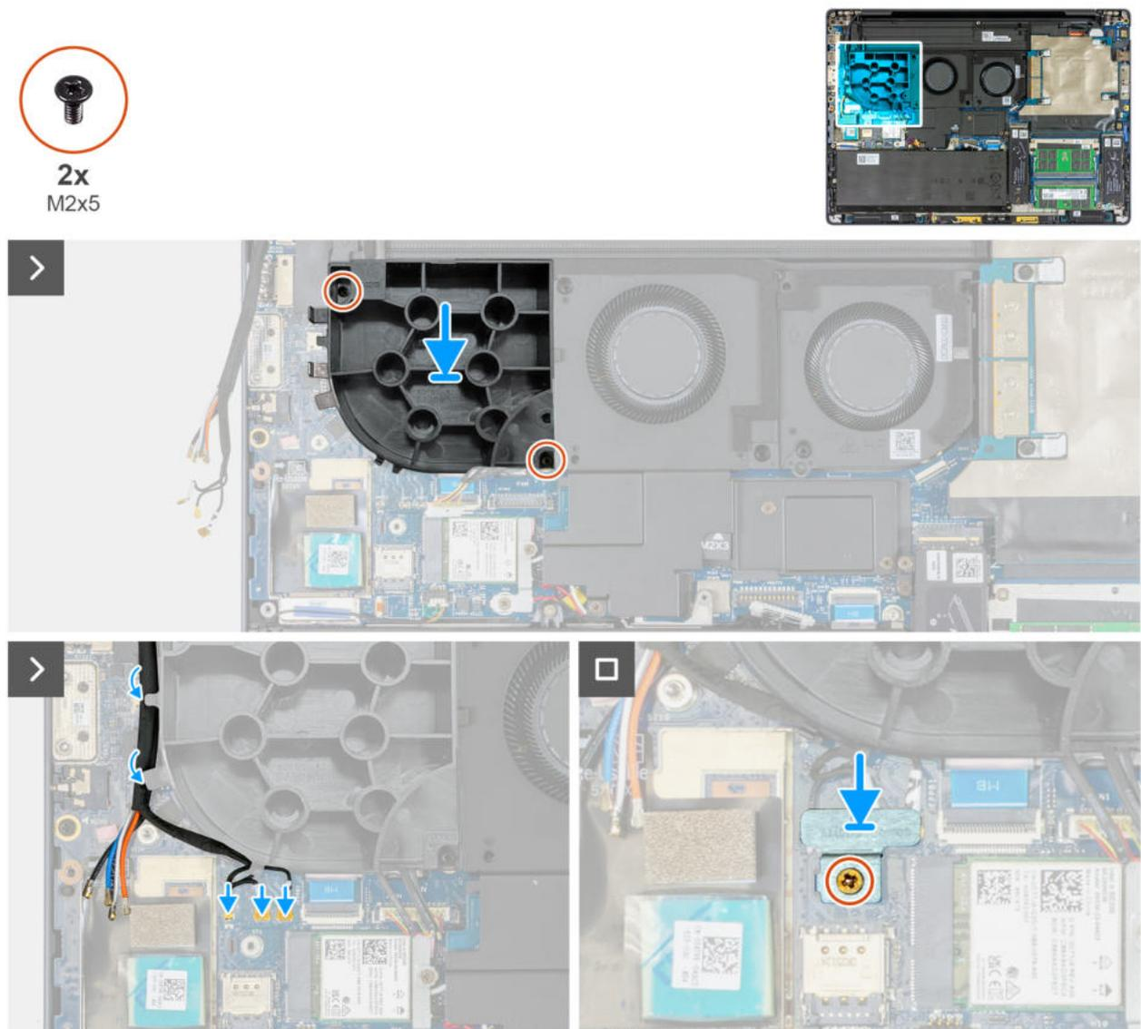
Abbildung 60. Einbauen des Dummy-Lüfters
