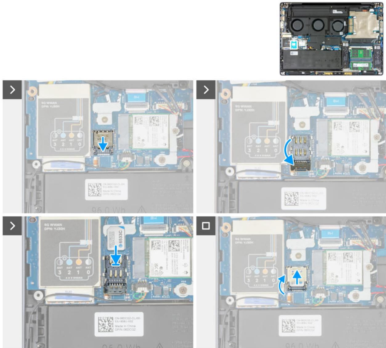
Abbildung 49. Einbauen der SIM-Karte
