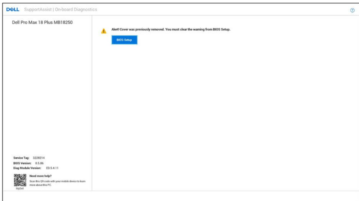
Abbildung 134. Gehäuseeingriffswarnung mit aktivierter Option "Starten blockieren bis gelöscht"
