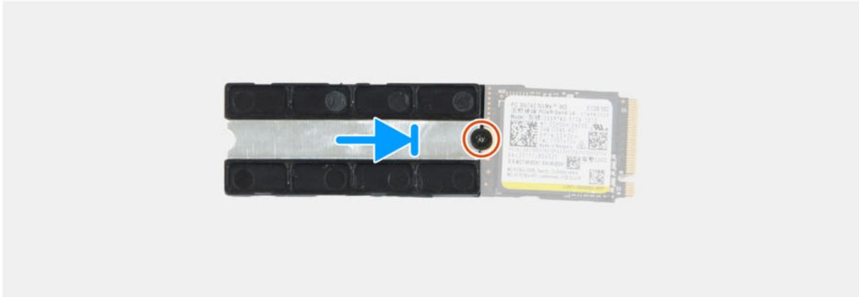
Abbildung 41. Einbauen des M.2-2280-SSD
