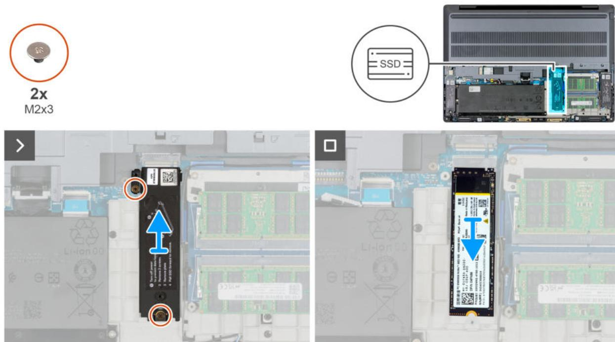
Abbildung 36. Entfernen der M.2-2280-SSD aus Steckplatz 3 (SSD3)
