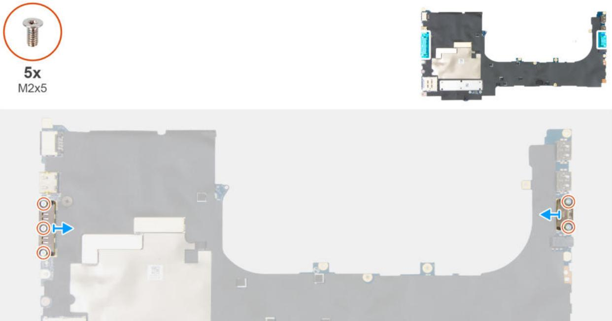
Abbildung 117. Entfernen des USB-Typ-C-Anschlussmoduls
