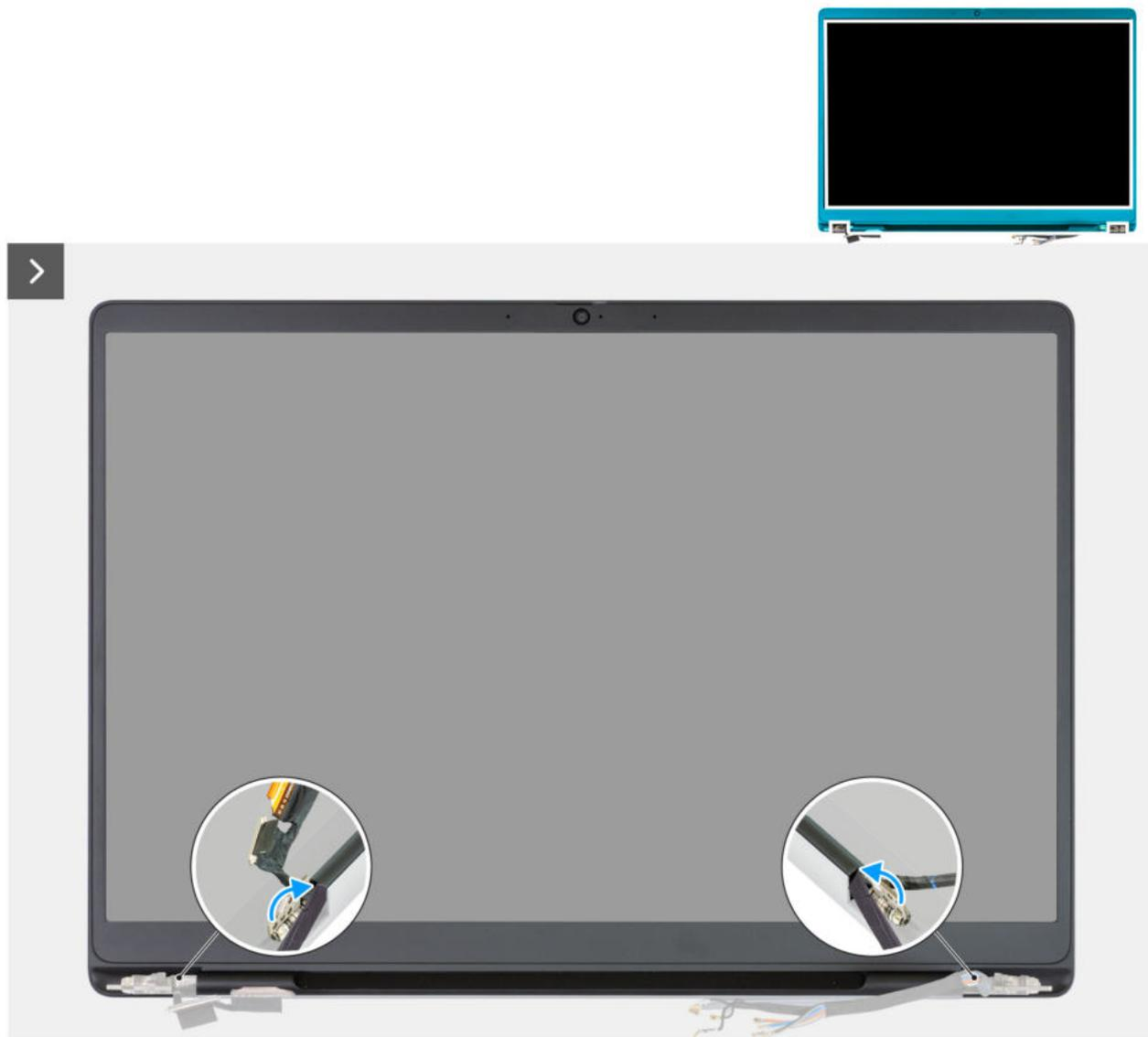
Abbildung 83. Entfernen der Bildschirmblende
