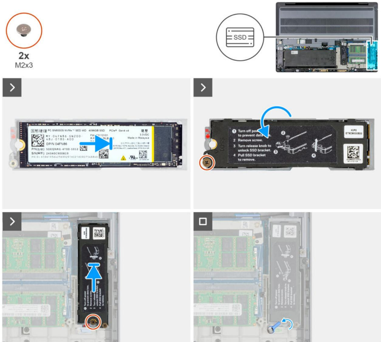
Abbildung 35. Installieren der M.2-2280-SSD in Steckplatz 1 (SSD1)
